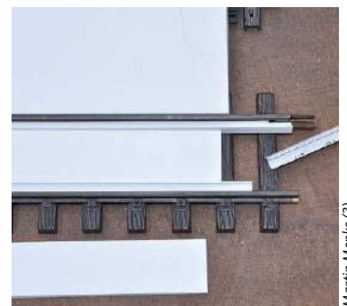
In die LGB-Weichen und -Gleise werden T-Profile und Füllstücke eingeklebt
