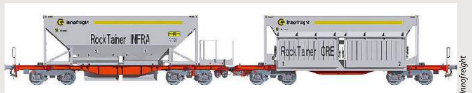
Darstellung der Aufbauvarianten des RockTainers in den Ausführungen Ore bzw. Infra
