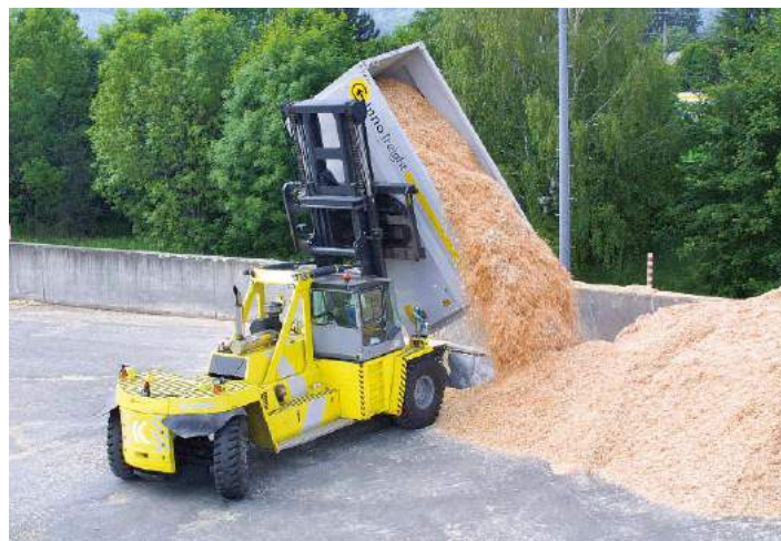
Der kräftige Drehentladestapler von Kalmar kann mit seinen Gabeln vollgeladene Innofreight-Container bis zu 42 Tonnen aufnehmen. Entladen werden sie kopfüber durch eine Drehkipplung
