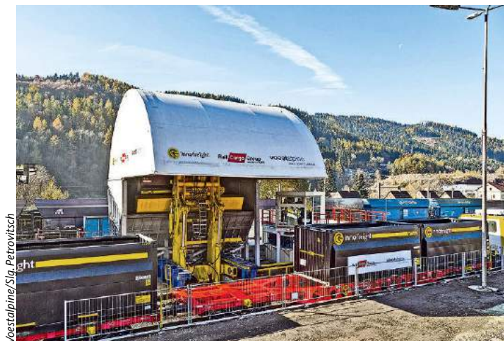
Die stationäre Entlade-Kippanlage für IF-Behälter mit Gabeltunneln im Stahlwerk Donawitz dient der durchrationalisierten Anlieferung von Kohle und Koks nur mit einmänniger Bedienung
