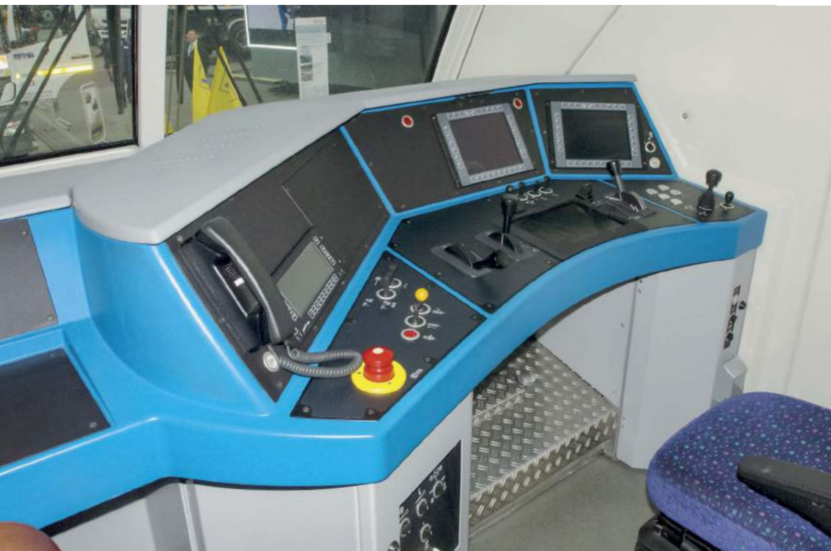
Der Arbeitsplatz des Lokomotivführers im Vectron DE
