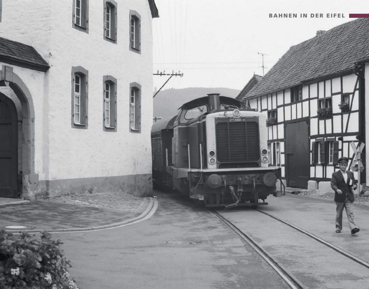
Die Strecke Kall – Hellenthal verläuft in Olef im Straßenplanum. Bei der Durchfahrt bedarf es der Sicherung durch den Zugführer – und das kostet Zeit (211 088 mit N 7804, 23. Juli 1979)
