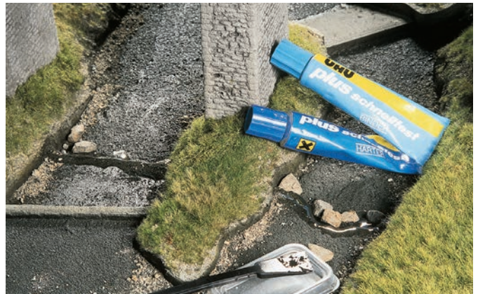
Mit klarem Zweikomponentenkleber werden Stufen und Wellen gestaltet.
