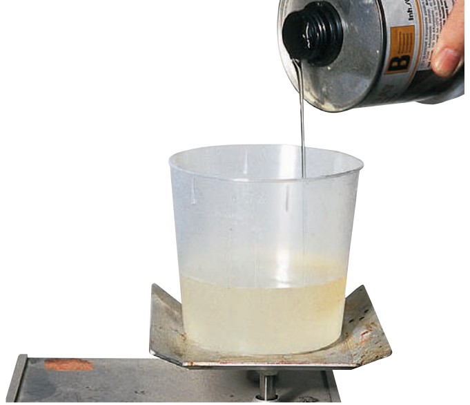
Bei der Verwendung von Gießharz ist exaktes Mischen Pflicht.
