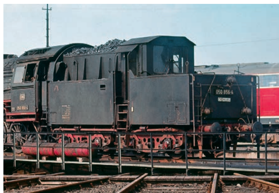
Kasten, Wanne und Kabine – die 50er hatte vielfältige Tender: 050 856 mit Kabinentender 2'2' T 26 Kab, den spaßeshalber auch noch ein Kfz-Kennzeichen ziert (Crailsheim, Mai 1972).
