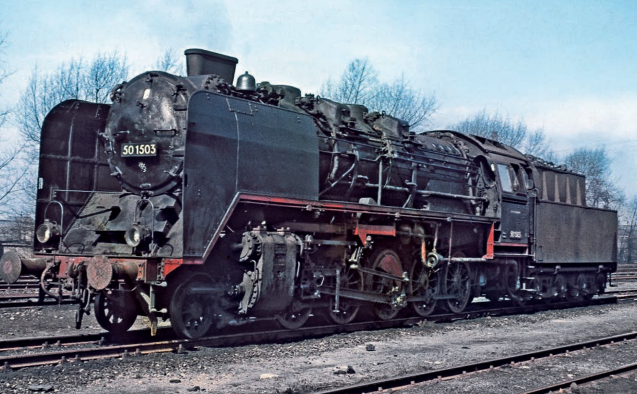
50 1503 erhielt 1955 einen Giesl-Flachschornstein, die DB war allerdings von Beginn an sehr desinteressiert.
