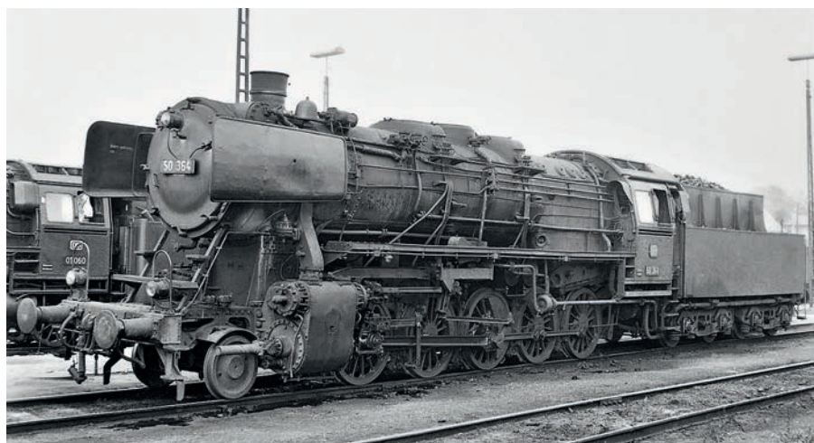
Auch 50 364 besaß eine Turbospeisepumpe, dazu einen dreidomigen Kessel und einen Scheiben-Laufradsatz (Bw Lübeck, 1962). FOTO: ULRICH MONTFORT
