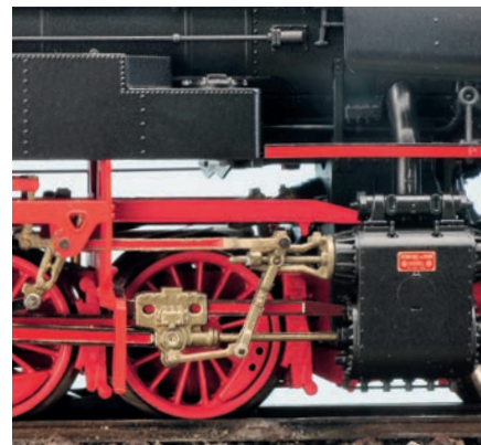
Radsätze und Steuerung des Modells wirken sehr vorbildnah. Nur Sandfallrohre fehlen.
