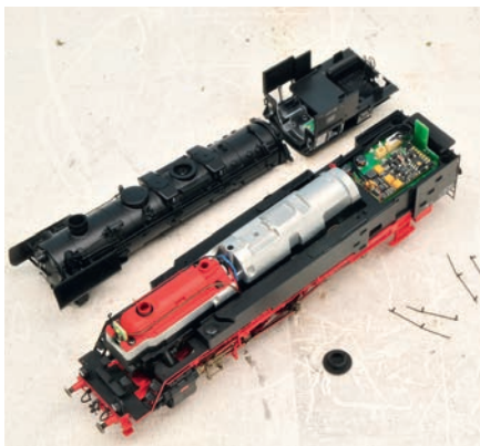
Voll: Zwischen Rauchgenerator und Decoder verdeckt Ballast den Blick auf den Motor.
