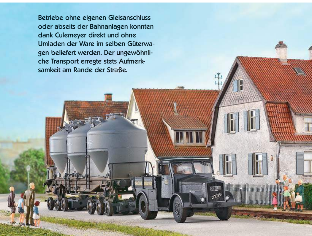
Dank Zugstange lassen sich die beiden fahrbaren Rahmen des Culemeyers zum Transport vierachsiger und damit längerer Waggons variieren.
