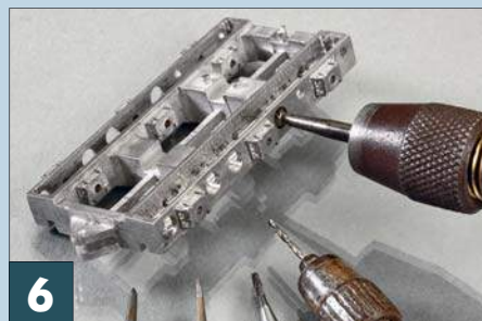
6 Die geschlossenen Öffnungen werden mit einer Reißnadel zentriert, dann etwas kleiner und danach mit dem Fräser aufgebohrt.
