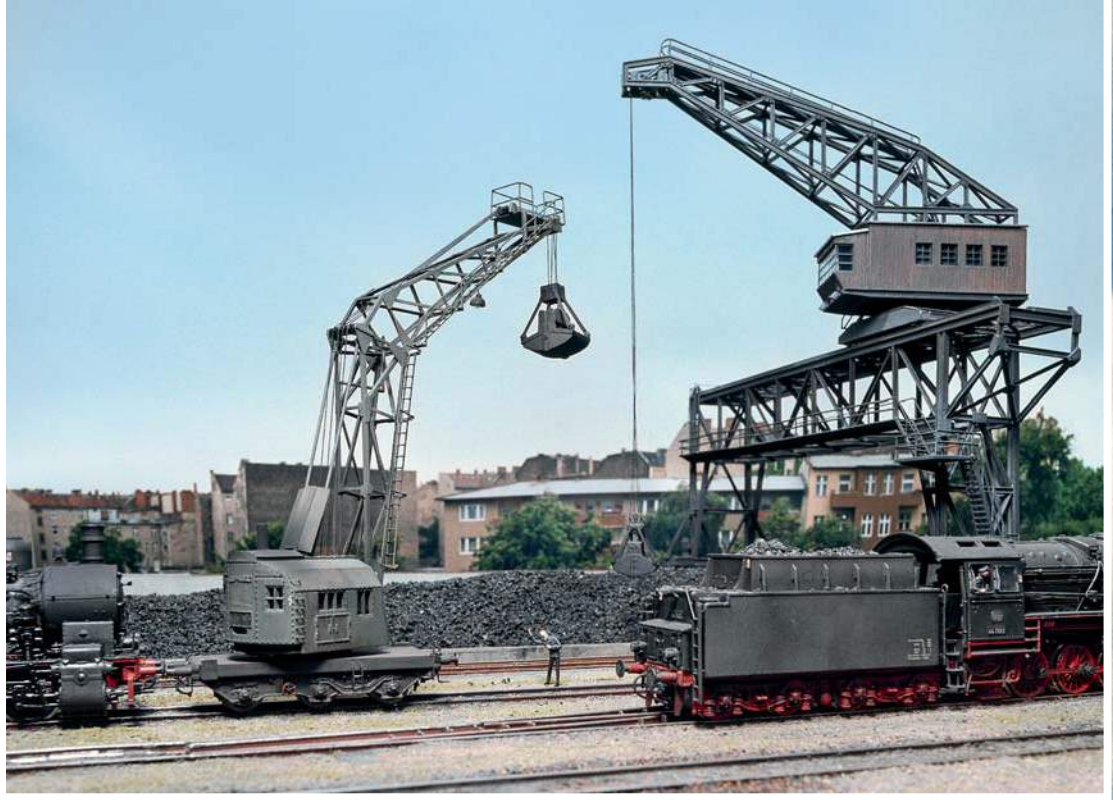
Greiferdrehkräne unterschiedlicher Prägung stehen in größeren Bahnbetriebswerken im betrieblichen Mittelpunkt rund um die Behandlungsanlagen. Regelspurkräne können zusätzlich als Verstärkung oder Notbekohlung dienen.
