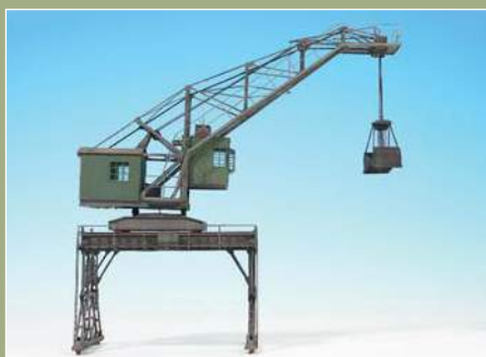
Motor- und Führerhaustrennung war ein Ansatz der DRG etwa ab Ende der 1920er-Jahre, um den Kabinenlärm zu reduzieren (B&K).
