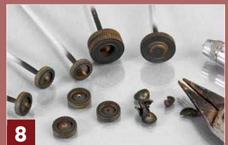
8 Nach dem Lackieren der Felgen werden diese mit Abdecklack maskiert. Die Reifen färbt man nun mit dunklem Graubraun matt.
