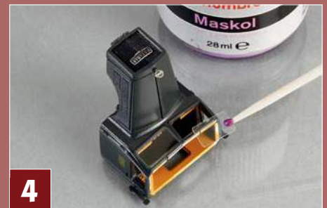
4 Die mit Abdecklack bestrichene Spitze eines Zahnstochers eignet sich gut als Halter bei der Montage der Fenster- und Lampengläser.
