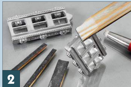
2 Auch hier sind die Gussteile im Bereich der Formtrennkante nachzuarbeiten. Die Oberflächen reinigt man mit dem Glasfaserstift.
