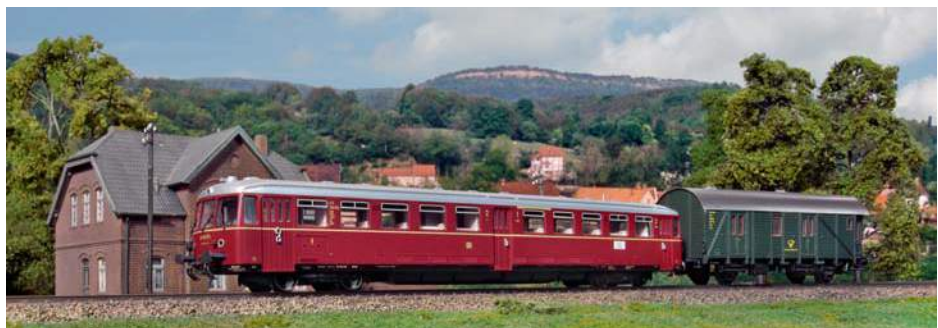
Moderne Konstrukte der Bundesbahn waren auch die zunächst in der Epoche III als ETA 150 bezeichneten Vierachser. Auf vielen Strecken zogen die Roten auch Post- oder Güterwagen.
