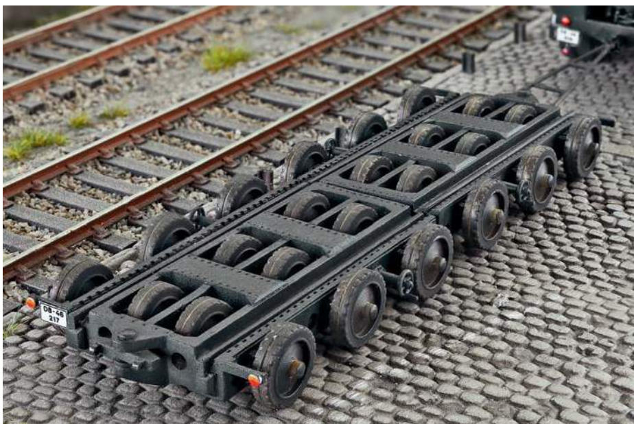
Der Culemeyer-Anhänger mit zwei kurzgekuppelten Rahmen als Standardversion zum Transport zweiachsiger Waggons. Rückleuchten und Nummernschild verfehlen ihre Wirkung nicht.
