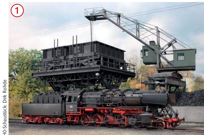
Der Wiegebunker hält die an die Lok abgegebene Kohlemenge fest und überspannt beide Lokbehandlungsgleise. Ein Kran befüllt ihn.
