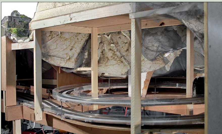
Einfache Aufbauten tragen die Gefahr in sich, langfristig sich zu verziehen, auch wenn die fertige Landschaft etwas zur Versteifung beiträgt, da Holz schrumpft und arbeitet.
