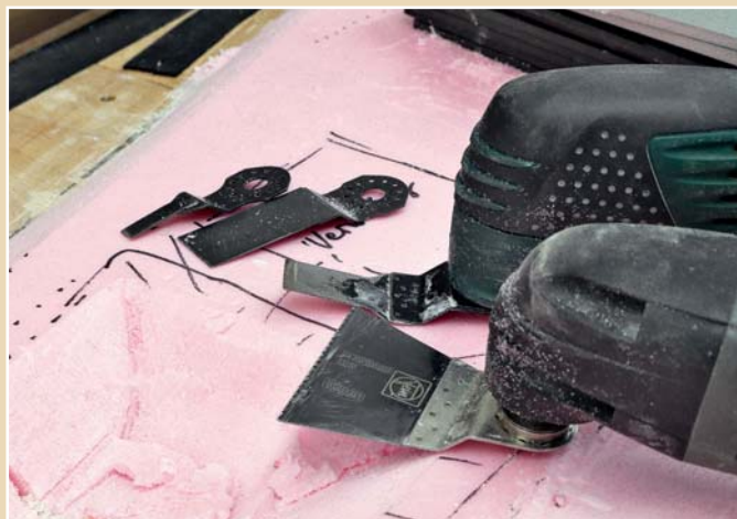
Akkubetriebene Multifunktionswerkzeuge mit verschiedenen breiten Tauchsägeblättern sind ideal zum Modellieren von Schaumplatten.
