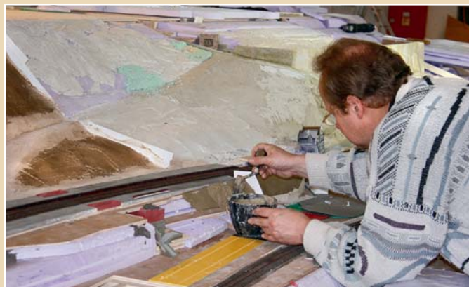
An den Übergängen der Anlagensegmente sorgt während des Baues dazwischengestecktes Papier später für eine saubere Trennung.
