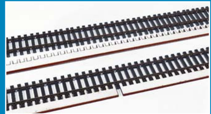
Der gelaserte 3-mm-Kamm aus Pappelsperholz sorgt bei den Tillig-Flexgleisen für Stabilität beim Ausrichten der Schwellen.
