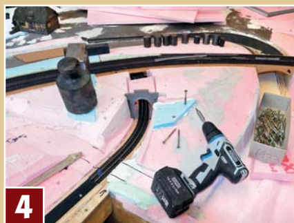
4 Die kleinen Ergänzungen werden mit auf- schäumendem Montagekleber aufgesetzt und mit Schrauben kurzzeitig fixiert.
