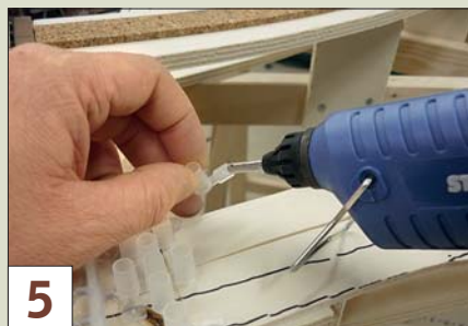
5 In ihren Halterungen fixiert man die Streben am zweckmäßigsten mit Schmelzkleber aus der Pistole mit schmaler Tülle.
