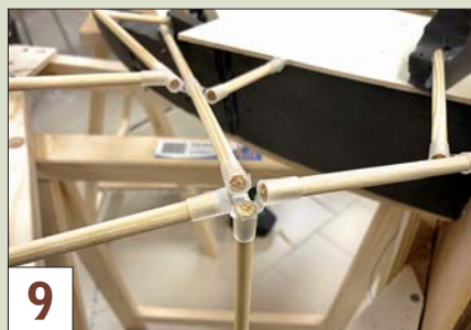
9 Auch leicht wellige Oberflächen lassen sich mit den Streben und Hüllen aufbauen, wie dieses Beispiel anschaulich aufzeigt.
