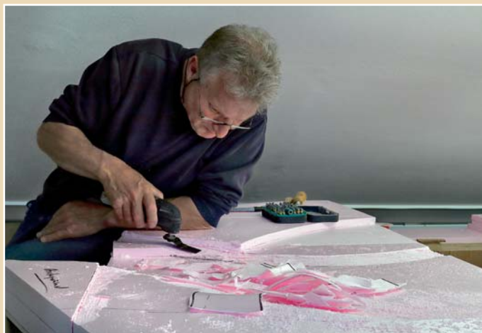
Gerade bei flachen und sanft geschwungenen Berghängen stellt sich Styrodur als ideales Unterbaumaterial für die Formgebung heraus.
