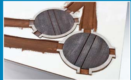
Stellprobe und Anpassen der beiden Wagendrehscheiben im Rangierbereich mit den eingelassenen Gleis-Führungen.
