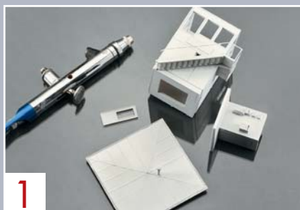
Der weiße Haftgrund mit der Bezeichnung Allgrund von Euro Top wurde mit einer feinen Spritzpistole deckend aufgetragen.
