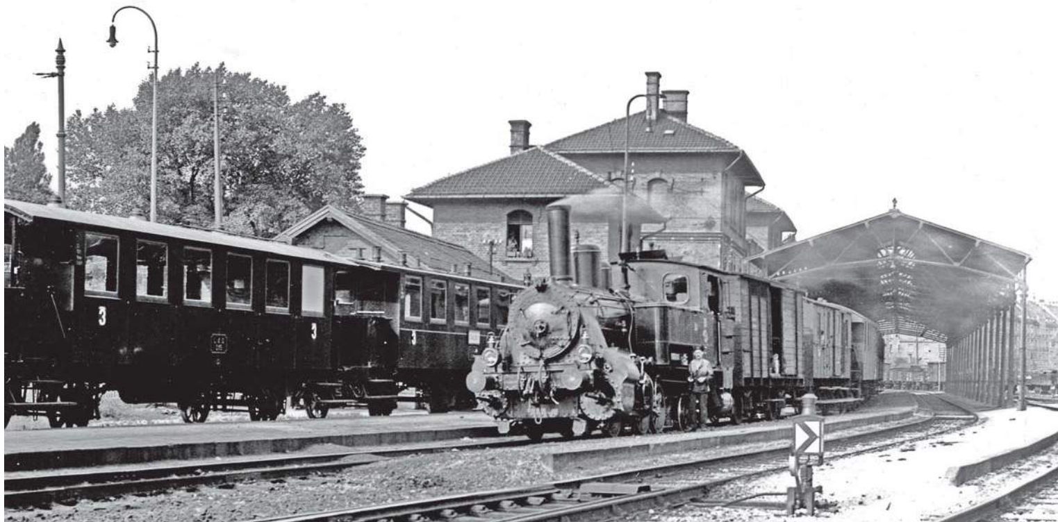
LAG 55 (Krauss 1899), die spätere 98 1502, steht im August 1929 im Isartalbahnnhof zur Abfahrt bereit. Es handelt sich gut erkennbar um eine Zweizylinder-Verbundlok.
