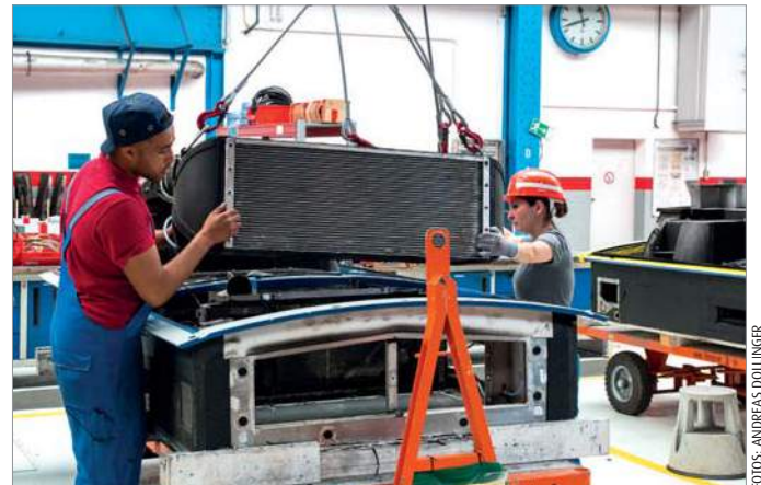
Auch die Klimaanlagen werden auf Vordermann gebracht. Nach Austausch der Filter kommen sie frisch versiegelt wieder an ihren Platz.
