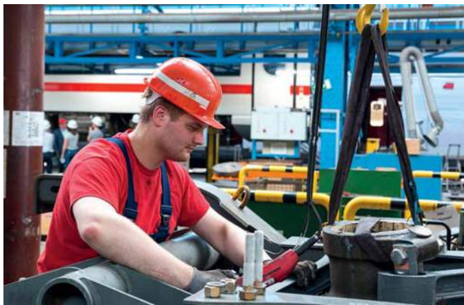
Die meisten Züge werden parallel zum Redesign auch hauptuntersucht, wobei umfangreiche Arbeiten an den Drehgestellen anfallen.
