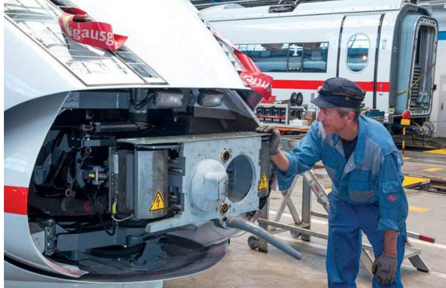
Der Endwagen von Tz 331 ist schon frisch lackiert, jetzt erhält die Kuppelung noch einen letzten Check. Im Hintergrund ist ein Mittelwagen der Vorgängergeneration zu sehen.
