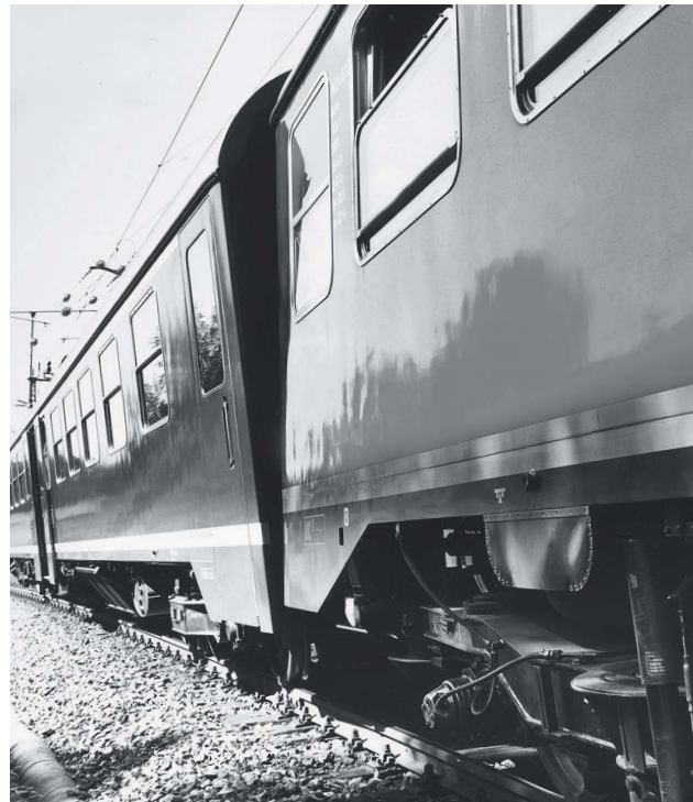
September 1965: Tests mit gleisbogenabhängiger Wagenkastensteuerung des Mittelwagens VM 24 622 zwischen München und Herrsching. Während der Triebwagen (links) der Überhöhung entsprechend schräg steht, ist der Mittelwagen durch die Luftfeder gerade gestellt
