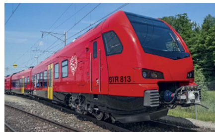
FLIRT mit bimodalem Antrieb für die Region Valle d'Aosta
