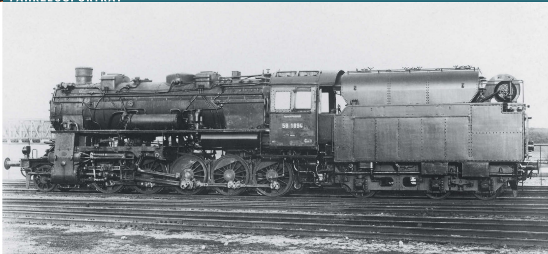
Die 58 1894 vertritt in unserer Bilderfolge die G 12 mit Kohlenstaubfeuerung in der Variante der 20er-Jahre. Gut erkennbar ist auf dem Tender die maschinelle Vortriebsanlage
