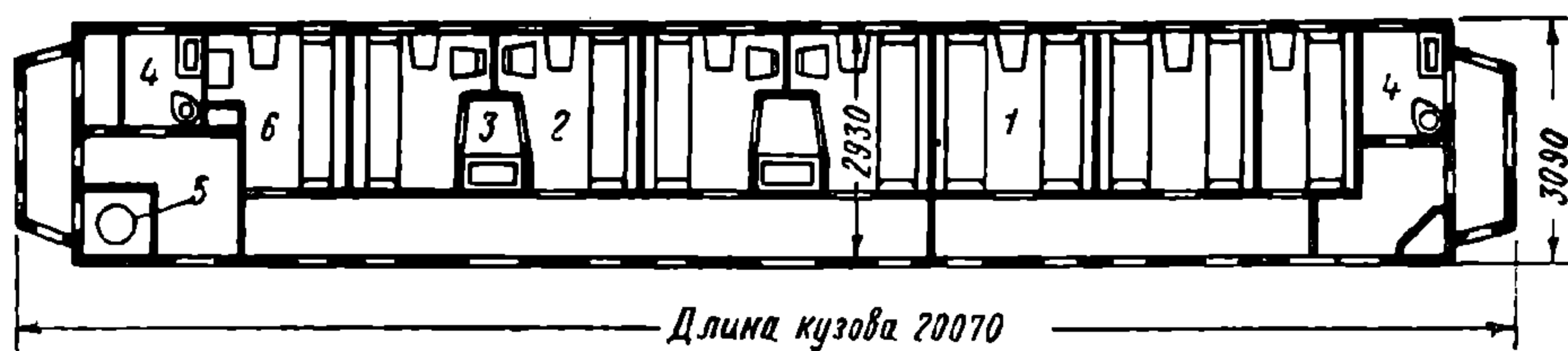
Фиг. 465. Планировка четырёхосного мягкого вагона типа СВПС
