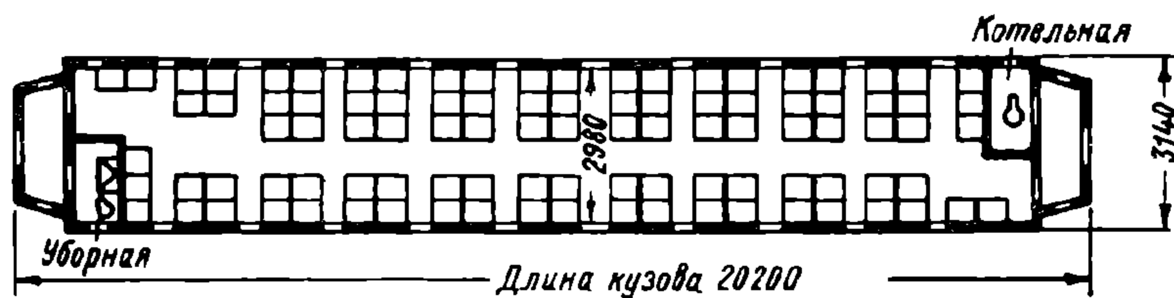
Фиг. 473. Планировка четырёхосного пригородного вагона длиной 20,2 м
