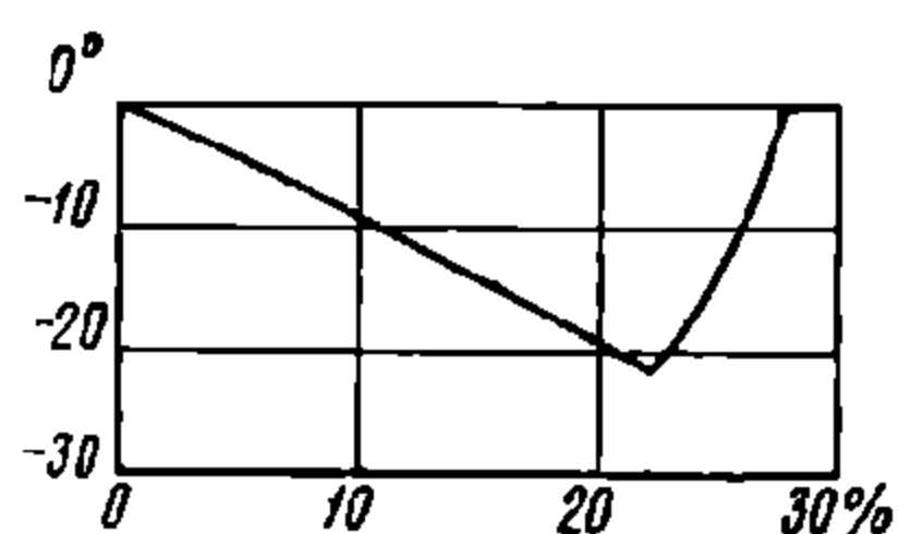
Фиг. 451. График температур замерзания соляного раствора
