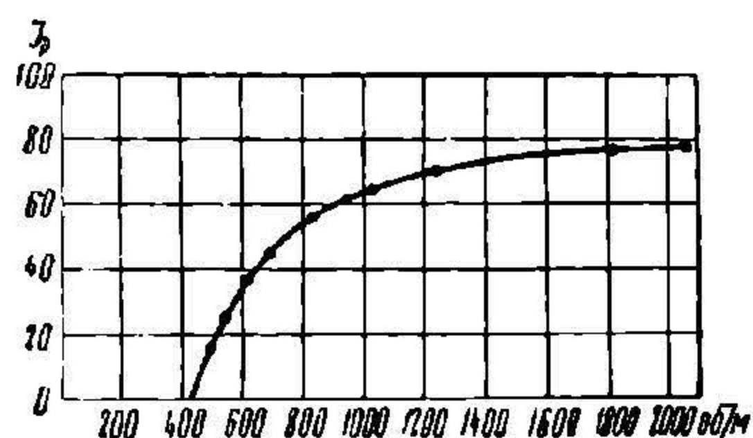
Фиг. 547. Кривые токов генератора поперечного поля
