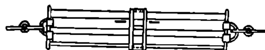
Фиг. 163. Трёхрядная листовая рессора
