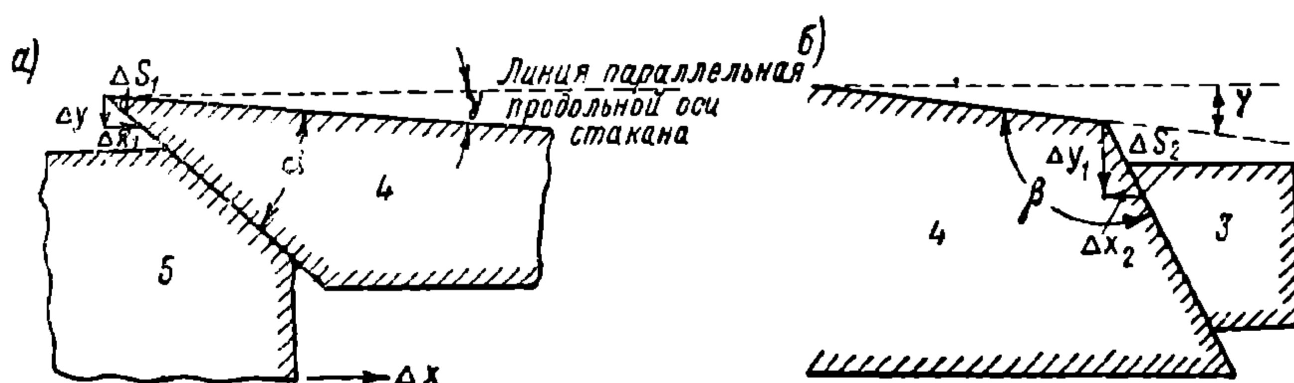
Фиг. 369. Взаимодействие клина с нажимным конусом и конусной шайбой
