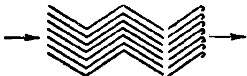
Фиг. 525. Расположение пластинок элиминатора
