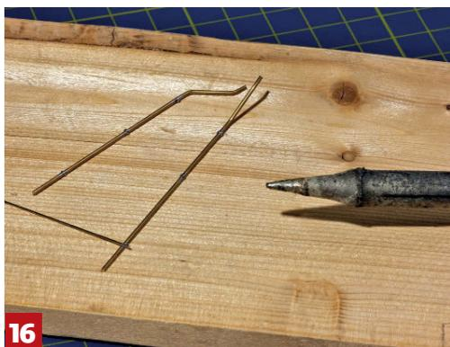
16 - Les descentes d'eau sont en fil de laiton de 1mm de diamètre. Les supports ne sont pas oubliés.
