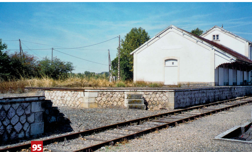
95 - À Damiatte (81), la halle à marchandises est accolée au BV et le quai est coupé en deux, parce qu'une plaque tournante permettait l'accès à une voie de garage perpendiculaire à la voie marchandises.
