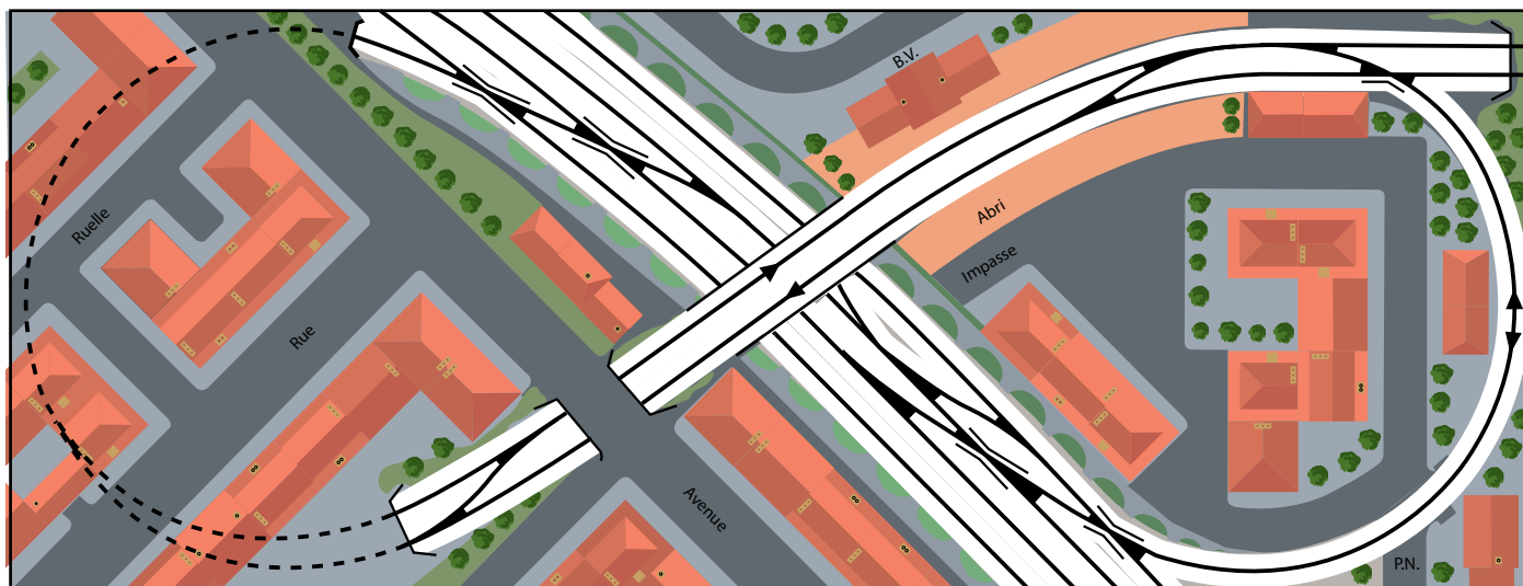
Fig. 73 - Le "huit renversé", forme plus sophistiquée du réseau bouclé (voir aussi la figure 70).
