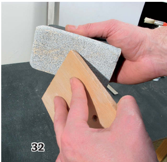
32 - Les tranches sont systématiquement poncées au papier de verre, c'est la meilleure technique pour éviter de transformer nos mains en hérisson !
