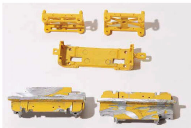
2 Première étape, après démontage de la draisine Bachmann : tronçonnage des carters, et modification du fond de châssis. Les traverses horizontales des châssis des wagonnets sont supprimées.
