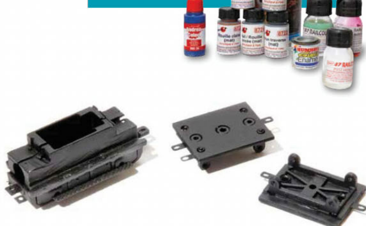
3 L'ensemble reçoit une couche d'apprêt Modelmates noir. Les marchepieds ont été fixés sans avoir remonté les essieux. C'est une erreur car tels qu'ils sont placés, il est impossible de remonter les roues...
