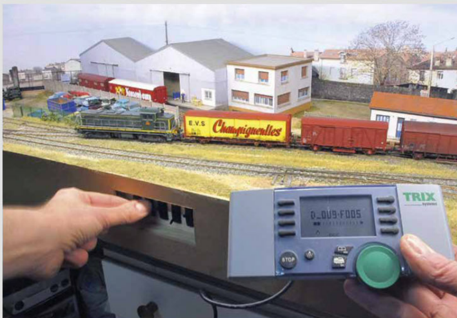
Le réseau « Rue de Suède » (décrit dans le HSLR 48) associe une commande numérique simple des trains à un système analogique pour les aiguilles et décodeurs.
