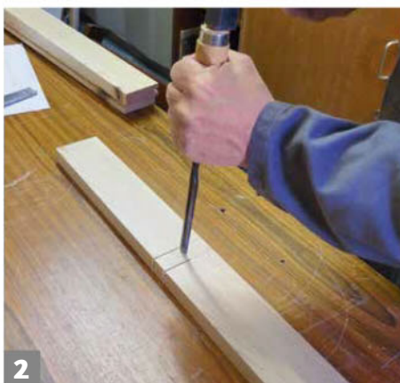
Pour l'assemblage des tasseaux, des encoches à mi-hauteur sont pratiquées au ciseau à bois.
