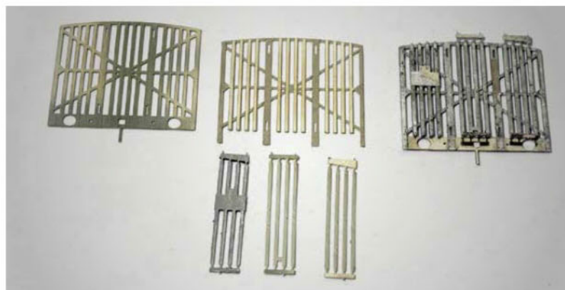
Le montage des dossiers nécessite plusieurs empilements. Étamage de rigueur! Heureusement de petites pattes (à araser ensuite) simplifient l'assemblage.
