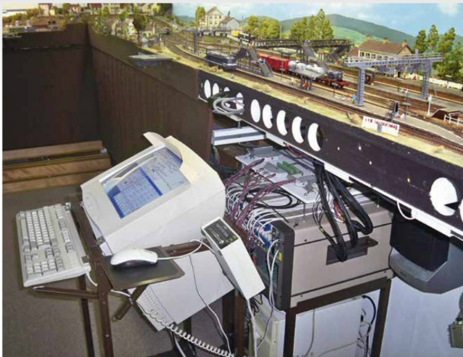
Michel Maziero (réseau dans Loco-Revue 805) a opté pour le tout analogique dans les années quatre-vingt-dix et installé un système informatisé piloté par un microcontrôleur ControlBoy F1, relié à un PC classique affichant le TCO et générant les commandes (système prochainement décrit dans Loco-Revue ).
