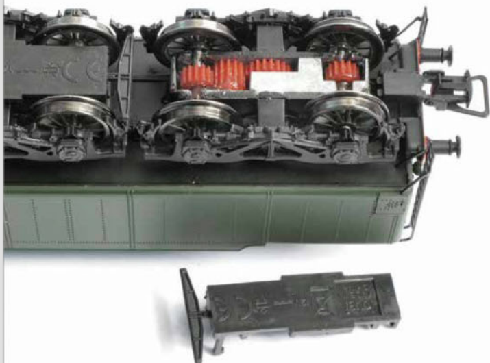
Trois essieux du tender sont moteurs : l'essieu avant et les deux essieux arrières.
