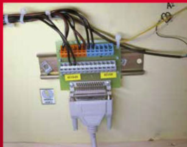
Câblage très rigoureux, à base de connecteurs informatique.
