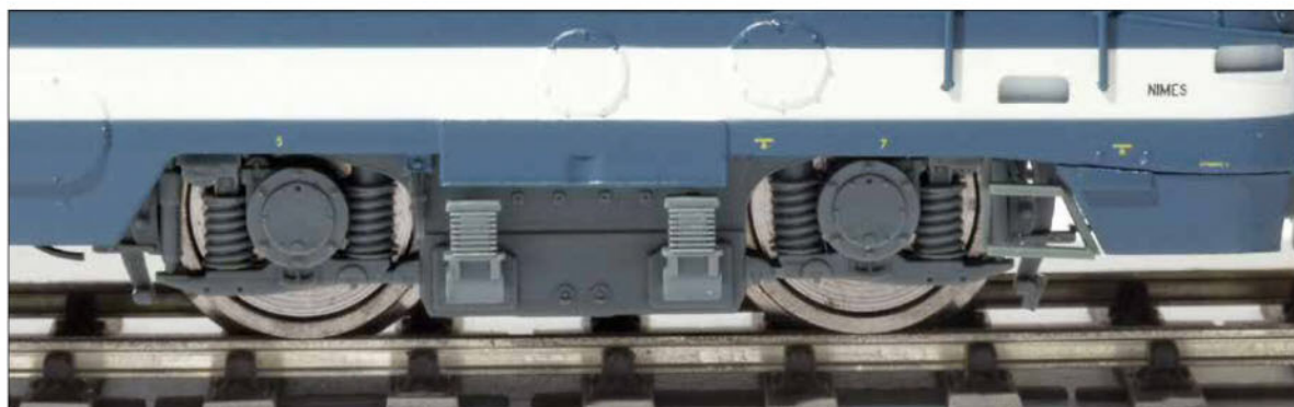
Le bogie de la BB 67455 n'a pas le dispositif de graisseur de rails mais la machine est équipée de jupes.
