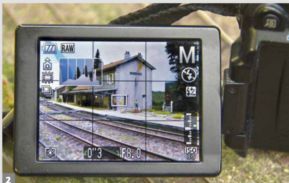
2 L'appareil (un Canon G11) est réglé en mode Manuel, l'ouverture sur le minimum possible : f8. L'exposition est ajustée par le temps de pose, +1/3, histogramme décalé le plus à droite possible, sans atteindre l'extrémité droite!
