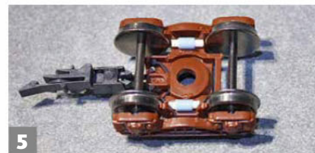
5 Les cylindres obtenus sont collés sur les supports de sabots de frein.
