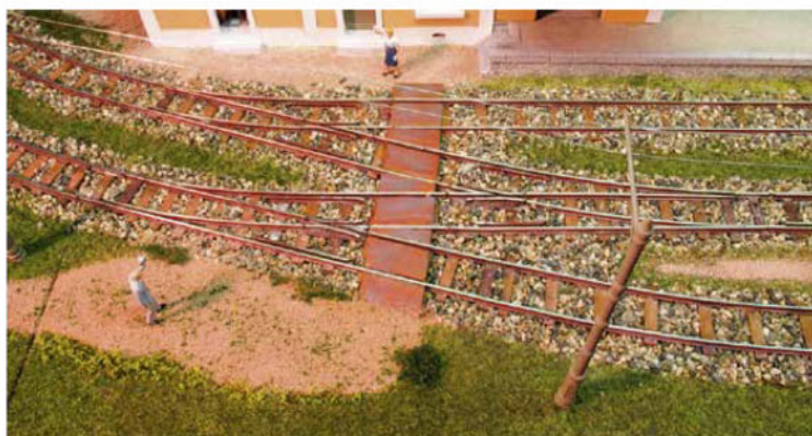
Gros plan sur les aiguilles : du rail au code 143 soudé sur des traverses découpées dans de l'époxy cuivré pour circuits imprimés.
