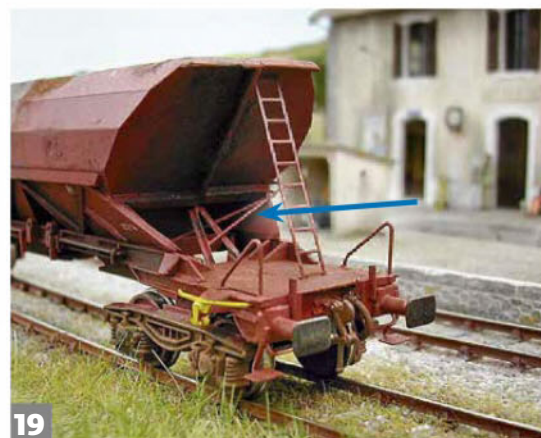
19 La tuyauterie est posée, l'extrémité des conduites est pliée à l'oblique.
