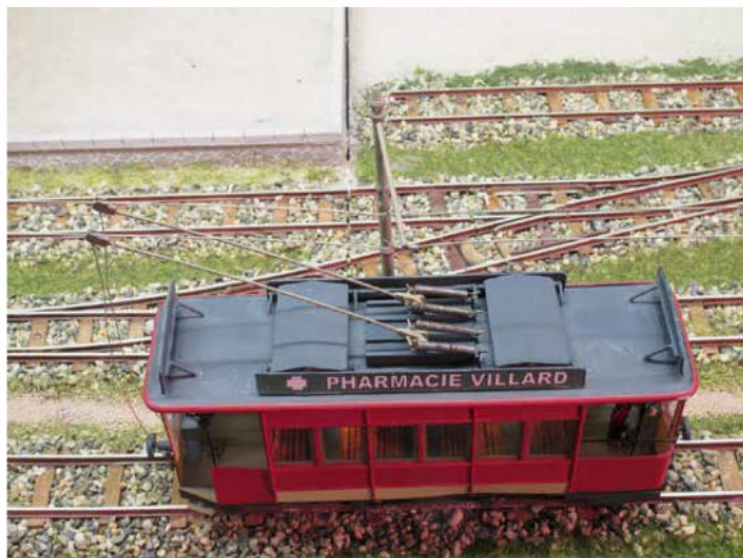
Le «dessus», des perches en corde à piano plaquées sur les fils de contact par des ressorts... de machine à écrire!
