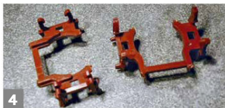
4 L'ensemble de freinage, après découpe des sabots extérieurs.
