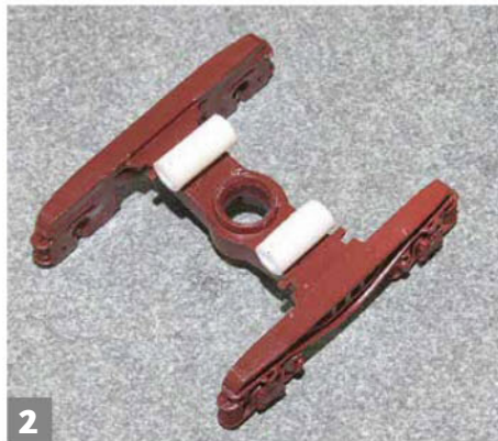
3 Le châssis est doté d'un nouveau pivot de bogie de nouveaux pivots de bogies et de cales d'appui en carte plastique.
