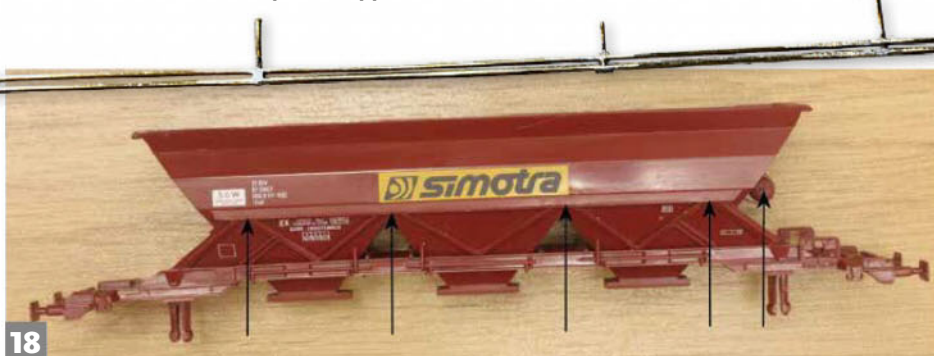
18 Il faut percer selon les flèches pour enficher les supports des conduites latérales de frein.
