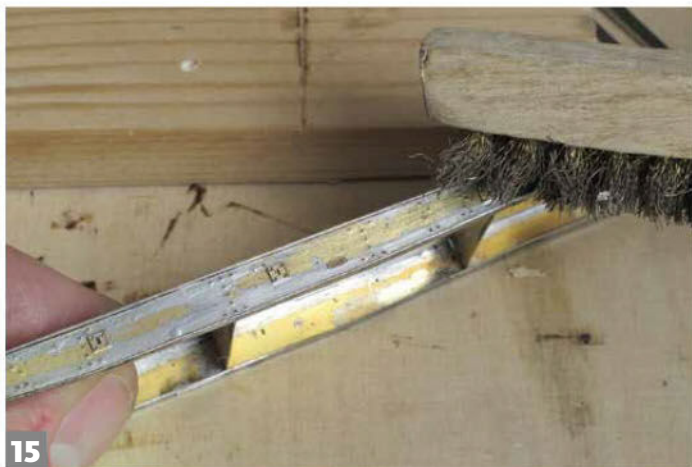
15 Après une séance de travail, un brossage vigoureux chasse les dépôts de flux brûlés.
