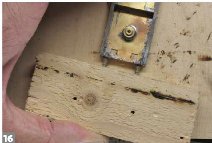
16 Pour tenir les tampons sous les extrémités pendant leur soudure, une cale en bois est la bienvenue.
