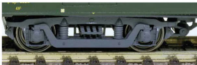
Les versions les plus modernes ont des bogies Y2 équipées de boîtes SKF.
