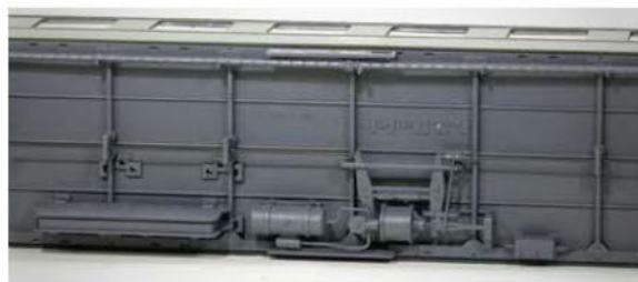
Les dessous sont comme toujours avec L.S.Models, très fidèles : la timonerie de frein est reproduite, ainsi que la conduite de chauffage calorifugée.
