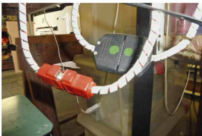
Les câbles sont regroupés en torons, et des connecteurs assurent la liaison, sous le réseau.
