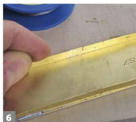
Après ébarbage, les flancs de châssis sont mis en place avec précision.
