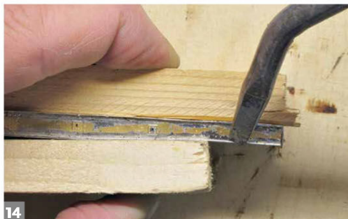
14 Pour souder la partie inférieure des longerons, le châssis est maintenu fermement entre deux cales en bois.
