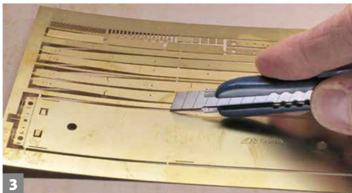
Un cutter suffit pour dégrapper les pièces, en s'appuyant sur une surface très dure.
