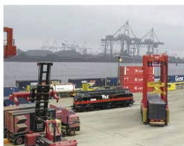
Le grand portique charge et décharge les conteneurs des camions grâce à un astucieux système d'électroaimants.
