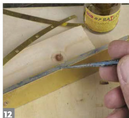
12 Avant de souder les décors des longerons, il faut répandre de la soudure liquide.
