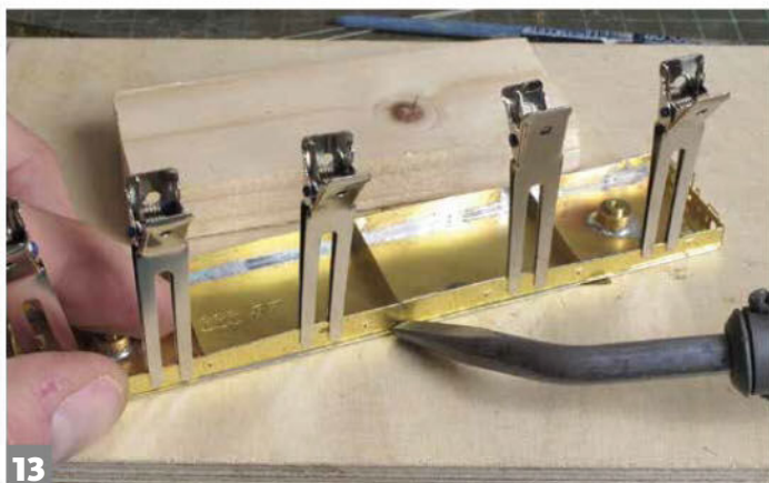
13 Le décor est tenu en place par les pinces AMF 87. Le fer approché, va faire fondre la soudure et lier les pièces.
