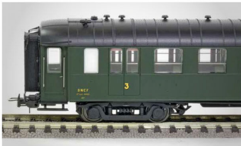
Ces voitures sont caractérisées par une double porte permettant l'accès de brancards.
