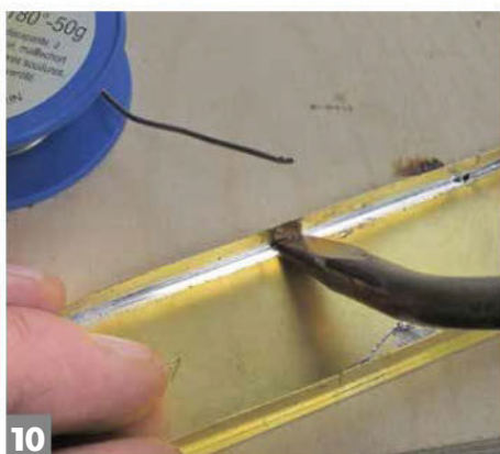
10 En déplaçant la panne le long de la jonction, un congé de soudure est facilement formé.
