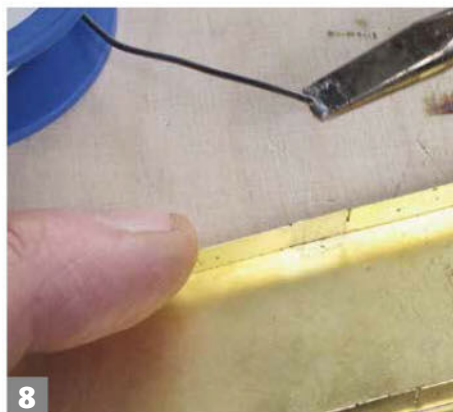
Alors que la main gauche tient toujours en place les pièces à souder, la panne du fer touche le fil de soudure à l'étain. Une goutte se forme sur la panne.
