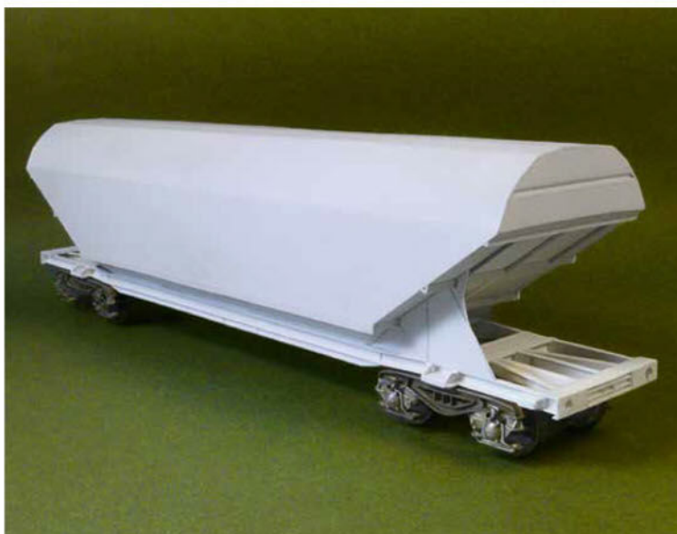
9 Le début de la pose des renforts « triangulaires » entre le châssis et l'extrémité de la citerne.
