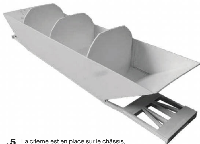
5 La citerne est en place sur le châssis, avec les parois inclinées d'extrémité.
