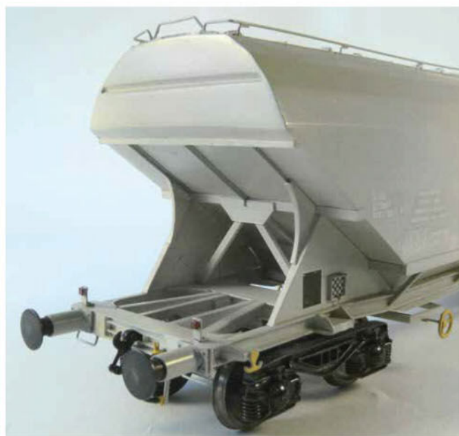
14 L'extrémité côté opposé à la passerelle, avec les renforts de citerne.
