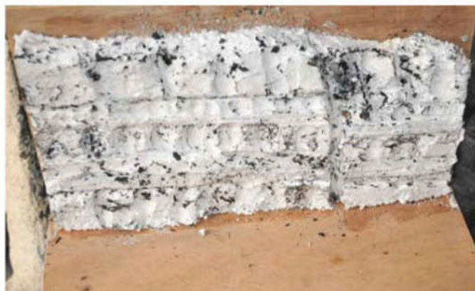
2 La masse de polystyrène est sculptée avec la lame préalablement chauffée d'un vieux couteau. Les strates et cassures verticales sont modelées grossièrement.
