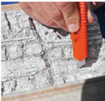
4 Après séchage, des entailles verticales et horizontales, faites avec la lame d'un cutter, matérialisent les fractures de la roche.
