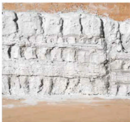
3 Le polystyrène est recouvert d'un enduit composé de plâtre, de colle à bois et d'une noisette de peinture acrylique noire en tube.
