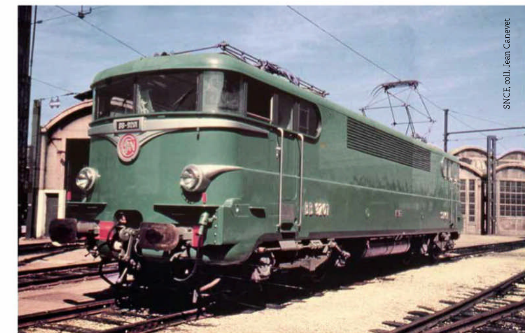
La BB 9233 est ici en version d'origine. On remarque les distributeurs de freins, les mains courantes, et autres détails reproduits page 53.
