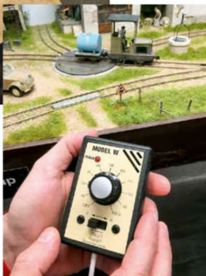
Une commande anglaise Gaugemaster délivre un courant pulsé qui autorise de fantastiques ralentis.
