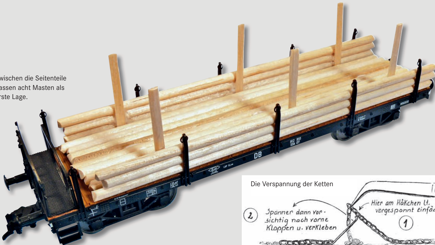
Die Seitenteile der Ladung bestehen aus jeweils drei Masten plus Stützen.
