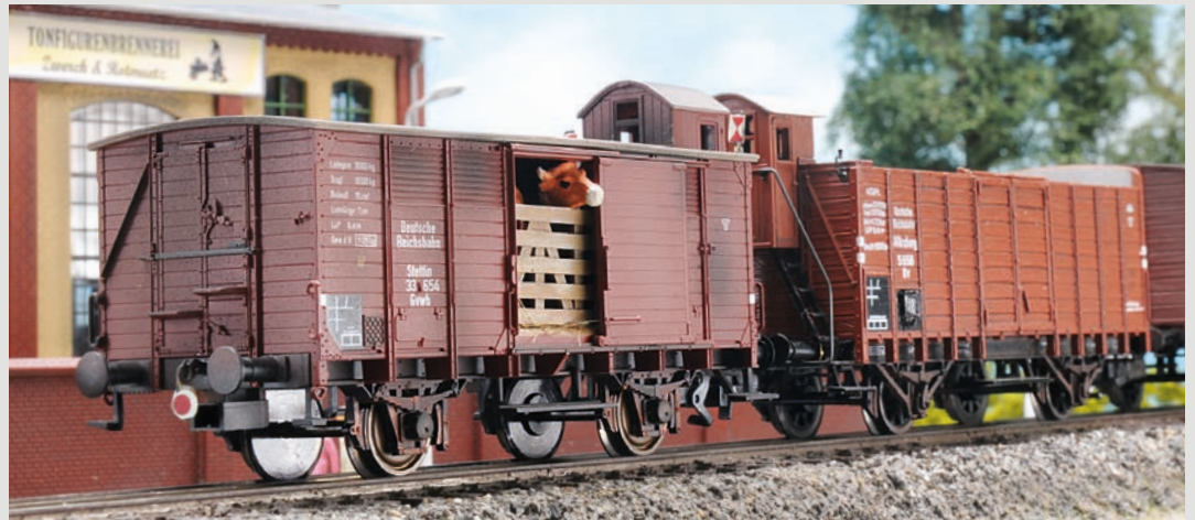
Eine Kuh lugt aus der Tür eines Viehtransportwagens der DRG-Gattung Gvwh Stettin: Keine Frage, was da befördert wird. Dieser preußische Wagentyp besaß sogar Stirnwandtüren.
