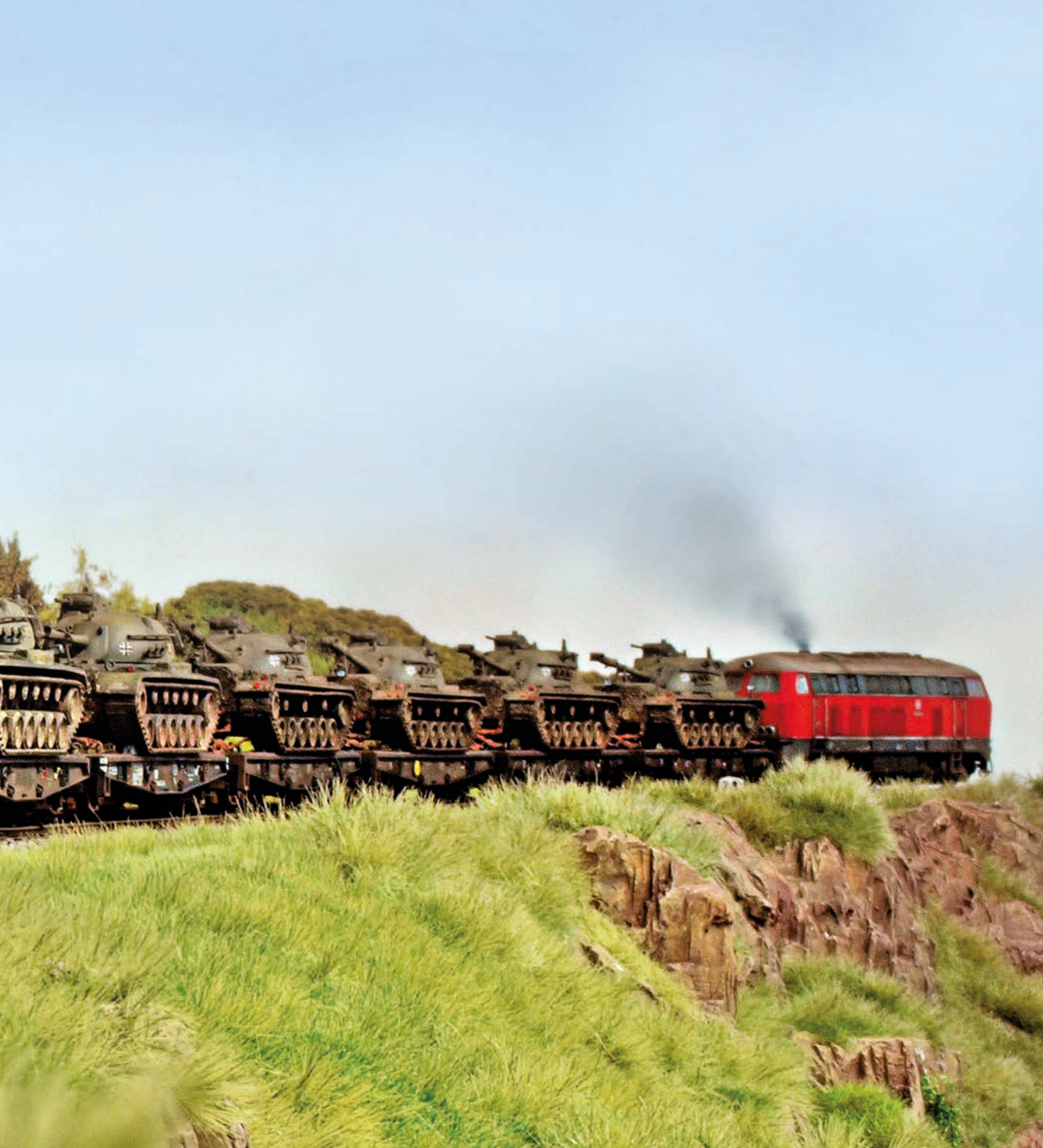
Ein Zug mit Bundeswehrpanzern des Typs M 48 in den 70er Jahren. Die Garnitur hinter der 216 ist komplett aus Schwerlastwagen gebildet, um die jeweils 45 t wiegenden Stahlkolosse transportieren zu können. Gut zu sehen ist auch im Modell, dass bahnverladene Panzer seitlich leicht über die Waggons ragen.
