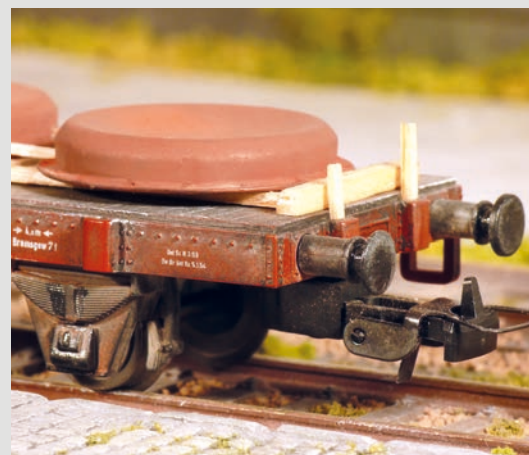
An der Stirnseite bieten kleine Rungenstummel zusätzlichen Schutz gegen Verrutschen.
