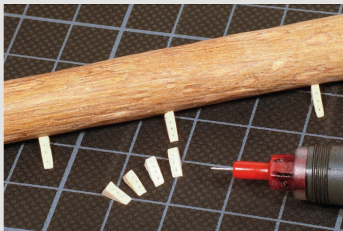
Aus dem Holzprofil entstehen die Befestigungskeile. Tuschenpunkte bilden die Nagelköpfe nach.
