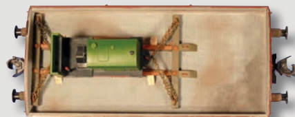
Dieser X 05-Wagen italienischer Herkunft bietet mit seinen festen Wänden sicheren Halt in eine der Längsrichtungen. Auf der anderen Seite sichern zwei wiederverwendbare Keile die Ladung. Das Ladegestell wurde beschriftet, was stets sehr authentisch wirkt.
