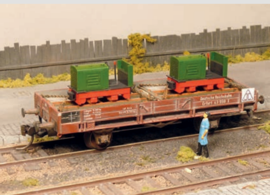
Ganz ohne Keile kommt man im X Erfurt aus, der von der DB ebenfalls mit X 05 bezeichnet wurde. Werden die beiden Ladegestelle durch passende Balken fest an die Stirnwände gedrückt, ist ein Verrutschen auch zur Seite unmöglich.
