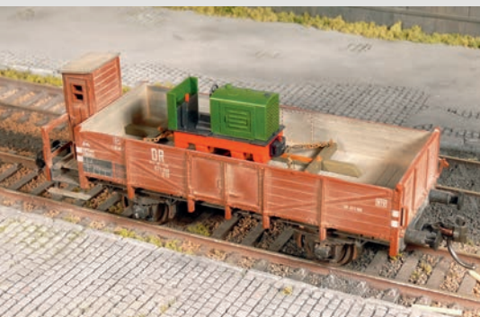
Ladungssicherung auf Wagen des Typs O 10: Während sich beim Wagen mit Bremserhaus das Transportgestell an der festen Stirnwand abstützt (oben rechts), sind beim O 10 ohne Bremserhaus beide Stirnwände klappbar. Das Transportgestell mit der Feldbahnlok muss in der Wagenmitte platziert werden. Für die Stabilität der Ladung sorgen 16 Holzkeile (rechts).
