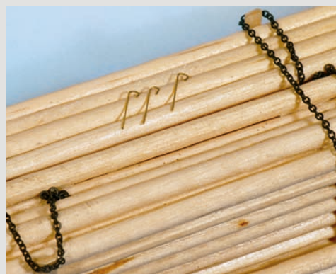
Die Spannhaken aus Draht werden einseitig zur offenen Öse gebogen.
