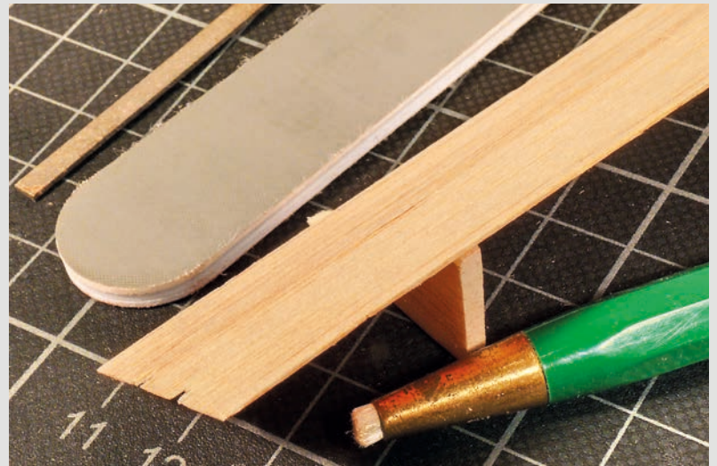
Das Balsaplättchen wird an den Kanten dünner gefeilt und ausgefranst.
