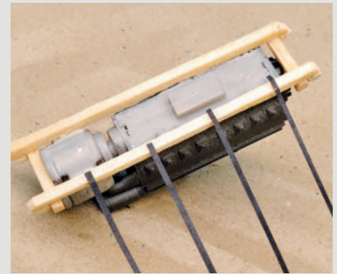
Die Spannbänder klebt man unter den Längsbalken fest, nicht am Wagen.
