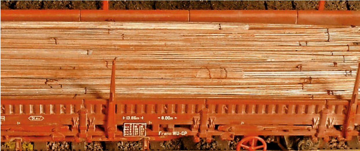
Nahansicht der Stahlbündel. Gut zu erkennen sind die feinen Drahtwicklungen um jedes Paket.
