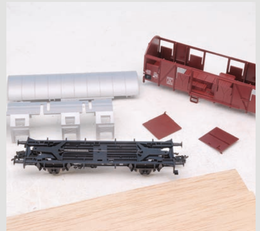
Der in seine Hauptbaugruppen zerlegte Fleischmann-Wagen. Im Inneren des Kastens ist Stückgut nachgebildet, das herausgesägt werden muss.
