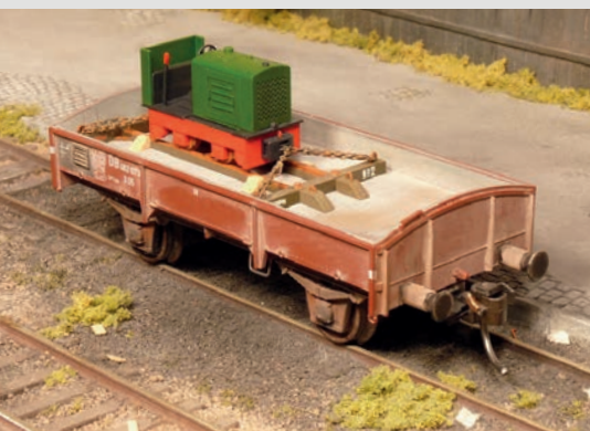
Dieser X 05-Wagen italienischer Herkunft bietet mit seinen festen Wänden sicheren Halt in eine der Längsrichtungen. Auf der anderen Seite sichern zwei wiederverwendbare Keile die Ladung. Das Ladegestell wurde beschriftet, was stets sehr authentisch wirkt.
