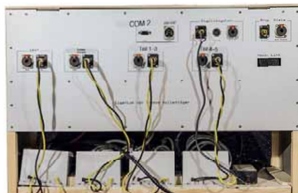
Alle Anzeige- und Bedienelemente sind auf der Front der „Kiste“ übersichtlich angeordnet (links). Die Kabel von und zur Anlage werden rückseitig durch Steckverbindungen ausgeführt (rechts). So herrscht Ordnung und das System ist schnell auf- und abgebaut.
