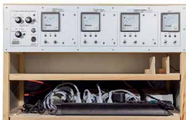
Alle Anzeige- und Bedienelemente sind auf der Front der „Kiste“ übersichtlich angeordnet (links). Die Kabel von und zur Anlage werden rückseitig durch Steckverbindungen ausgeführt (rechts). So herrscht Ordnung und das System ist schnell auf- und abgebaut.
