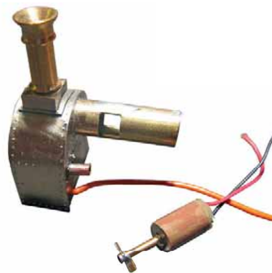
Die neu gebaute Rauchkammer samt Öffnung und Halterung für den Ventilator
