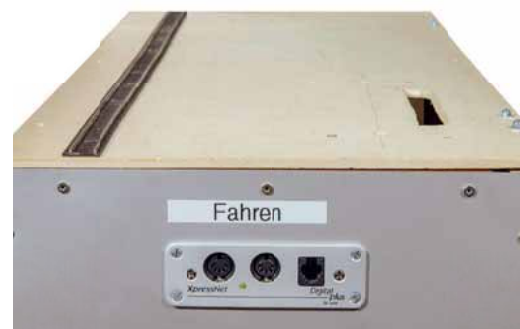
An den Seiten befinden sich zusätzliche Anschlussmöglichkeiten für Handfahrgeräte, wie das LH100 oder die Lokmaus von Roco.
