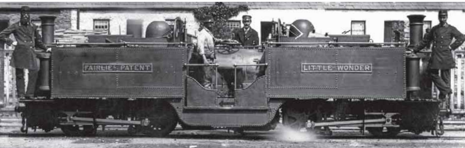
Historische Abbildung der echten Little-Wonder. Gut erkennbar ist die Situation der Feuertür in einer Nische des mittig angeordneten Stehkessels.
