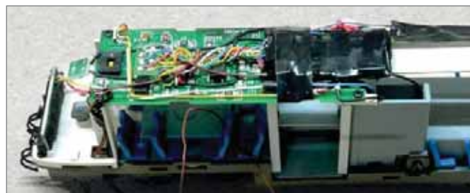
So wird der Decoder eingesetzt.
