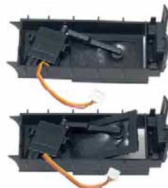
Im Tenderinneren zieht ein Mini-Servo die Folie, die die Kohlenoberfläche bildet, nach unten.
