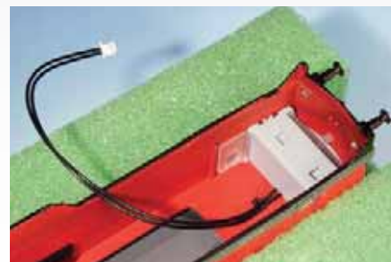
Die beste Lösung zur Installation der Führerstandsbeleuchtung
