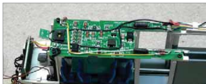
Der Kunststoffsteg ist entfernt, die Verkabelung inkl. zweier Dioden ist vollständig.
