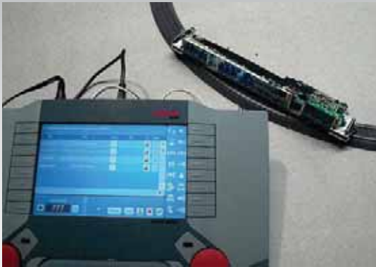
Erste „Probetestung“ auf dem Gleis: Das Fahrzeug meldet sich mit dem mfx-Decoder selbst an.
