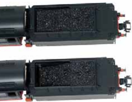
„Voller“ und „leerer“ Tender: Die lokzugewandte Kohlenfläche wird abgesenkt.
