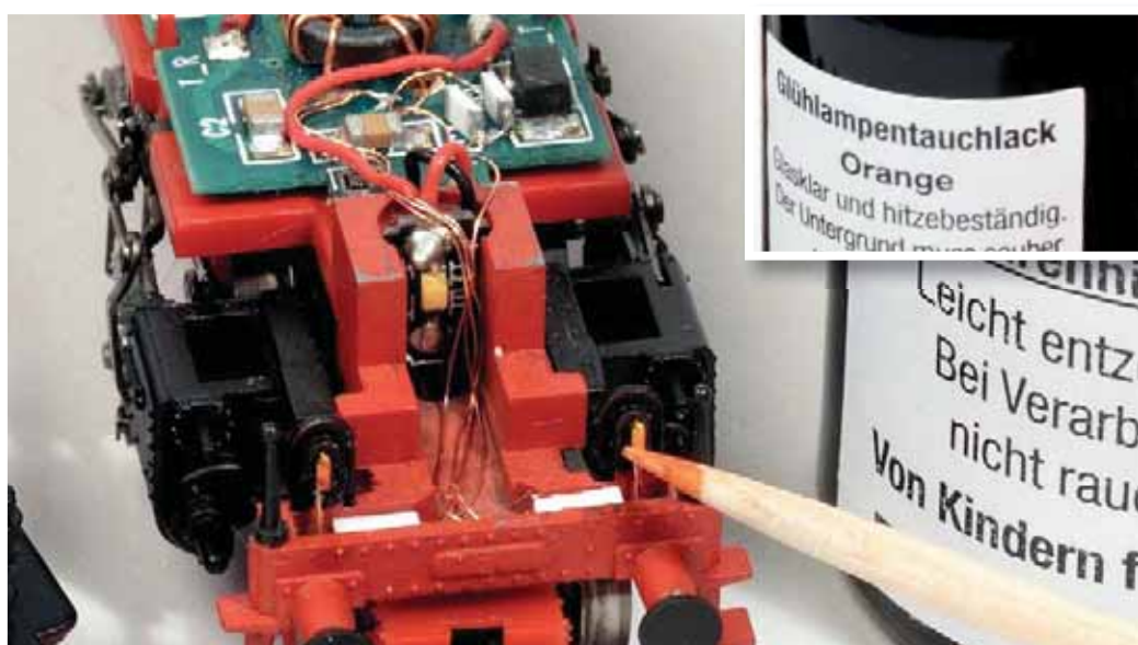
Mit einem Zahnstocher erhalten die winzigen Glühwürmchen von LEDs einen orangefarbenen Überzug, damit warmes Licht wie das von Glühlampen die Loklaternen erhellt.
