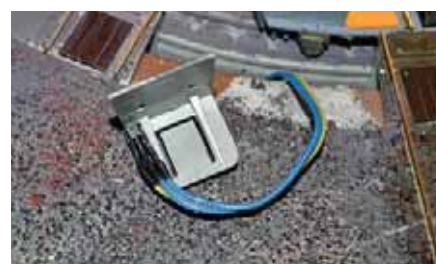
Der Positionsmagnet wurde unter dem Bühnenhäuschen fixiert und der Hall-sensor am Bühnenabgang (unten), um das Gleis 1 zu definieren.
