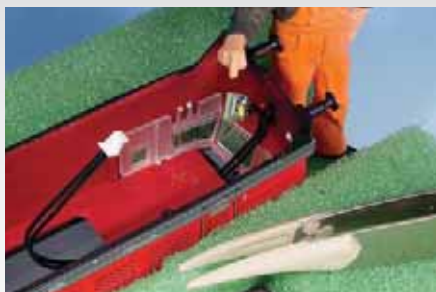
Die Führerstandsbeleuchtung wird im Dachrahmen verlegt.
