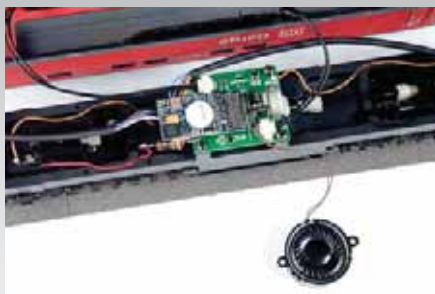
Der eingesetzte Sounddecoder von ESU samt Lautsprecher
