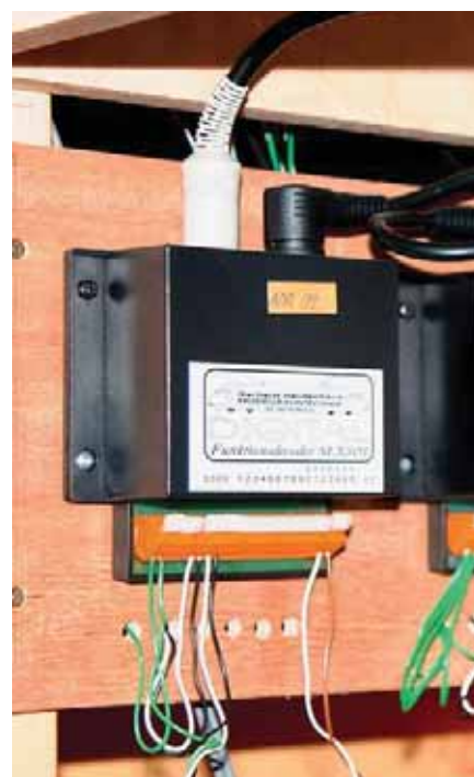
Einer für alles: Auch die Funktionsdecoder, hier der SX808 von Rautenhaus, werden über den SX-Bus mit Informationen versorgt.
