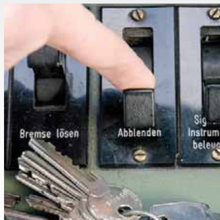
Vorbildgetreu lassen sich am Modell wahlweise die Hauptführerstandsbeleuchtung (links) als auch das Notlicht (rechts) einschalten. Die Vorbildfotos dienen dem Vergleich.
