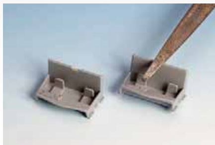
Je nach Kabelführung sind kleine Anpassungen an den Rückwänden nötig.
