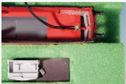
Etwas Fotokleber oder doppelseitiges Klebeband halten die Platine mit der LED.
