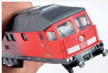
Das Gehäuse mit den neuen Laternenschächten
