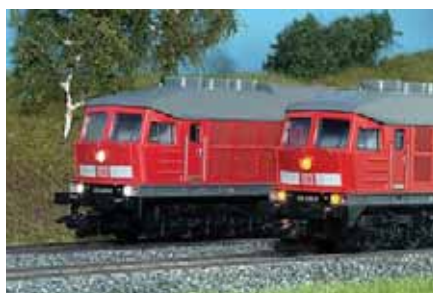
Erster Vergleich der neuen (rechts) und alten Beleuchtung in Fahrtrichtung vorwärts
