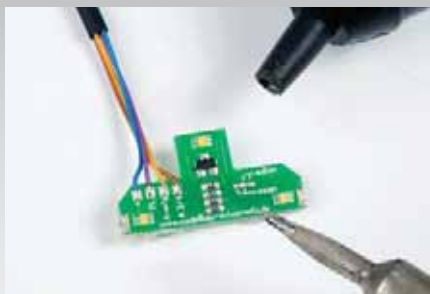
Umlöten der Platinenbrücke für alternierend wechselnde Lichter Rot/Weiß
