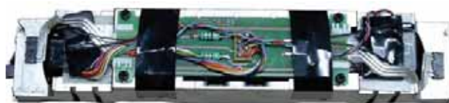
Zustand nach dem Umbau: Alle Bauteile haben eine Auflage erhalten, die Kabel sind sauber fixiert.
