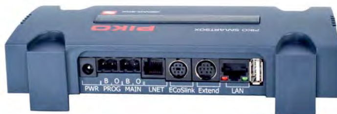
An den Anschlüssen der SmartBox erkennt man, dass sie eine vollwertige DCC-Zentrale ist. Neben dem „PROG“-Anschluss für die Einstellung von Decodern stehen mit dem „Extend“- und dem „LNET“-Port Buchsen für Melder zur Verfügung. Noch ist die LocoNet-Buchse jedoch ohne Funktion, erst ein Update in den nächsten Monaten soll die Funktionalität möglich machen.
