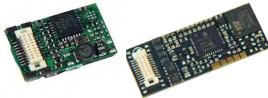
Zwei Decoder mit Next18-Schnittstelle
