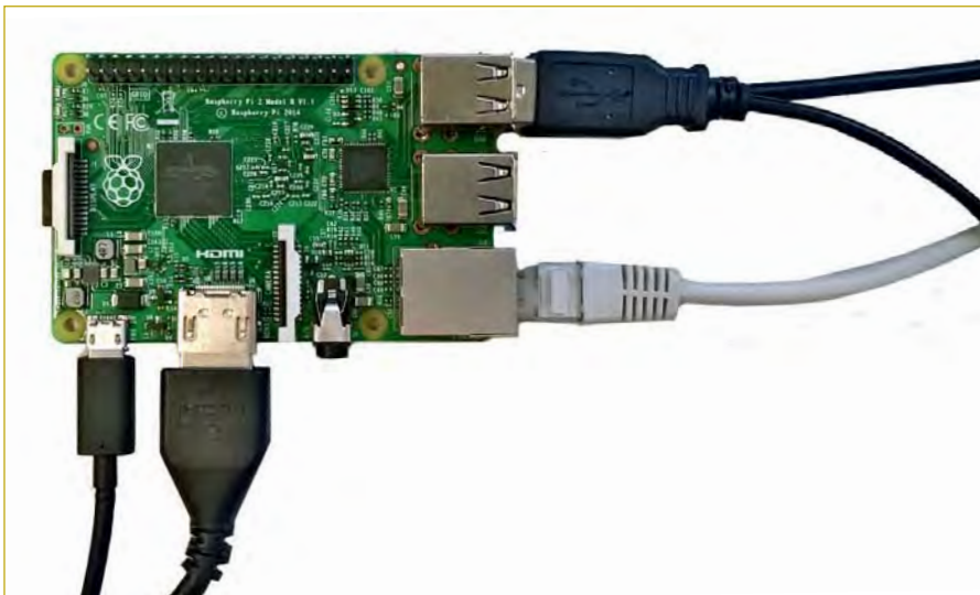
Abb. 5: Am Raspberry Pi 2 wurden die Stromversorgung, der Monitor, Tastatur, Maus und Netzwerk angeschlossen.
