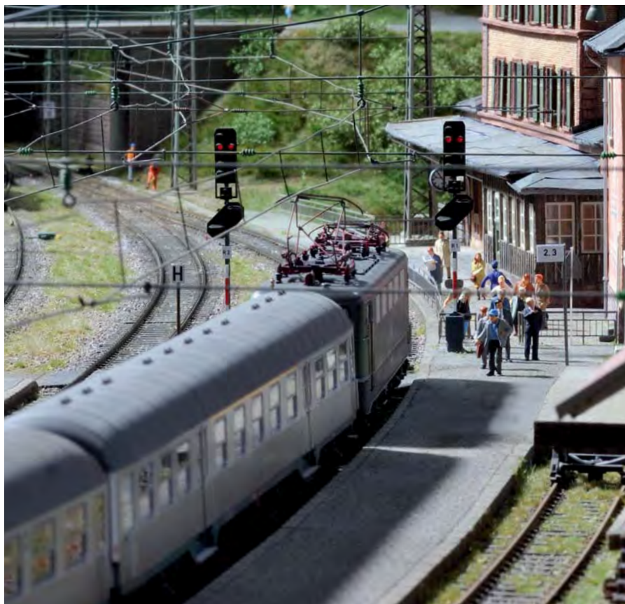
Punktgenau hält der Zug genau vor dem Signal an Bahnsteig 1. Eine entsprechende Ausstattung mit Belegtmeldern macht dies möglich.
