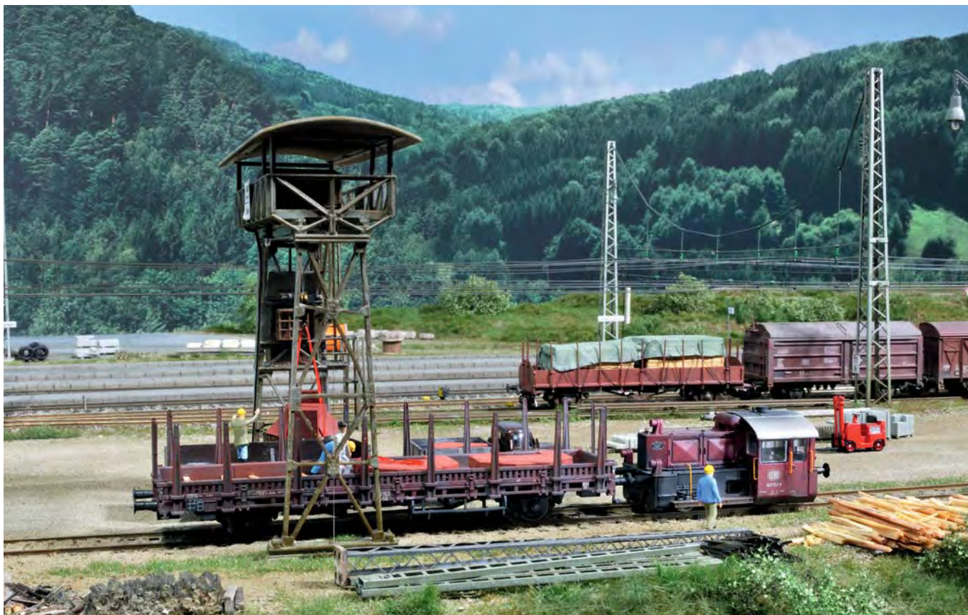
Das Rangiergeschäft lässt sich komplett manuell abwickeln. Das An- und Abkuppeln von Loks und Wagen und auch das Absetzen von ganzen Wagengruppen ist durch den Einsatz fernbedienter Kupplungen möglich.
