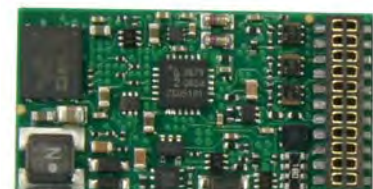
Decoder mit 21MTC-Schnittstelle
