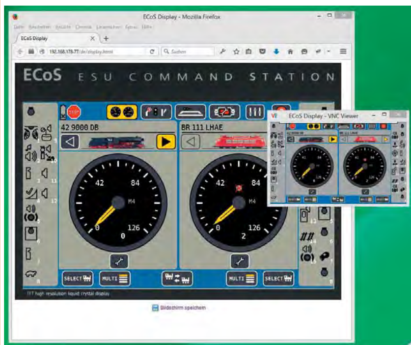
Die ECoS enthält einen VNC-Server. So lässt sich die Zentrale im Browser per Java-Applet und auch mit einer VNC-Clientsoftware (hier im verkleinerten Fenster von RealVNC) fernsteuern.
