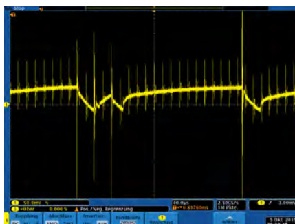
Bahnströme einer Märklin CS 2 bei 2 A und 4 A, mit einem ohmschen Lastwiderstand gemessen
