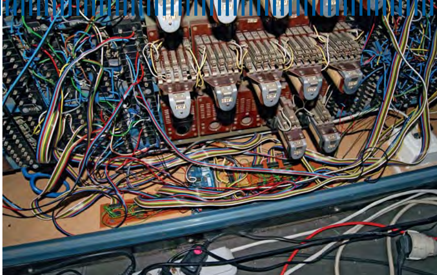
Blick in das Innere des Pults: Unter den vielen Kabeln kann man den Arduino durchschimmern sehen. Die I²C-Bausteine sind auf Lochrasterplatten aufgelötet.
