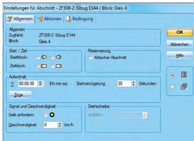
Die Bahnsteiggleise haben drei Belegtmelder. Hier wird festgelegt, dass ein Zug mit planmäßigem Halt passend zum Bahnsteigende zum Stehen kommt.
