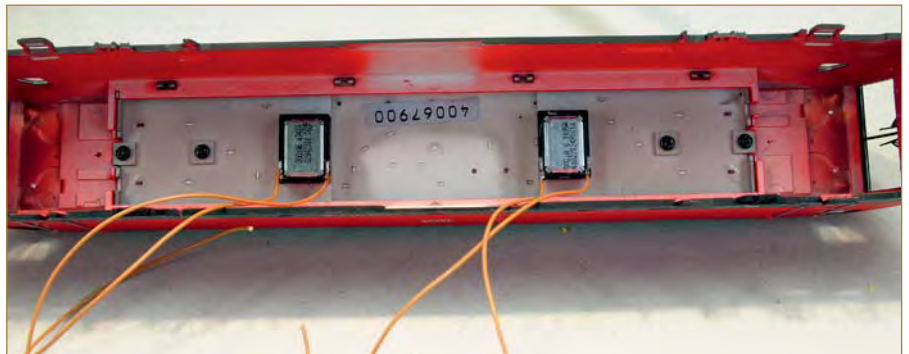
Im Lokgehäuse sind zwei Aufnahmen für rechteckige Lautsprecher. Diese werden dort mit einem Hauch Sekundenkleber eingesetzt.
