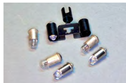
Die Glühbirnchen werden durch passende LED-Leuchtmittel ersetzt.
