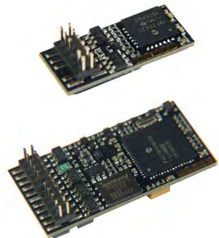
Oben Decoder mit PluX12-, unten mit PluX22-Schnittstelle
