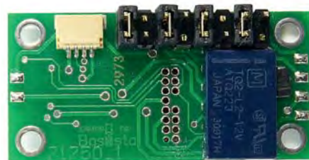
Die Schleifer-Umschaltplatine 71750 von Uhlenbrock stellt neben der PluX16-Steckverbindung auch eine SUSI-Schnittstelle für den Anschluss von Soundmodulen oder LISSY-Komponenten zur Verfügung.
