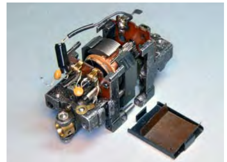
Zum Einbau des Permanentmagneten wird der Motor weiter zerlegt.
