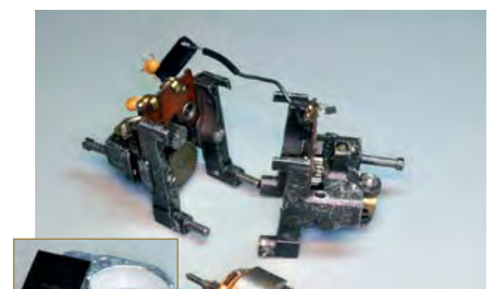
Zum Einbau des Permanentmagneten wird der Motor weiter zerlegt.
