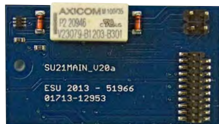
ESU setzt bei seiner Schleiferumschaltung 51966 auf die 21MTC-Schnittstelle. Kompatibel ab Loksound V3.5 bzw. Lokpilot V3.0 funktioniert die automatische Schleiferumschaltung über die Ausgänge AUX3 und AUX4 des Digitaldecoders.
