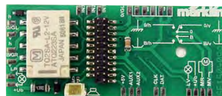
Die Märklin-Schleiferumschaltung 60973 ist sowohl für Mittelleiterlokomotiven (Märklin) als auch für Zweileiter-Fahrzeuge (z.B. Trix) einsetzbar und trägt alle notwendigen Anschlüsse – Funktion sauber aufgedruckt – auf der Oberseite.
