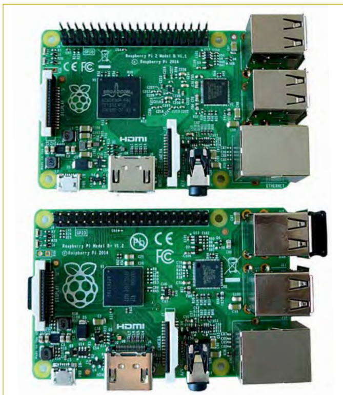
Abb. 2: Vorderseite der Modelle Raspberry Pi 2, Modell B (oben) und Raspberry Pi 1, Modell B+ (unten)
