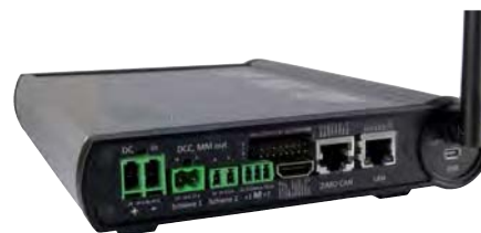
Die Rückseite des MX10 weist eine Vielzahl von Anschlüssen auf. Zimo-CAN und LAN liegen direkt nebeneinander und dürfen auf keinen Fall verwechselt werden.
