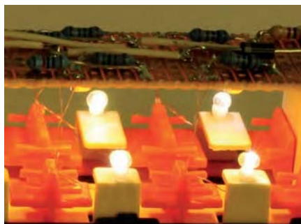
Das Ergebnis der Mühen: Die Tischlampen leuchten. Man erkennt die senkrecht auf den Sitzlehnen nach oben geführten Kupferlackdrähtchen. Oben die mit Widerständen bestückte Lochrasterplatine.
