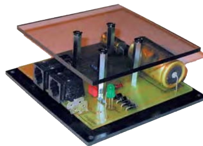
CAN Bus Power von AMW unterstützt die von Zimo vorgesehene Energieübertragung über die CAN-Bus-Kabel, indem zusätzlich Strom eingespeist wird.
