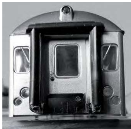
Vier unauffällige Löcher für die LWL zum IR-Empfang hat der „Hasenkasten“ bekommen.
