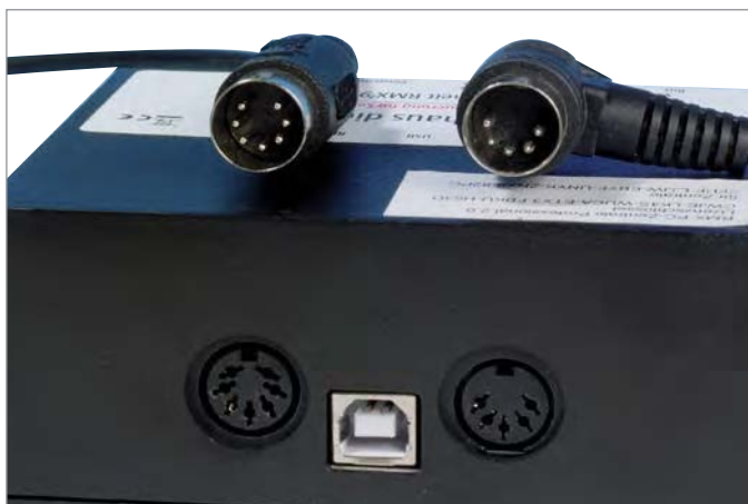
Treffen der Generationen: Links der neue RMX 7 -Bus, welcher zwei Busse in einem 7-poligen Kabel abwärtskompatibel vereint, rechts der herkömmliche 5-polige SX-Bus.
