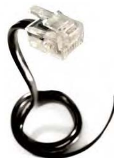
Telefonkabel mit 6-poligem Western-Stecker RJ12 6-6. Kabel dieser Art sind ungeschirmt und daher für hohe Datenübertragungsraten nicht geeignet. Spiralige Varianten bieten sich zum Anschluss mobiler Geräte an.
