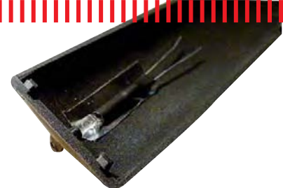
Hier sieht man, wie eine LED mit einem Schrumpfschlauch an den Lichtleiter angeflanscht wurde.
