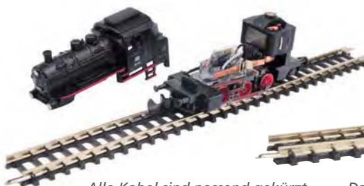
Alle Kabel sind passend gekürzt und angeschlossen. Nun werden Fahrwerk und Gehäuse zusammenmontiert.
