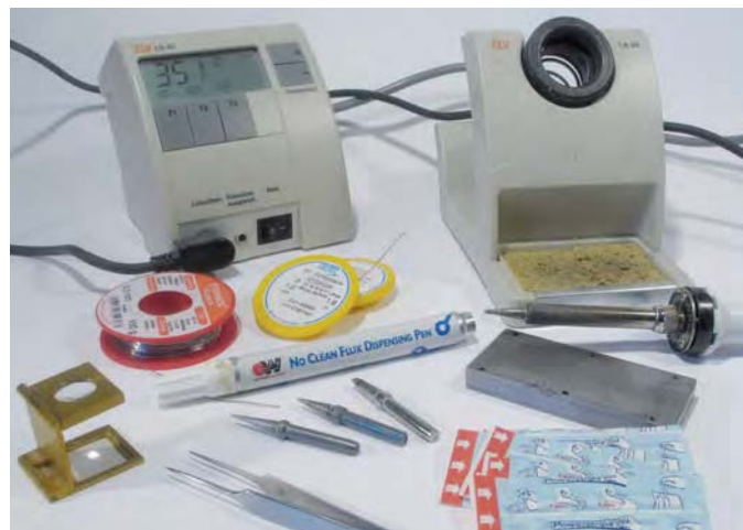
SMD-Werkzeug: Lötstation, verschiedene Lötspitzen, 0,5-mm-Lötzinn, Entlötlitze, Flussmittel-Stift, Pinzette, Lupe zur Kontrolle der Lötungen, Metallplatte als Gewicht und Klebepads zum Fixieren kleiner Platinen und einzelner Bauteile.
