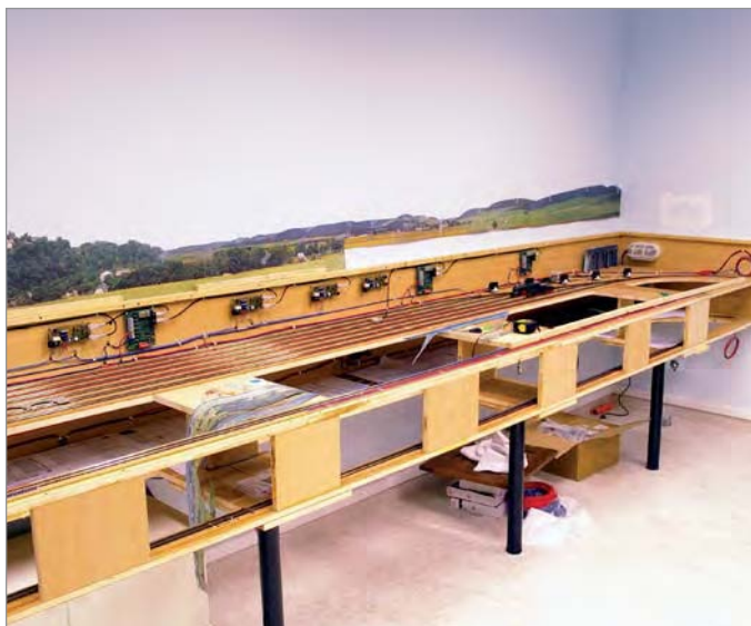
Eine Anlage mit Schattenbahnhof im Aufbau. Mit den Meldern und Weichen- bzw. Servo-Decodern sind gute Voraussetzungen für die Steuerung geschaffen. Hier kann z.B. eine Intellibox mit ihren Fahrstraßenfunktionen zum Einsatz kommen.
