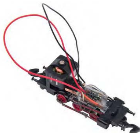
Wo bisher der Scheibenkondensator saß, ist nun der Decoder untergebracht. Der Motor ist bereits angeschlossen (orangefarbenes und graues Kabel), die Stromzuführung (rot und schwarz) ist für einen Test provisorisch hergestellt.
