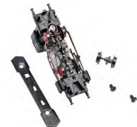
Bei der kleinen Lok sind alle Achsen angetrieben. Wie stark die Räder durch das Hohl-Achs-Konzept pendeln und sich seitlich verschieben können, wird am herausgenommenen mittleren Radsatz deutlich.
