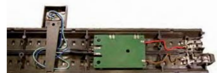
Die Platine ist für den Einbau in Märklin- und Trix-C-Gleisen vorbereitet, lässt sich aber auch in Rocos GeoLine unterbringen.
