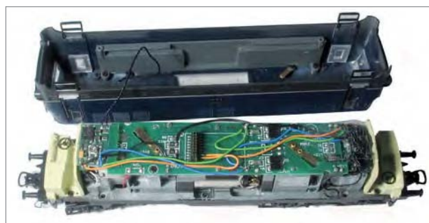
Die Lok mit Bremsfunken- (rechts) und Pantoblitz-Elektronik. Der Decoder ist noch nicht eingesetzt. So erkennt man, wo welche Kabel angeschlossen sind.
