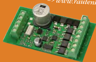
Der RMX910 ist ein vierfach-Schaltverstärker für Zubehördecoder.
