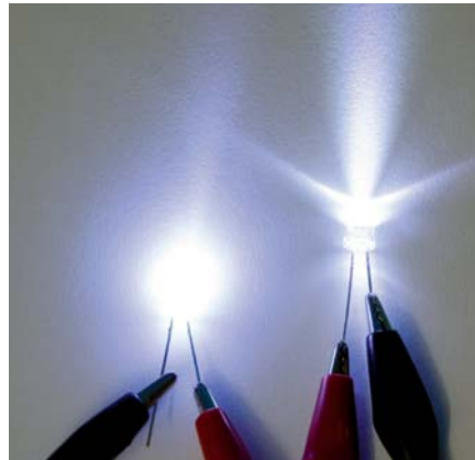
Strahlungsvergleich zwischen einer mattierten und einer original belassenen weißen LED (rechts).
