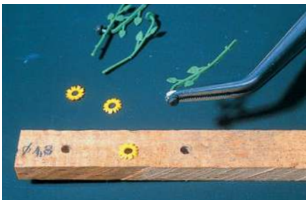
So sieht die Montagehilfe für den Zusammenbau von Buschs Sonnenblumen aus: Hartholz mit 1,8-mm-Löchern. Fotos: Bruno Kaiser
