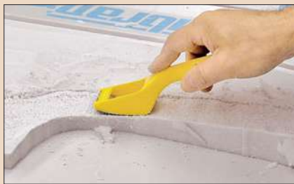
Das Gelände entstand weitgehend aus Styrodurplatten, die sich leicht bearbeiten lassen. Hier wird der spätere Feldweg mit einer Raspel geglättet.
