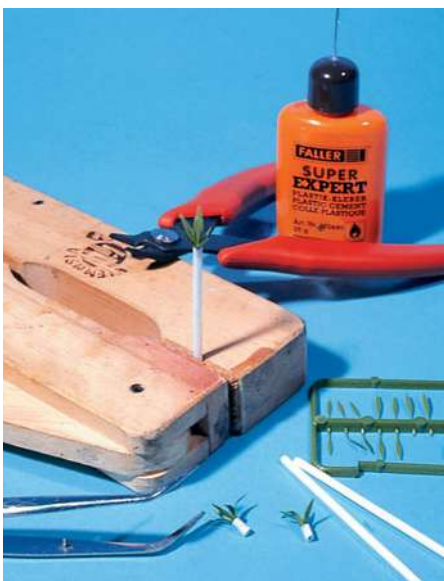
Einfache Wattestäbchen dienen als „Wurzelstock“ der Sporengewächse. Fotos: Bruno Kaiser
