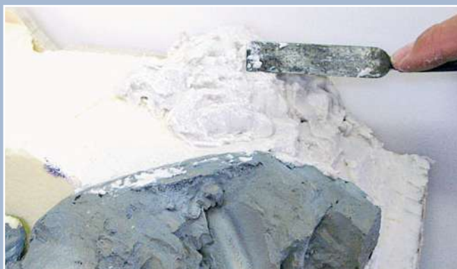
Mit dem hauseigenen Geländespachtel von Busch werden die Übergangsbereiche modelliert; auf diesen entsteht ein nahtloser Übergang zum übrigen Gelände.
