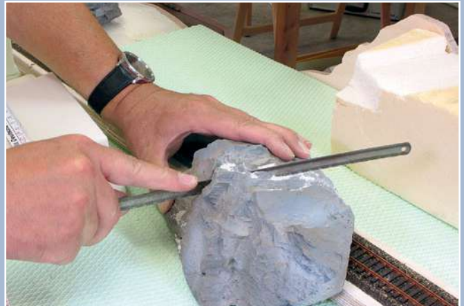
Die größeren Felsblöcke kann man auch zerteilen – mit einem Metallsägeblatt gelingt dieser Vorgang mühelos.
