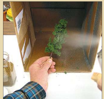
Eine alte Schachtel dient als Spritzbox für den klebenden Mattlackauftrag.
