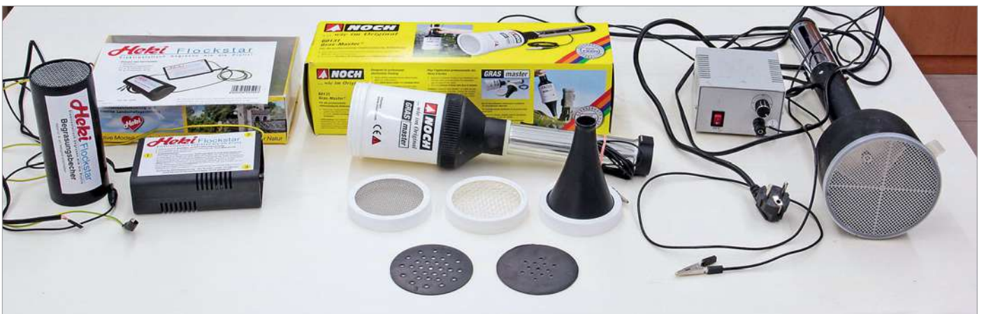
Die verwendeten Geräte im Überblick. Links der „Flockstar“ von Heki, in der Mitte der „Grasmaster“ von Noch. Als Referenz dient das Profigerät von Maag ganz rechts.
