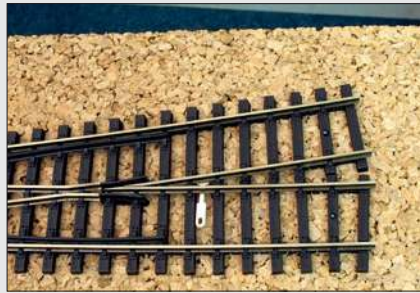
Das gerade verlaufende Gleis wird an das abzweigende Gleis herangedrückt. Dies bewirkt, dass der Bogen des folgenden Gleises bereits etwas vorher beginnt.
