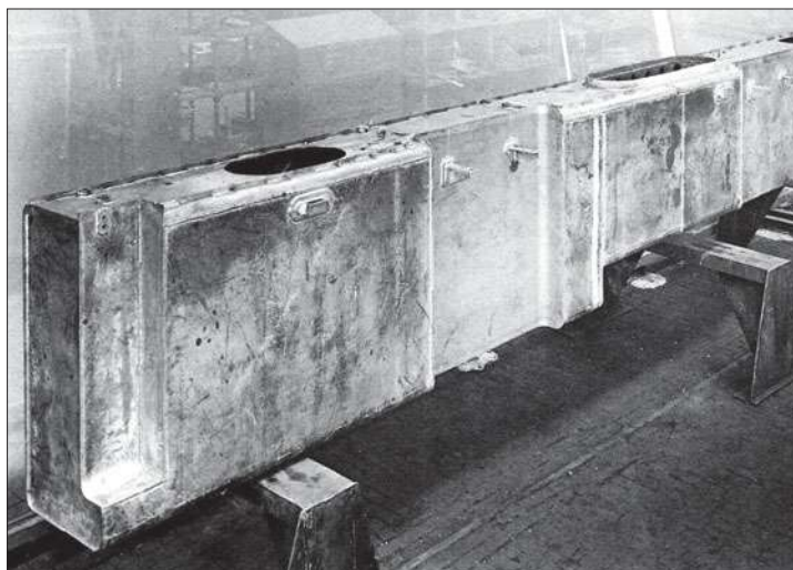
Vollständig geschweißter seitlicher Wasserkasten für die Lokomotiven der Baureihe 65 mit seiner komplizierten Form.
