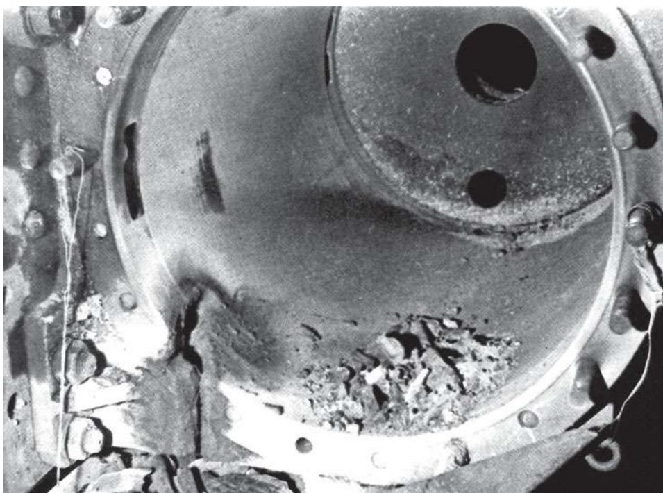
Riss am rechten Zylinderblock einer preußischen T 14 1 .
