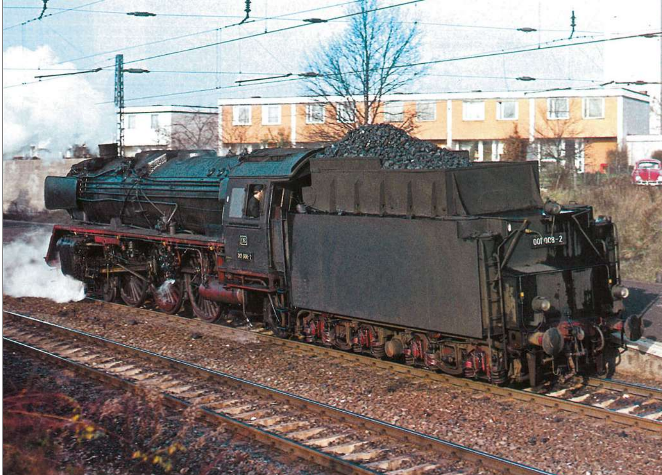
Einheitstender 2'2'T 34 der 001 008-2. Man beachte den Kohlenkastenaufsatz. Die Kohlen wurden möglichst weit vorne geladen, um dem Heizer die Arbeit zu erleichtern.
