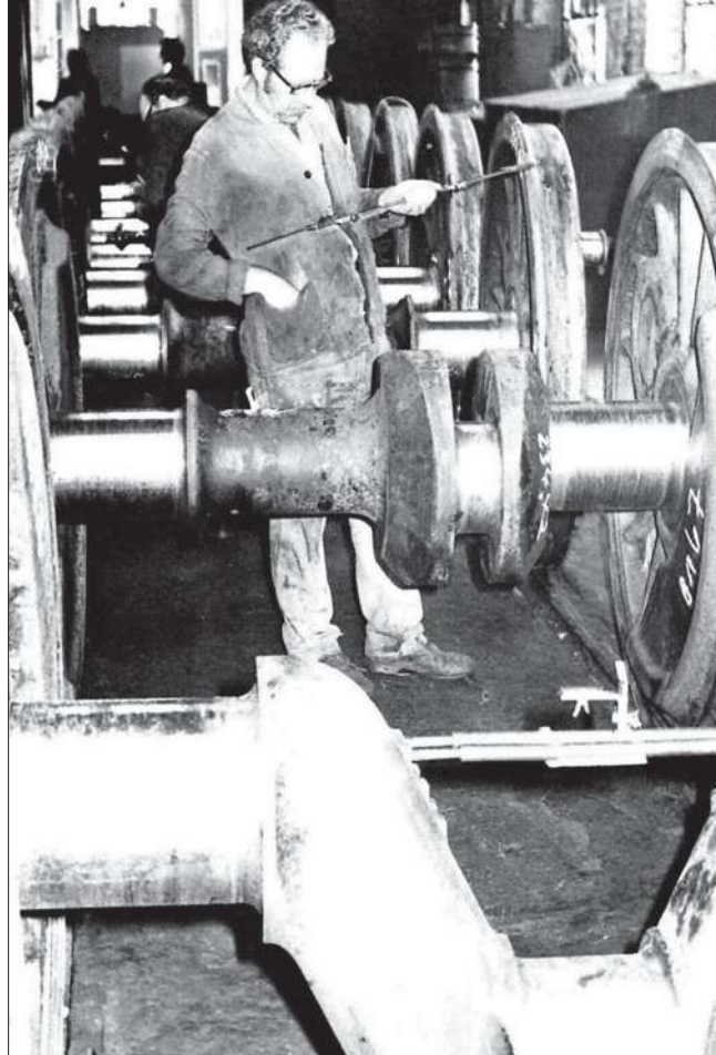
Radsatzgruppe einer Lok der BR 44. Im Vordergrund die Treibachse mit Kropfachswelle, dahinter die Achse mit der Kröpfung für den Hubscheibenantrieb der Steuerung des mittleren Zylinders. Gut erkennbar sind auch die polierten Laufbunde an den Achsschenkeln.
