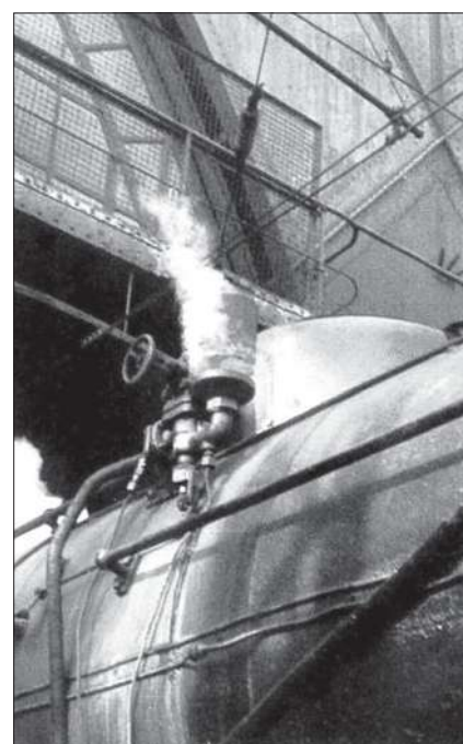
Auch bei Schnellzuglokomotiven befindet sich die Pfeife unmittelbar am Dom.
