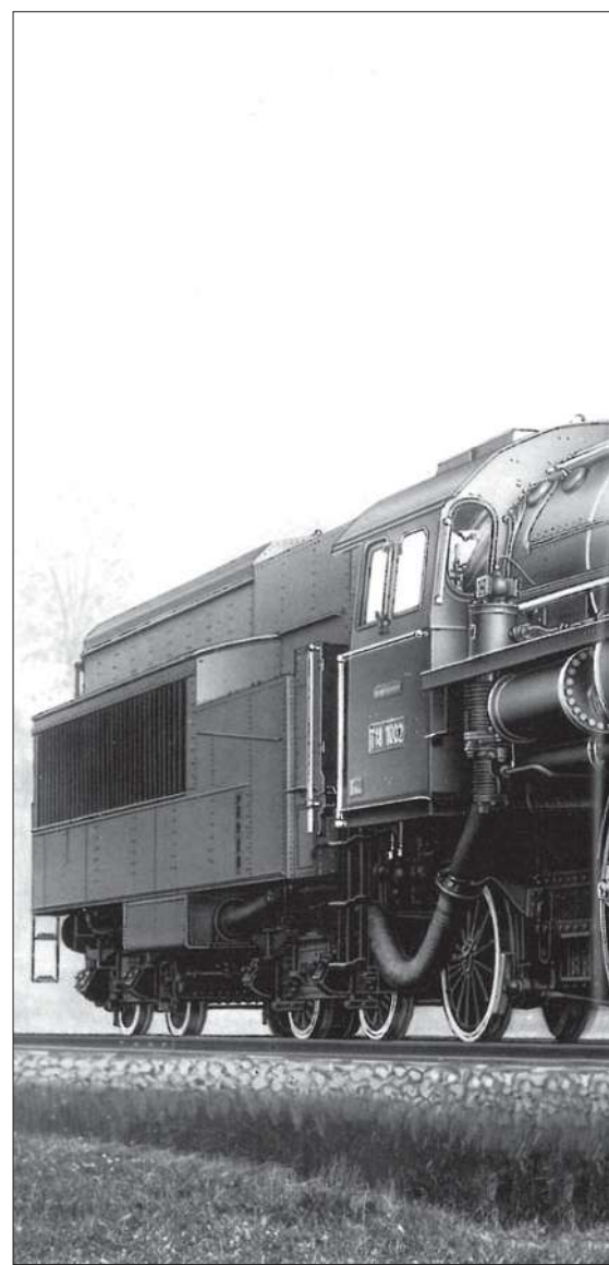
Eine der seltenen Zugaufnahmen der Turbinenlokomotive T 18 1001, Bauart Krupp-Zoelly (Krupp 592/1923), nach dem ersten Umbau mit parabolischer Rauchkammertür und ohne Seitenverkleidung im Bereich der Oberflächenkondensatoren.
