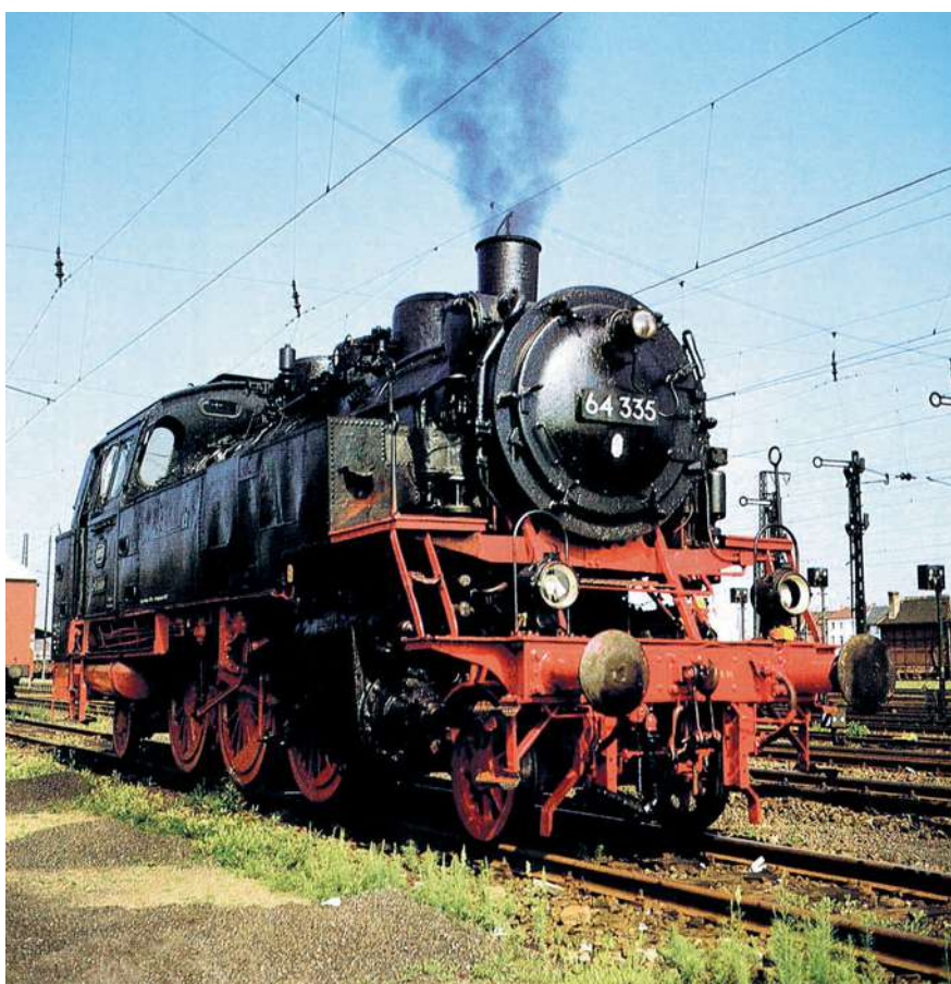
Bei dieser Aufnahme der 64 335 erkennt man die seitliche Lage der Pfeife am Dampfdom.
