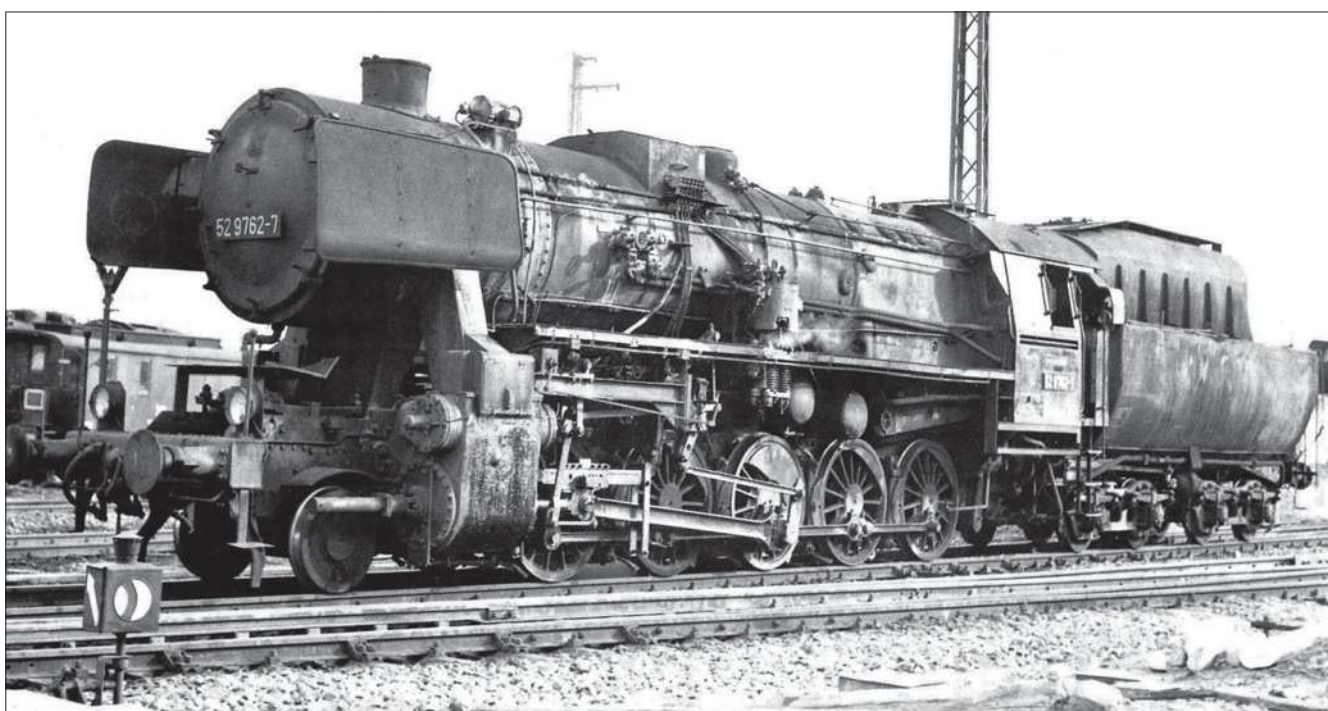
Die kohlenstaubgefeuerte 52 9762 von der Heizerseite.
