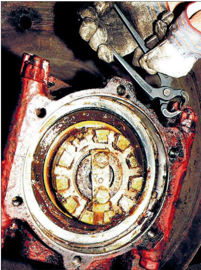
Hat man den Deckel des Achslagergehäuses abgenommen, so sieht man das Tenderrollenlager (siehe auch Zeichnung S. 215 Mitte).
