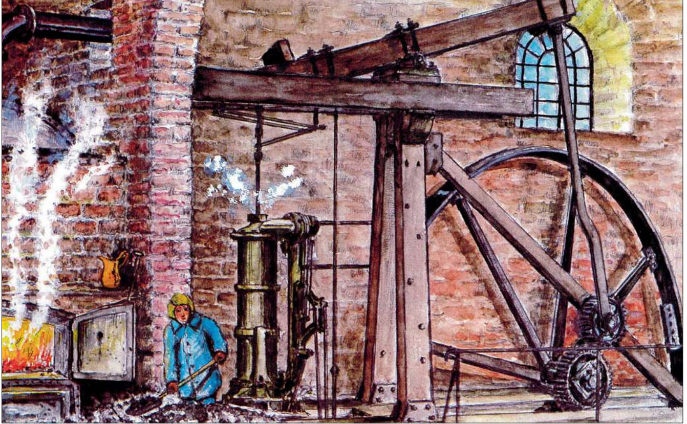
Erste Niederdruck-Dampfmaschine mit Drehmomentübertragung von James Watt etwa um 1770. Der Kolben setzte bereits ein Rad in Bewegung.
