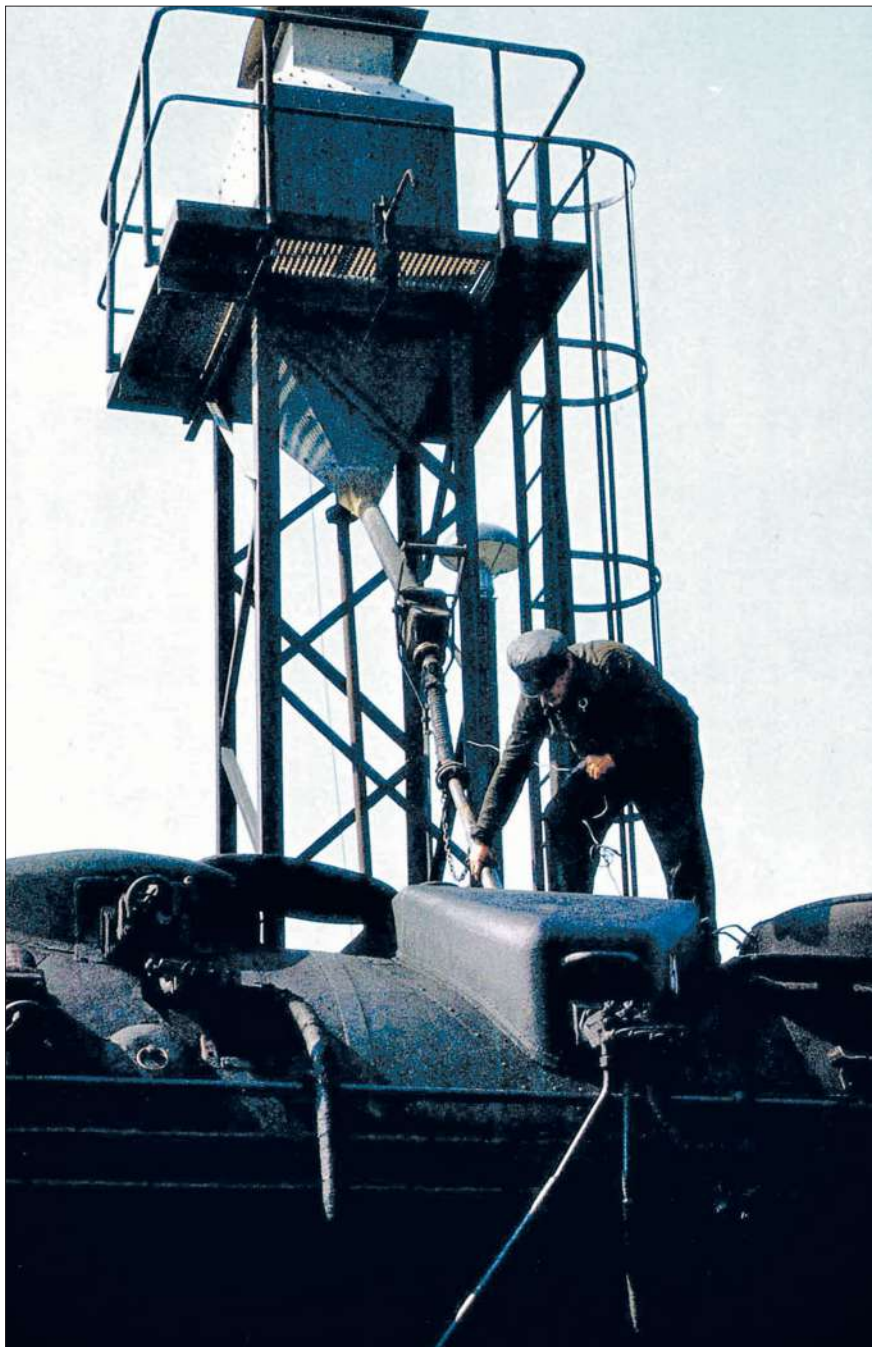
Vom Sandbehälter fällt der Sand durch die Schwerkraft in den Sandkasten auf dem Langkesselscheitel. Dort wird er durch Wärme trocken gehalten.
