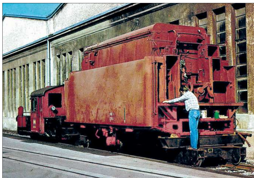
Rahmen, Wasser- und Ölkasten des Tenders 2'2'T 34 der 41 018 sind wieder instandgesetzt und ruhen auf provisorischen Drehgestellen (Oktober 1985).
