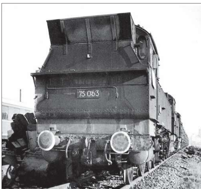
Hölzerner Kohlenkastenaufsatz an einer württembergischen T 5 in Feldkirchen am 4. Januar 1965.
