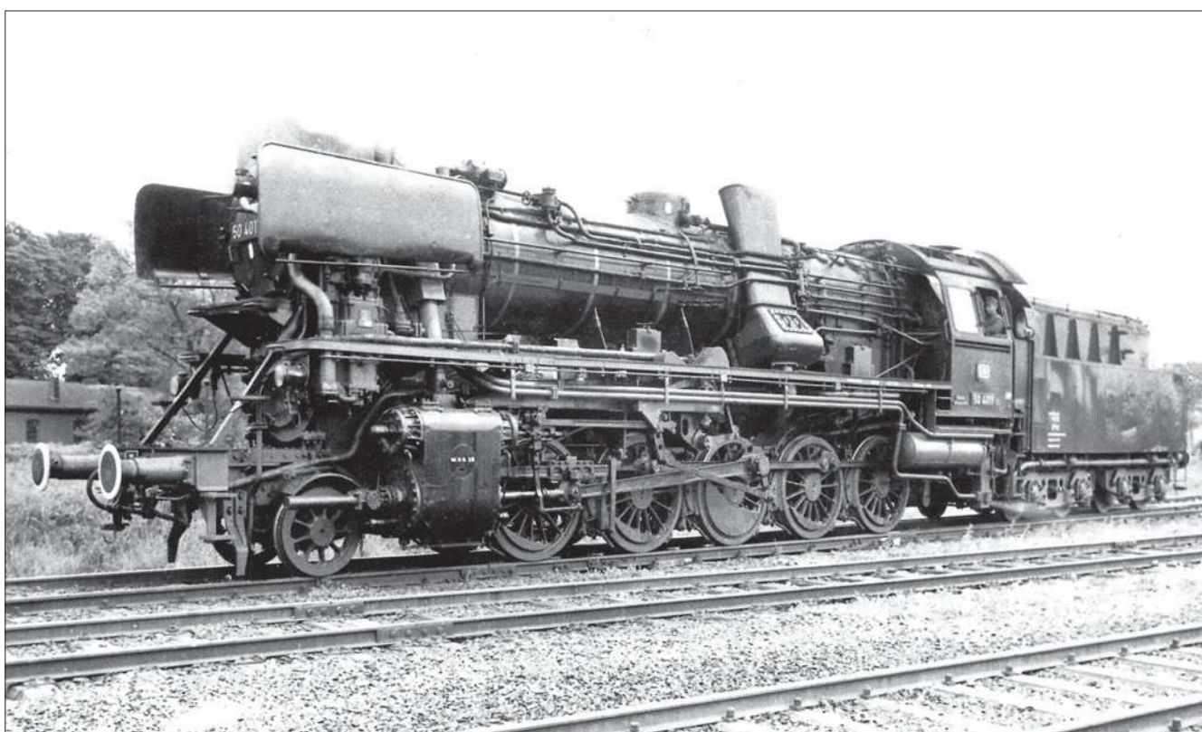
Die 50 4011 war die einzige Franco-Crosti-Lokomotive mit Ölhauptfeuerung.
