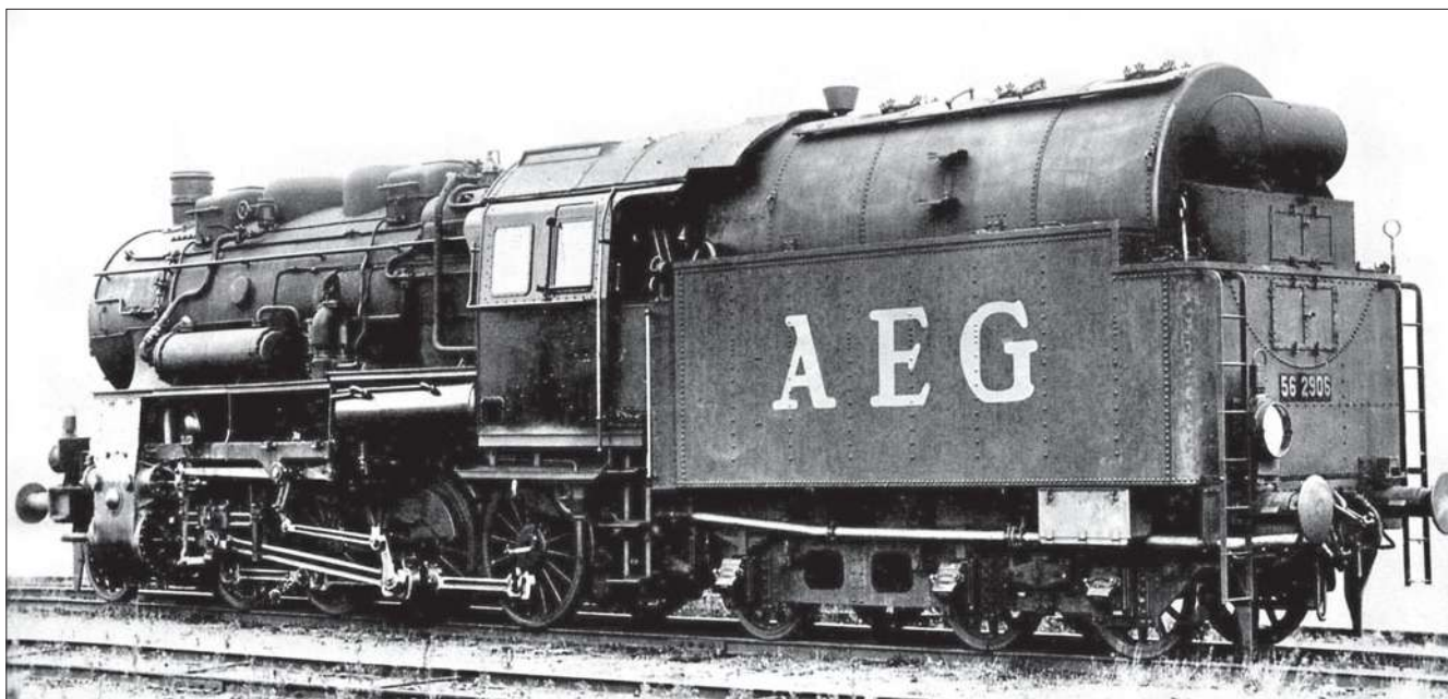
Erste Version des AEG-Kohlenstaubtenders mit rückwärts angebrachtem Leuchtgaskessel.
