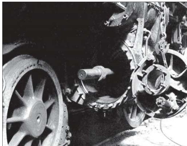
Bei der Lokomotive 23 105 wurde der Zylinderdeckel abgeschraubt und mittels Flaschenzug abgesetzt. Die Aufnahme lässt die Kolbenstangendichtungssegmente sowie das Zylindersicherheitsventil am Kolbendeckel erkennen.
