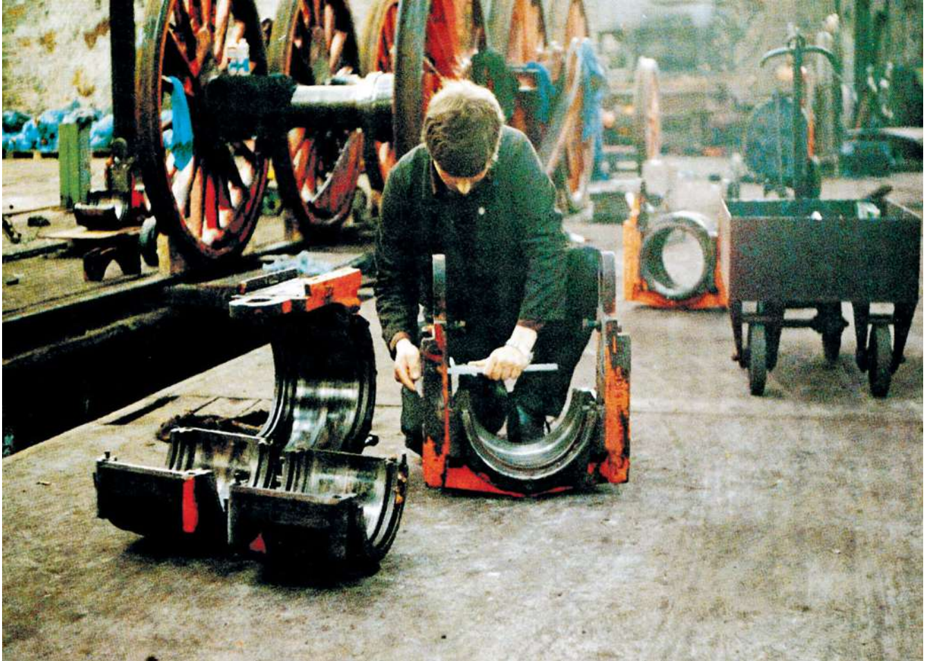
Vermessen des Achslagergehäuses.
