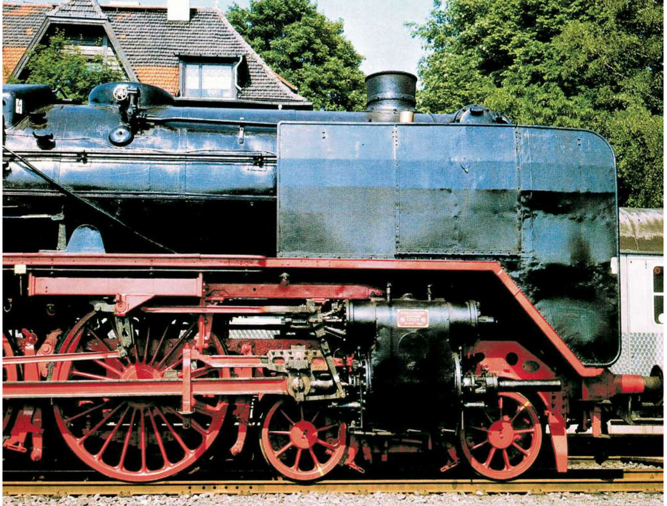
Lokomotive der Baureihe 01 noch weitgehend in der Ursprungsausführung mit Wagner-Windleitblechen, jedoch mit vom Raw Meiningen gefertigten Ersatzzylindern in Stahl-Schweißkonstruktion (01 118 in Königstein/Taunus am 30.0 Mai 1982).
