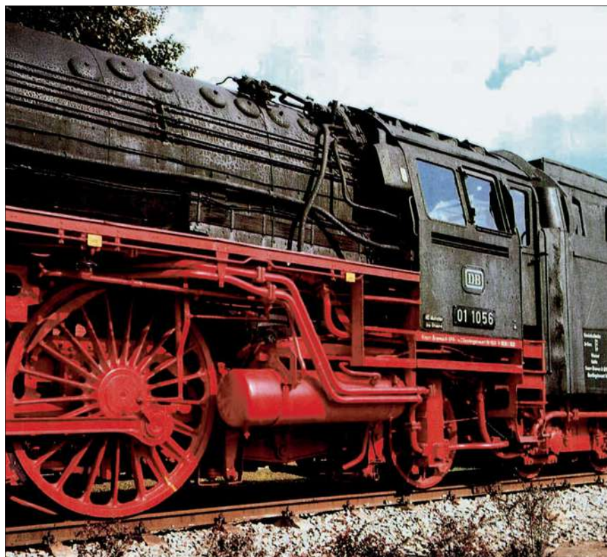
Die 01 1056 als Denkmal in Rheine. Gut erkennbar die Verkleidungen der Waschluken bei modernen Kesseln. Vor dem Führerhaus befindet sich der Dampfentnahmestutzen (siehe auch nächste Seite).
