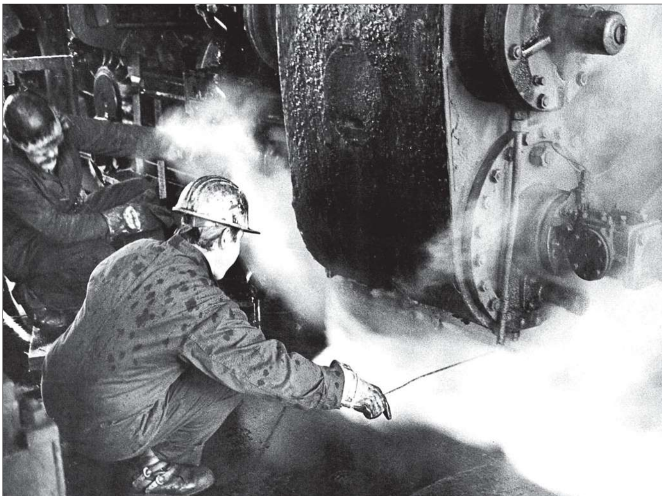
Die Nockenstangeneinstellung wird überprüft.
