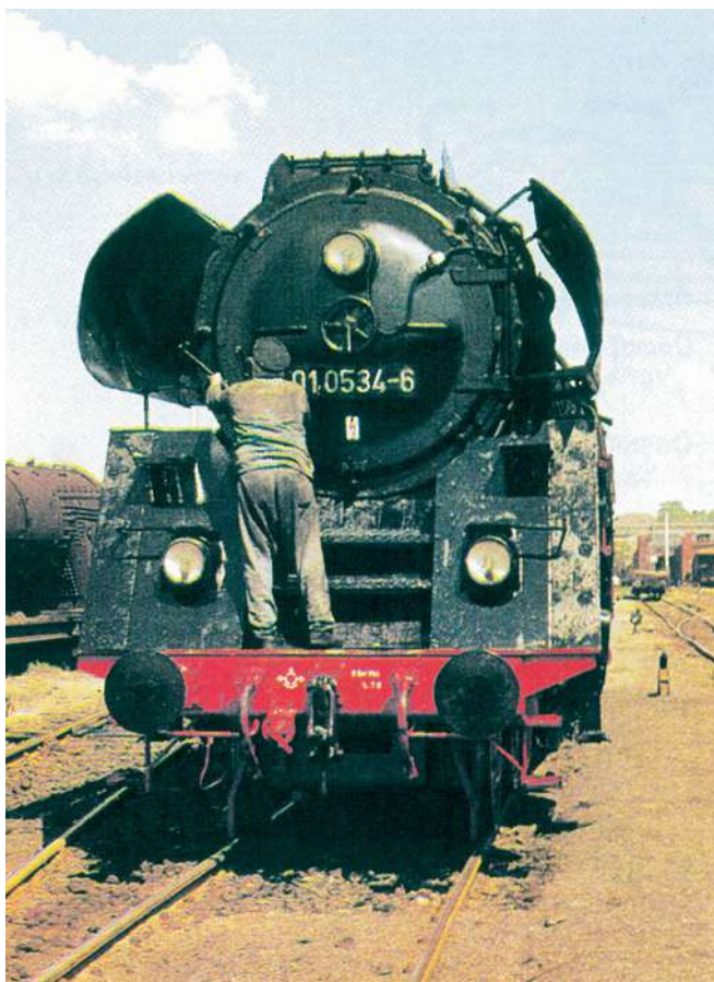
Beim Öffnen der Rauchkammer wird folgendermaßen vorgegangen: a) Aufschlagen des Vorreibers ...
