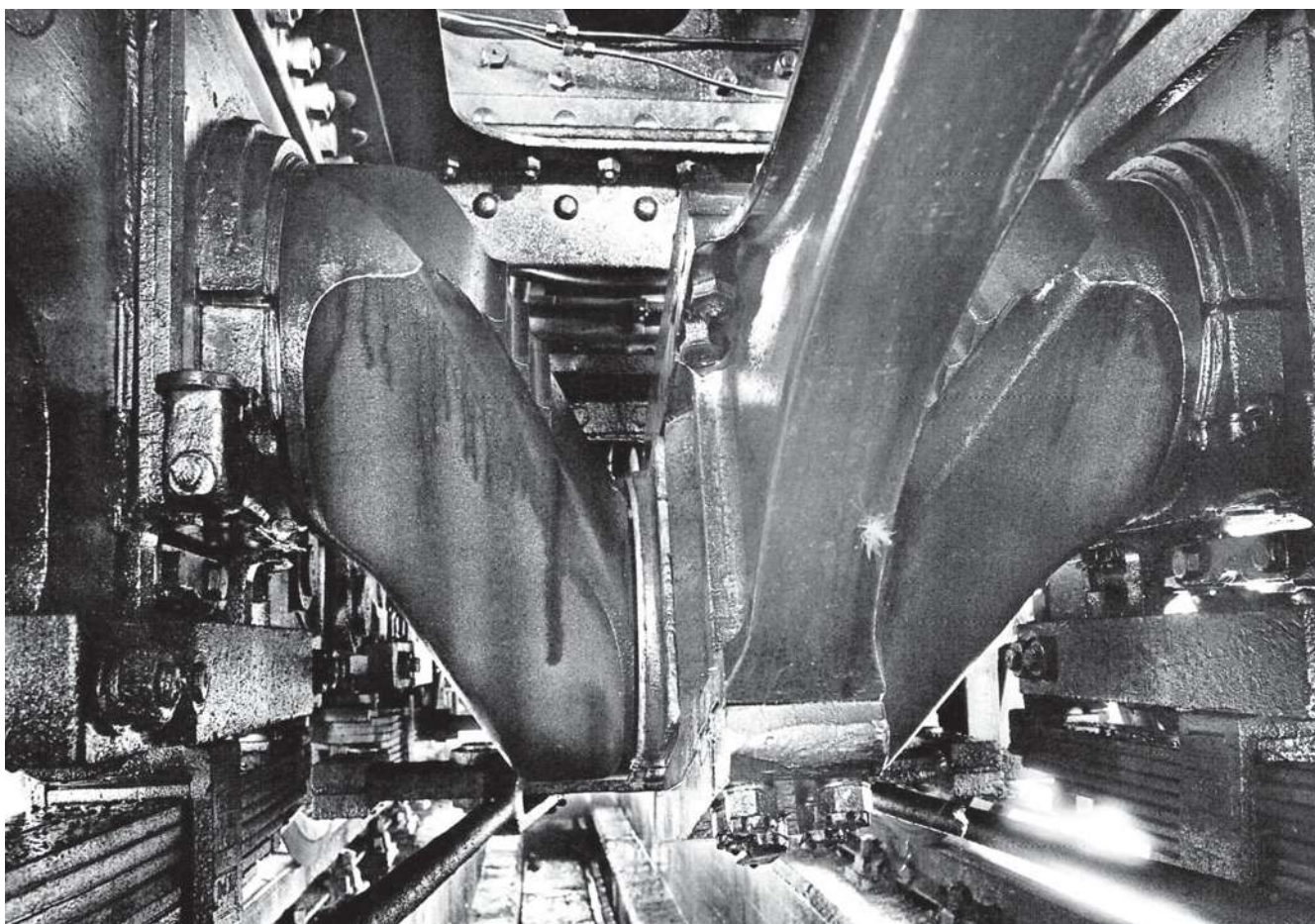
Kropfachse mit Treibstange des Innenzylinders. Ausgezeichnet erkennbar auch die Verschraubung des Schnallenkopfes des hinteren Treibstangenlagers.
