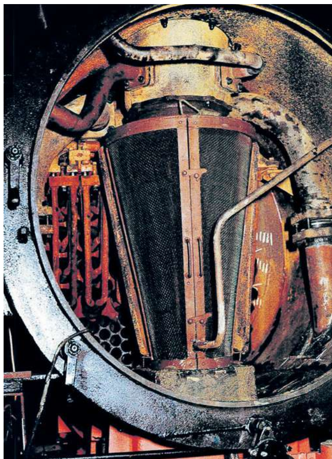
Rauchkammer einer Heißdampf-Schmalspurlokomotive mit dem aufklappbaren Funkenfänger der Bauart Holzapfel.
