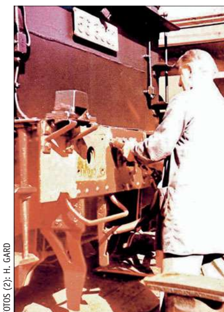
Zughakenlagerung beim Tender mit Drehgestellen.
