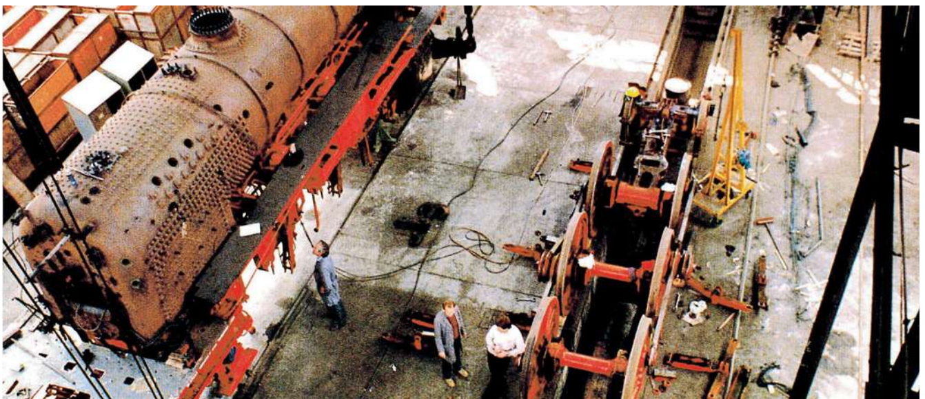
Rahmen und Kessel der 23 105 werden zum Aufachsen angehoben. Rechts steht der aufgearbeitete Radsatz.
