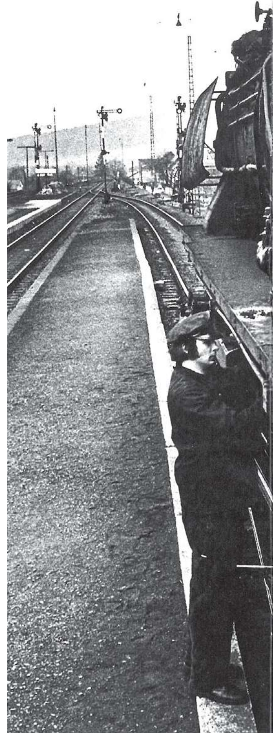
Von der Hochdruckschmierpumpe Bauart Bosch führen die Ölleitungen am Kessel entlang zu den verschiedenen Schmierstellen. (Bodenfelde, 26. März 1976).
