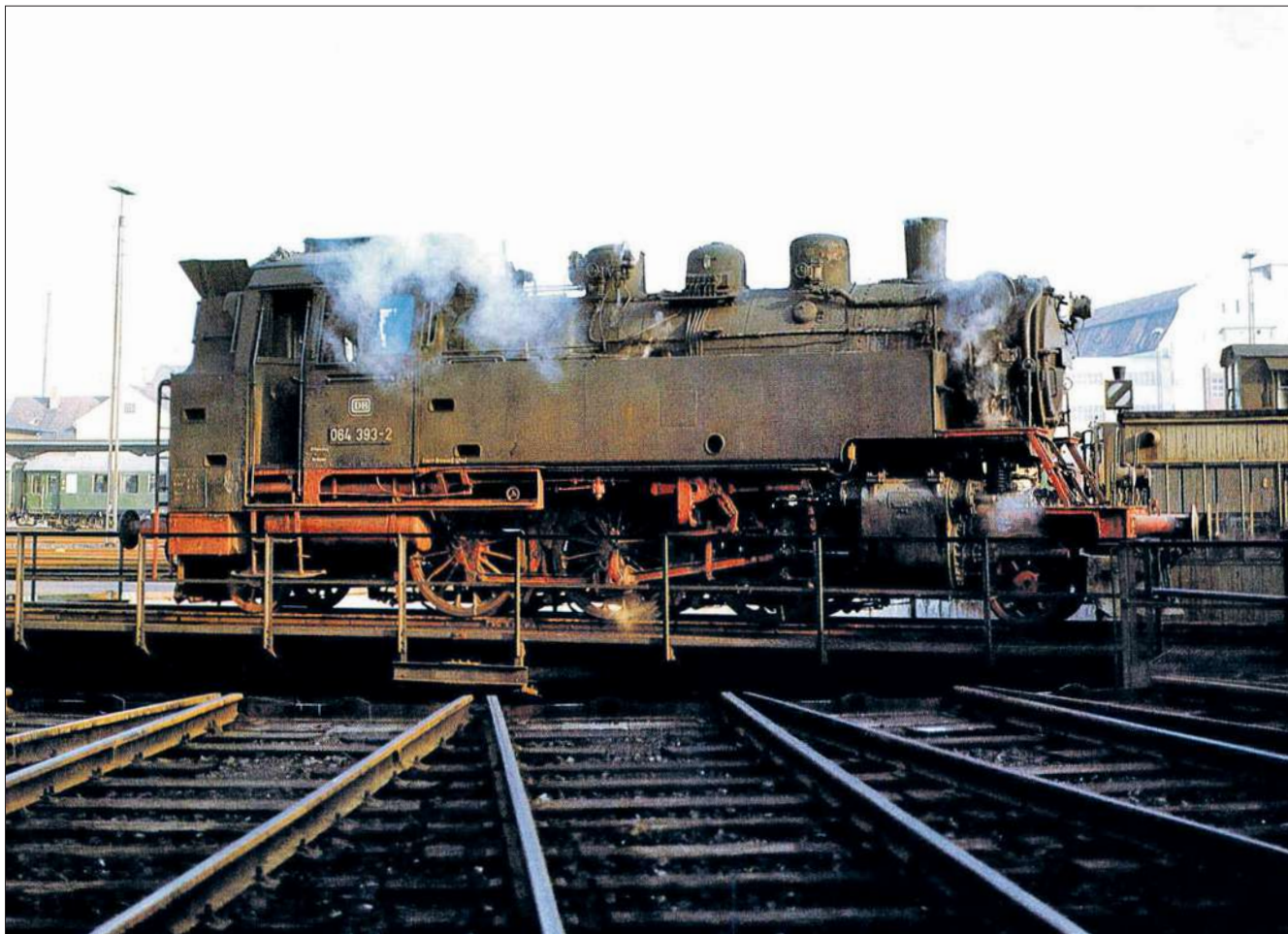
Bei 64 393 ist die am letzten Dom angebrachte Pfeife gerade in Betrieb, wie man gut am Dampfausstoß erkennt.
