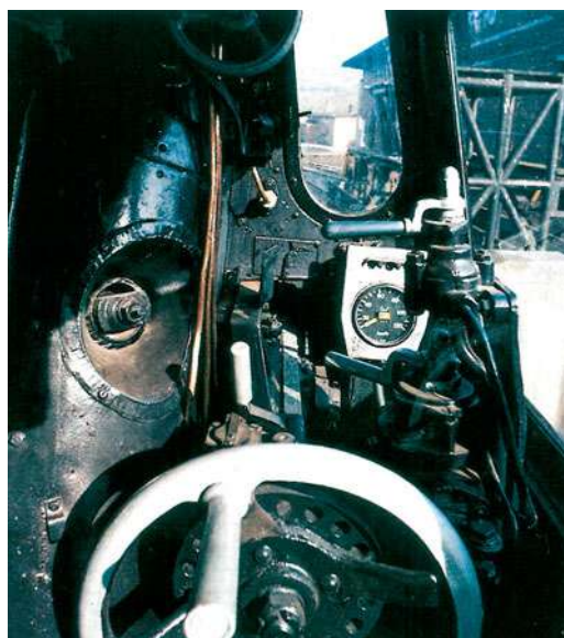
Im Führerstand einer Dampflok: Handräder, Druckmesser, Wasserstandsanzeiger, Pyrometer etc. etc.... (044 389-5 DenkmalloK in Altenbeken, 1977).
