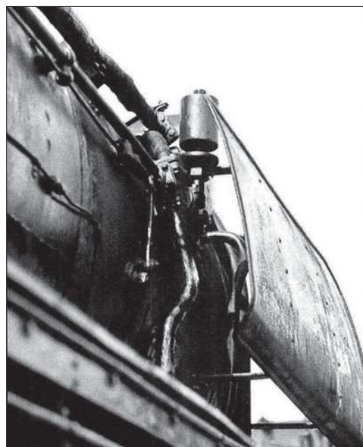
Bei Loks der Baureihe 03 saß die Dampfpfeife etwas unter dem Scheitelpunkt des Kessels.
