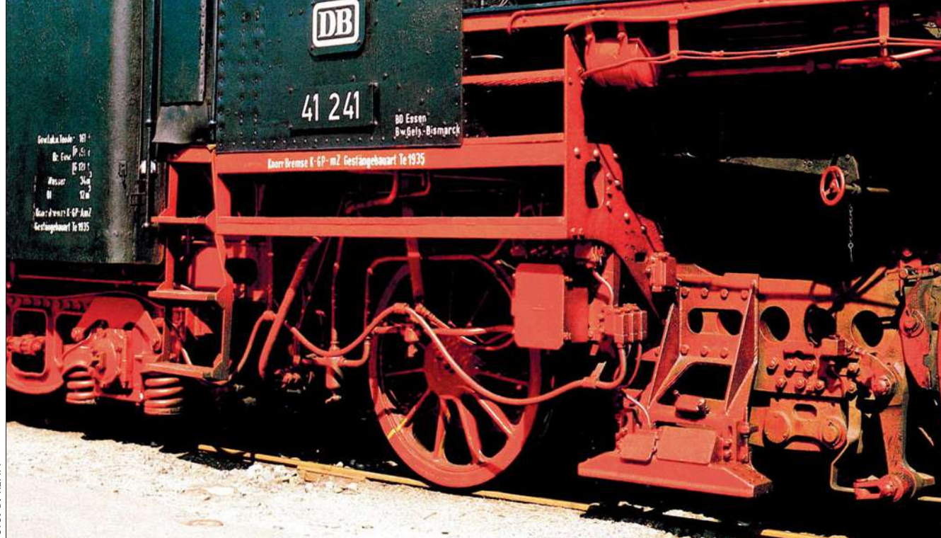
Führerstand und Indusi-Magnet an der 41 241. Man beachte die verschiedenen Leitungen; sie sind zum leichteren Ein- und Ausbau der Teile mit Steckern versehen.
