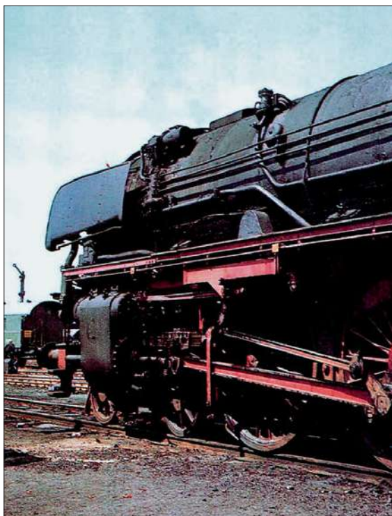
Neubaukessel einer 01; hinter dem Windleitblech befindet sich die Mischvorwärmerspump Bauart Hehl MV 57.
