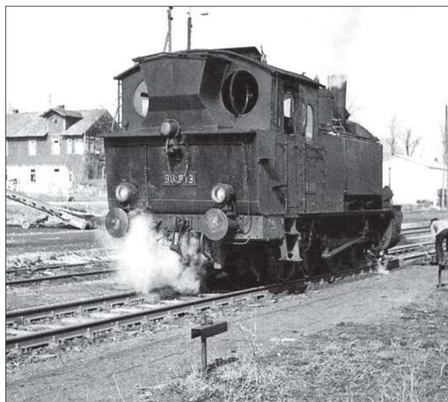
Eiserner Kohlenkastenaufbau bei einer GtL 4/4 (nachträglich angebaut, da diese Serie ursprünglich nicht damit ausgerüstet war). Die 98 813 in Königshofen 1965.
