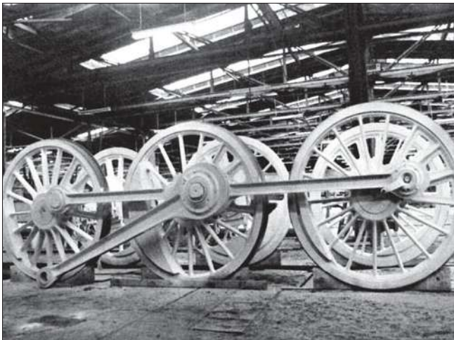
Treibradsatz mit Kuppel- und Triebstange mit Wälzlager der 23105.
