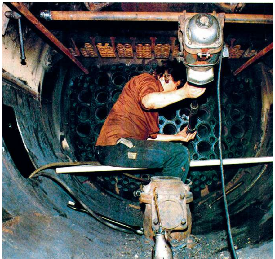
Einwalzen der Rauch- und Heizrohre in die Rauchkammerrohrwand.
