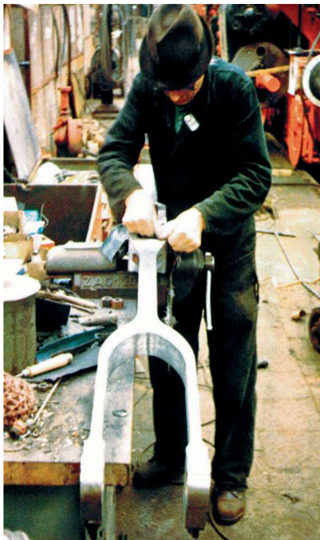
Schieberschubstange der 23 105 bei der Aufarbeitung.
