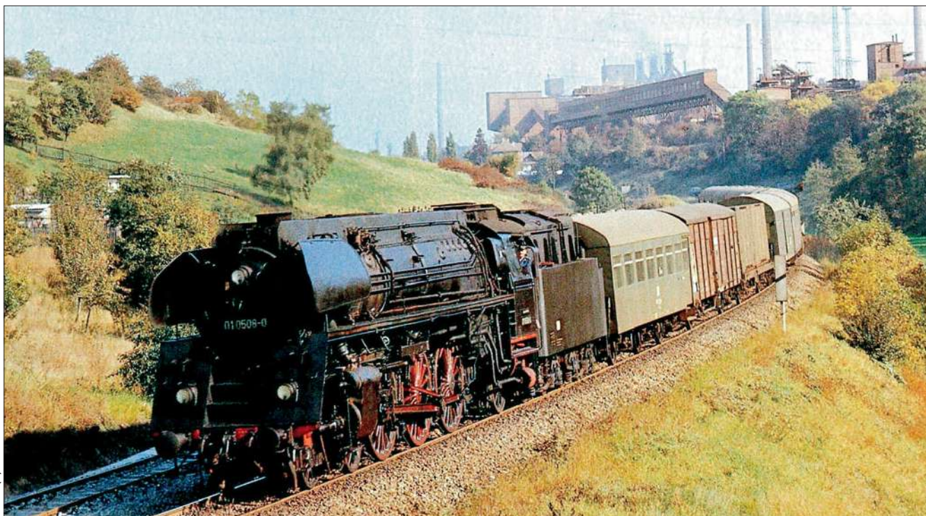
28 der 35 Lokomotiven der Baureihe 01 5 verfügten über eine Ölhauptfeuerung. Das Foto zeigt die 01 0508 des Bw Saalfeld bei Unterwellenborn.
