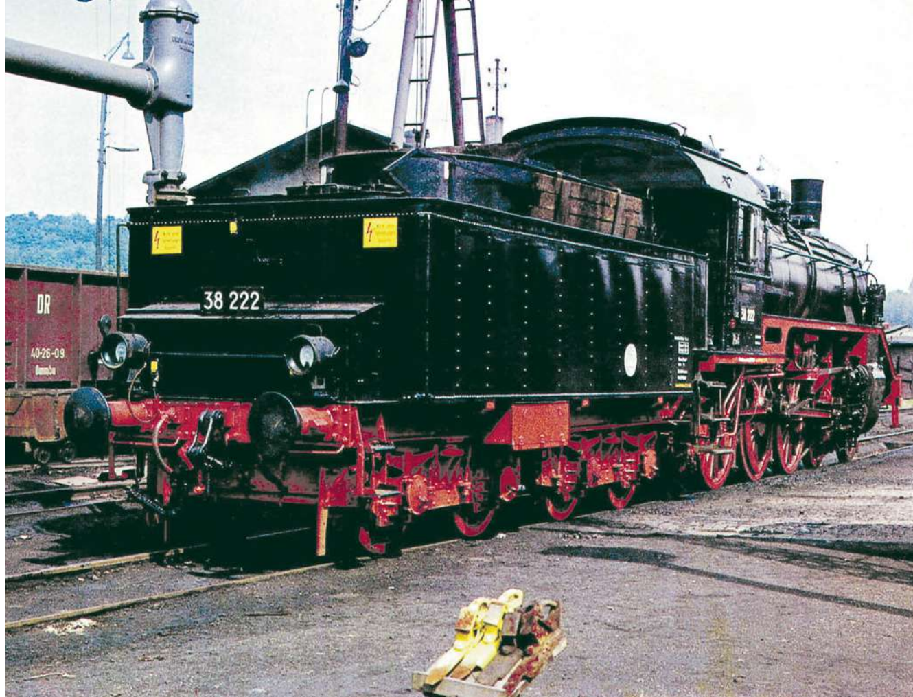
Die 38 222 ist eine ehemalige sächs. XII H2, hier mit einem Tender 2'2'T 21 gekuppelt (7 t Kohle).
