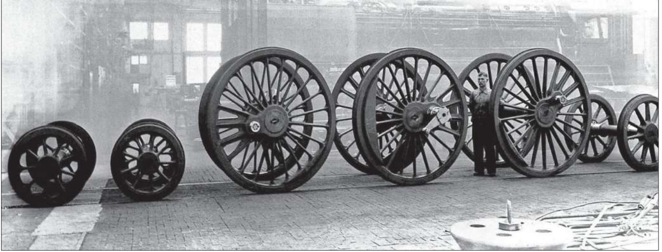
Filigrane Radsatzgruppe einer Drillings-Schnellzuglokomotive der Baureihe 03.10. An der Stellung der Gegengewichte in den Radsternen erkennt man den Zweiachs-antrieb. Im Vergleich zu dem Werkarbeiter sind die Kuppelradsätze mit ihrem Durchmesser von 2000 mm eine recht imposante Konstruktion.
