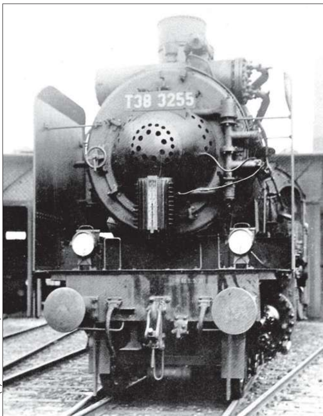
Die T38 3255 (Henschel 20444/1925) nach dem Umbau mit parabolischer Rauchkammertür und zu Messzwecken angebrachtem Rauchkammer-Unterdruckmesser.
