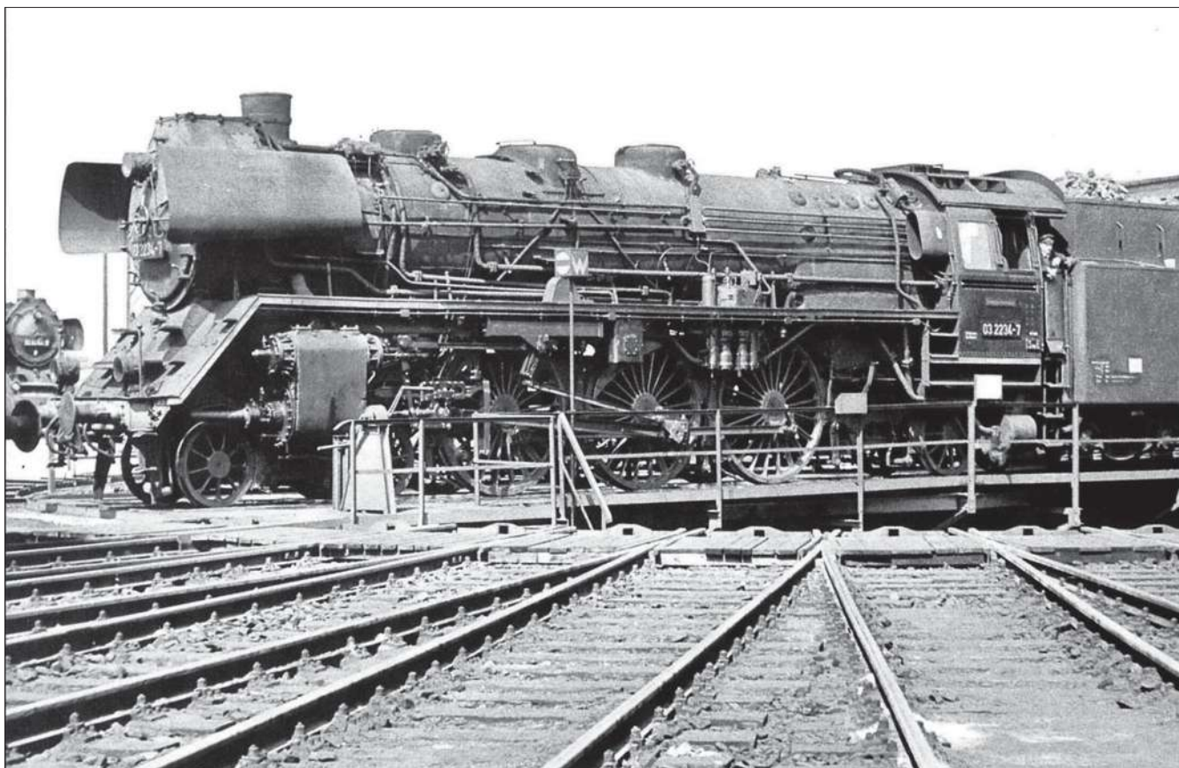
Lok der Baureihe 03 der Deutschen Reichsbahn mit Altbaukessel und Mischvorwärmer der Bauart IfS. Im Laufblech an einem besonderen Pumpenträger die Mischvorwärmerpumpe VMP 15-20.
