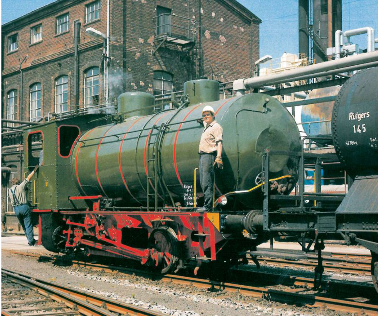
Zweifach gekuppelte Dampfspeicherlokomotive mit hinten angeordneten Zylindern, Sandkasten auf dem vorderen und Dampfdom auf dem hinteren Teil des Kessels.
