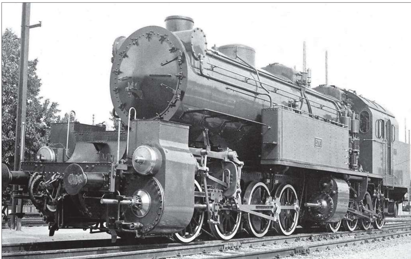
Die größte Tenderlokomotive Deutschlands war die bay. Gt 2 x 4/4 (spätere Baureihe 96) mit Vierzylinder-Verbundtriebwerk in der Bauart Mallet. Diese Lokomotiven hatten von allen deutschen Dampflokomotiven die meisten Kuppelradsätze.
