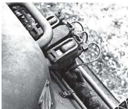
Detail der Sandtreppe an einer Lok der Baureihe 45 (von oben gesehen).
