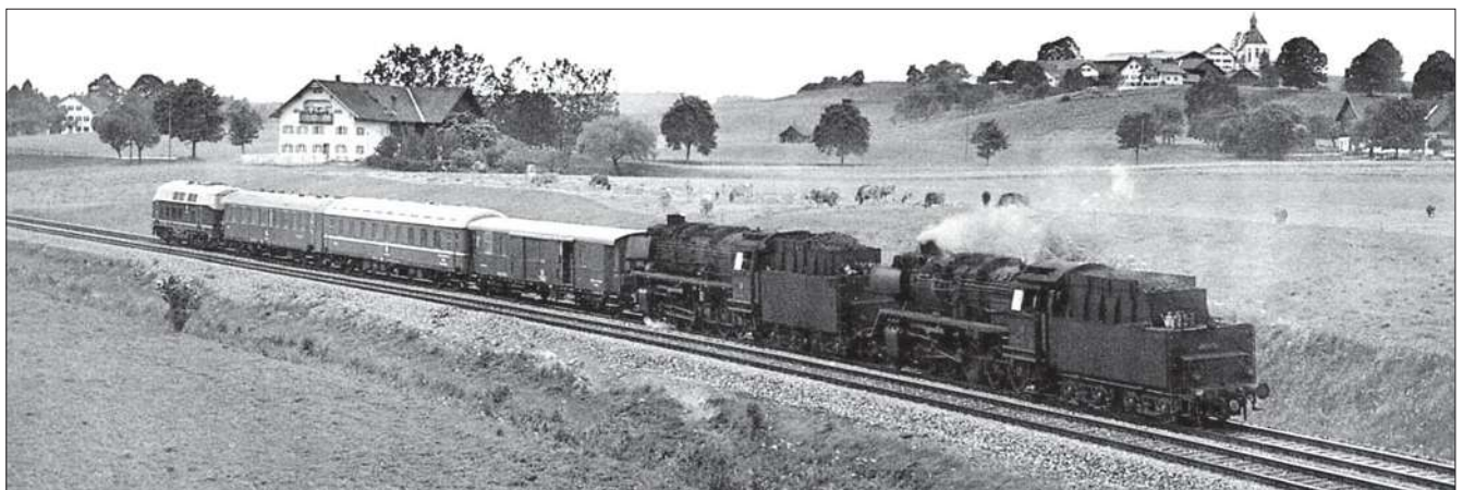
Beharrungsmessfahrt für die Diesellok 218 302 auf der Strecke München – Kempten bei Aitrang. Als Bremslokomotiven dienen die 44 197 und die 50975.
