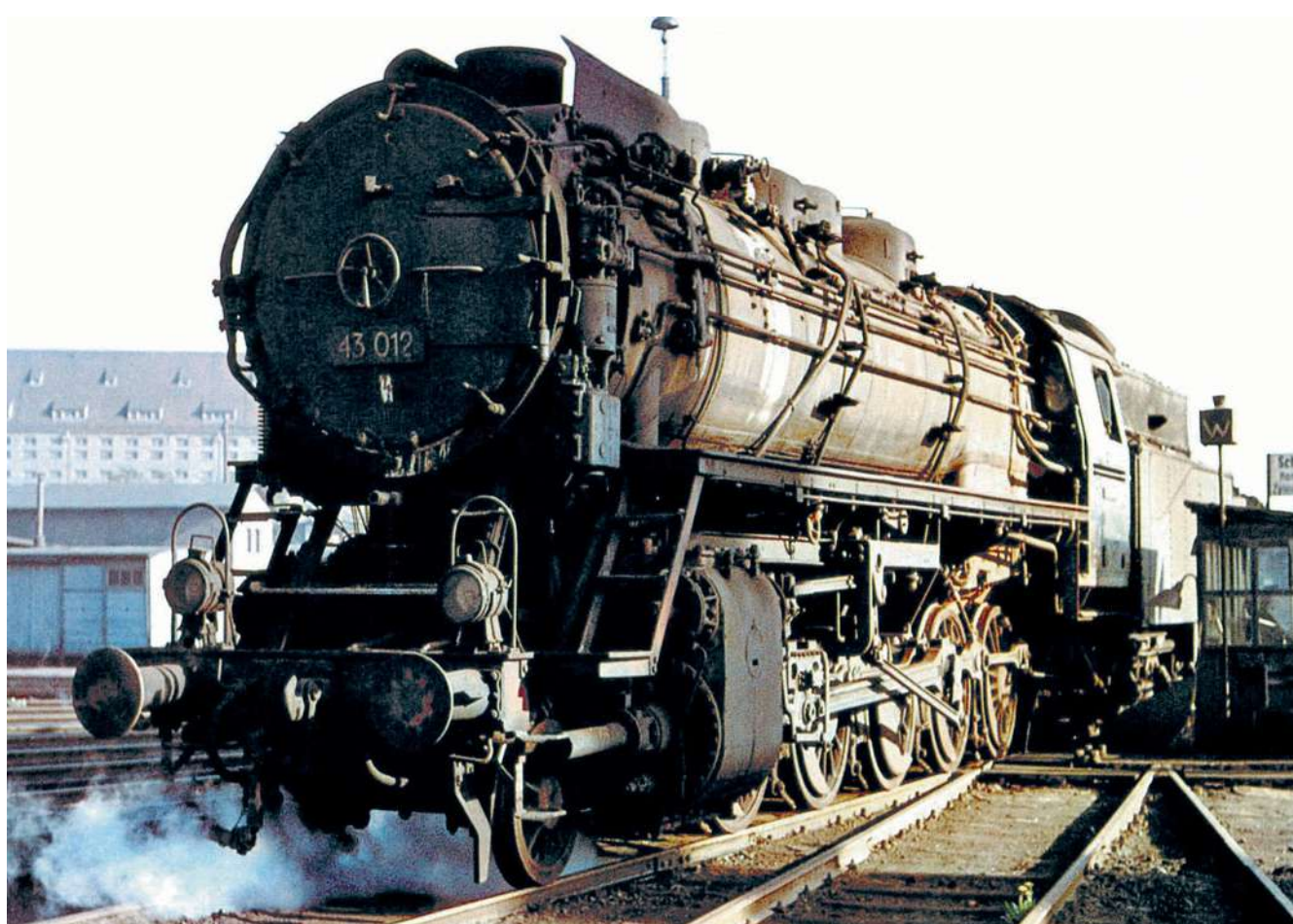
An der 43 012 der DR hatte man ganz kleine Windleitbleche als Rauchleiteinrichtungen ausprobiert.
