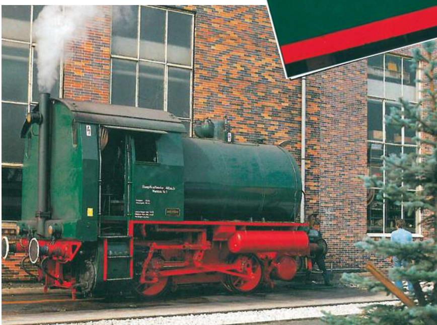
Lok 1 der Dampfkraftwerke Altbach mit Druckluftbremseinrichtung.
