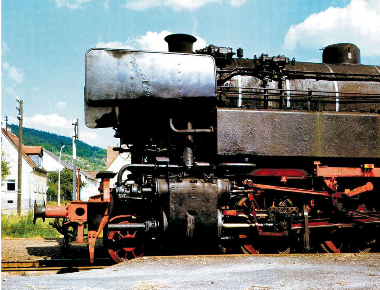
Zylinderblock und Kreuzkopf der DB-Baureihe 65 sind gegenüber den Bauteilen der Einheitslokomotiven fast unverändert, obwohl zwischen der Einheitslokomotive und der neueren DB-Maschine rund 25 Jahre Entwicklungszeit liegen. Die Aufnahme entstand in Kleinwallstadt im Juli 1972.
