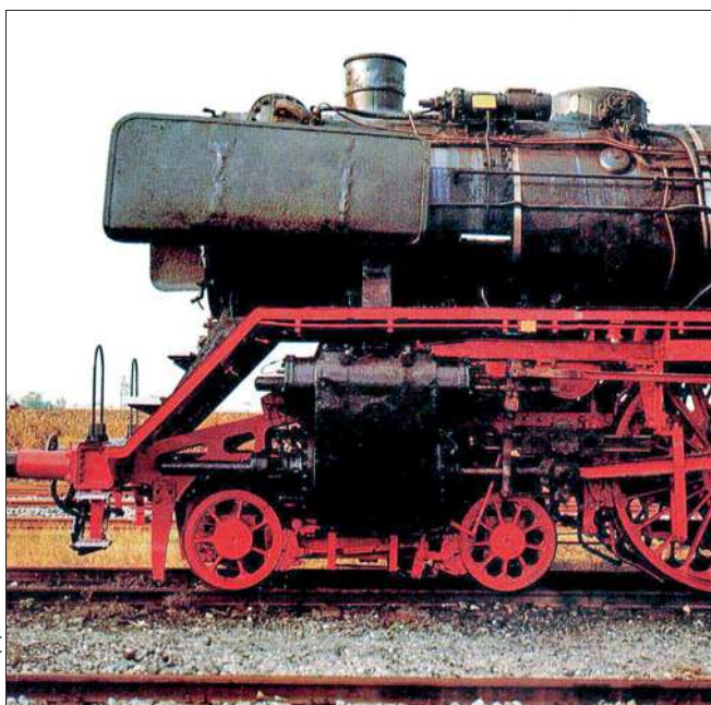
Ansicht des auf der Rauchkammer quer eingebauten Vorwärmers an einer Einheitslok der Baureihe 03.
