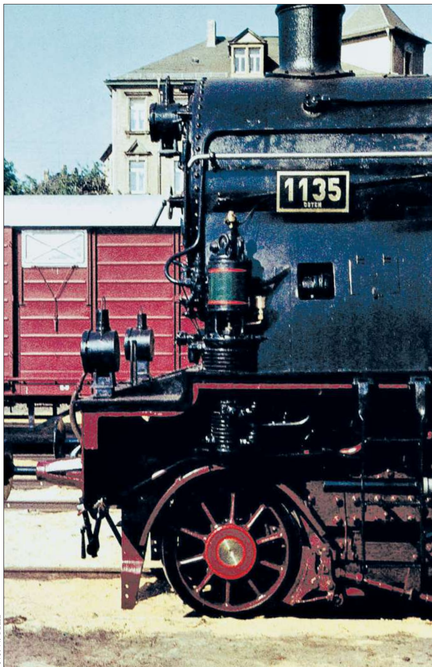
Zweistufige Luftpumpe (hier linksseitig angeordnet) an der pr. S 10 1 -Museumslokomotive der Deutschen Reichsbahn, aufgenommen im August 1971 in Dresden-Radebeul.
