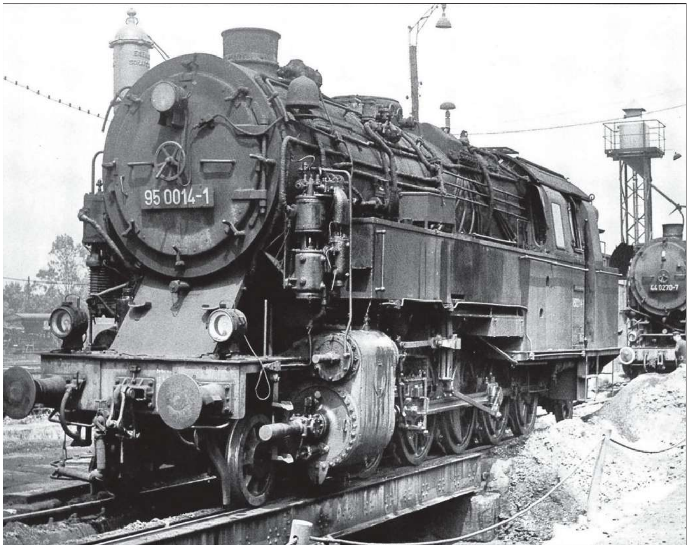
Die 95 0014 (pr. T 20) hat noch die alte Kolbenspeisepumpe der Bauart Knorr mit Schleppschiebersteuerung (links neben der Rauchkammer). An der linken Seite der Rauchkammer ist das Druckluftläutewerk der Bauart Knorr angebracht.
