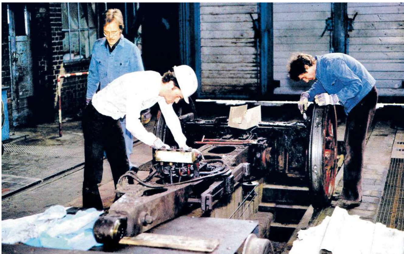
Die Eisenbahnfreunde der „IG 41 018“ mussten das Krauss-Helmholtz-Drehgestell ihrer Lok komplett ausbauen und instandsetzen, ehe sie wieder fahrtüchtig war.
