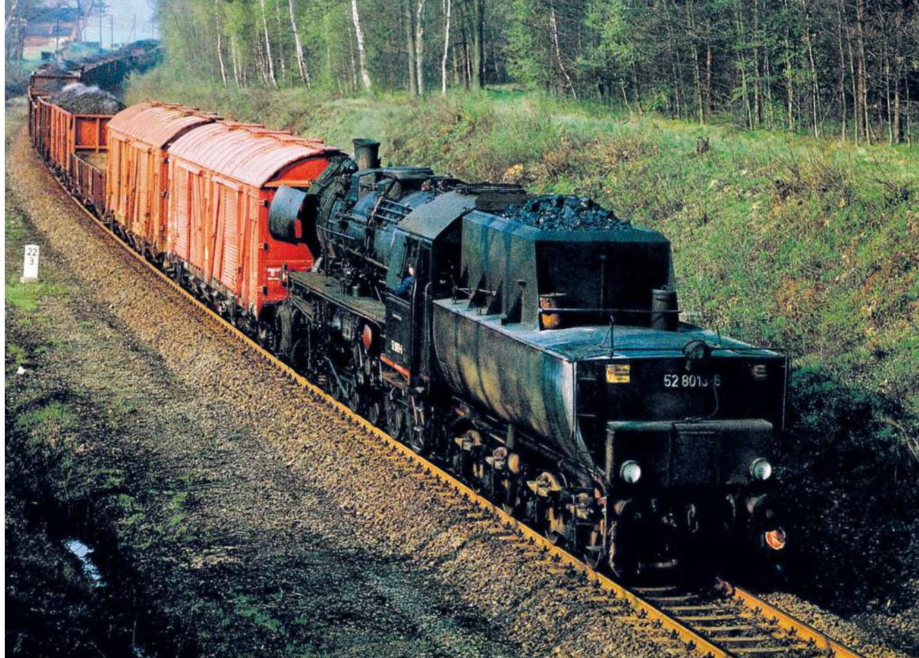
Aus den mit Kesselwagen gesammelten Erfahrungen entstanden die rahmenlosen Wannentender. Reko-Lok 52 8013-6 bei Gersdorf-Mörsdorf (8. Mai 1980).
