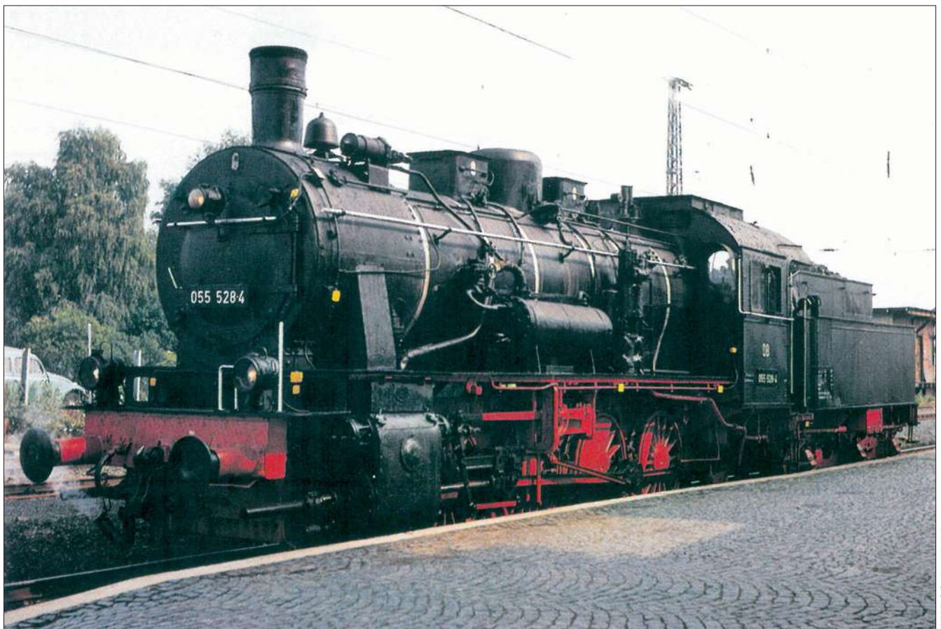
Auch Lokomotiven der BR 55 hatten eine solche Oberflächenvorwärmeranordnung (055 528 am 07.07.1969).
