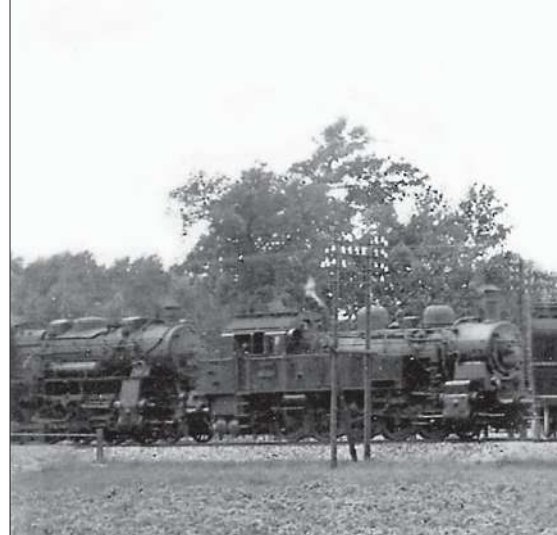
Die Mitteldrucklok 44 012 ist mit dem Messwagen 2 und den Bremslokomotiven 94 1301 und 56 113 des Lokomotivversuchsamts Grunewald auf Probefahrt bei Brandenburg.
