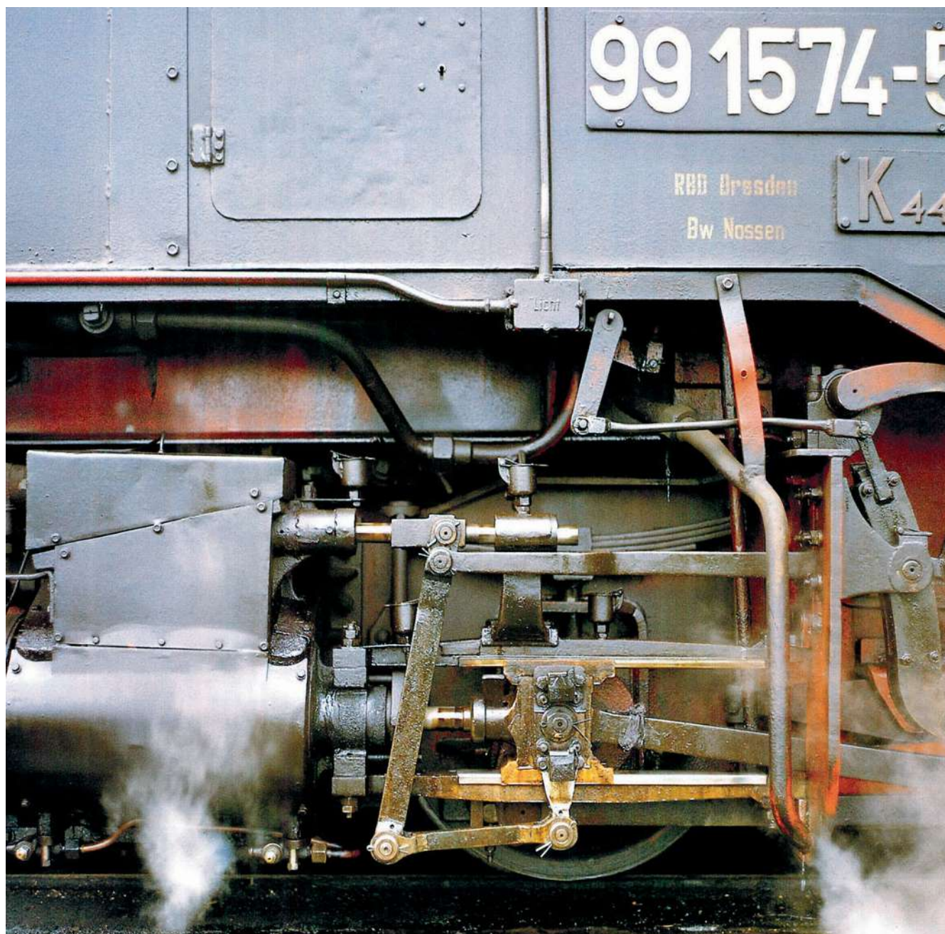
Hochdruckzylinder des Verbundtriebwerks bei den Schmalspurlokomotiven der sächsischen Gattung IV K mit Meyer-Triebwerk. Zur Durchbildung des Aschkastens ist das hintere Triebdrehgestell im Außenrahmen gelagert.
