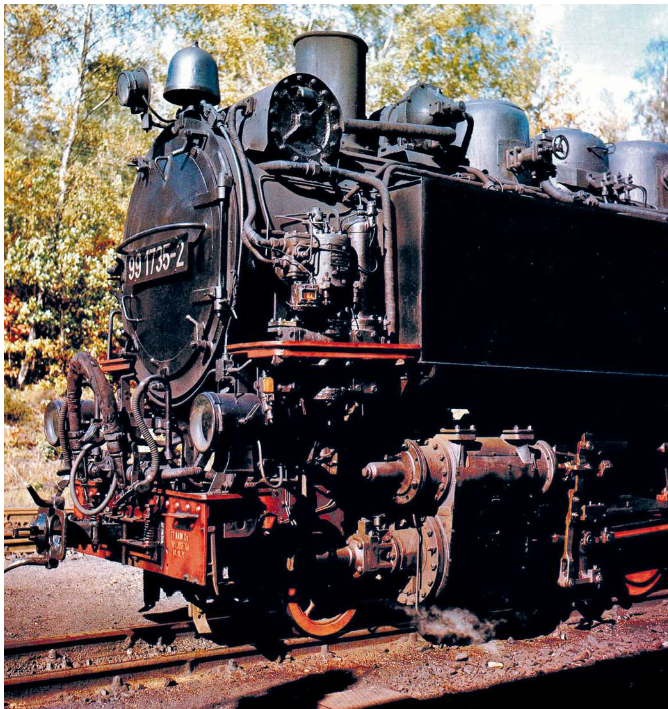
Auch Schmalspurlokomotiven wurden mit Sandstreueinrichtungen ausgerüstet. Der mittlere der drei Dome der 99 1735 ist der Sandkasten. Von ihm gehen rechts und links je drei Fallrohre aus.
