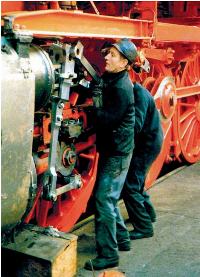
An der 23 105 wird die Schieberschubstange am Voreilhebel eingehängt.
