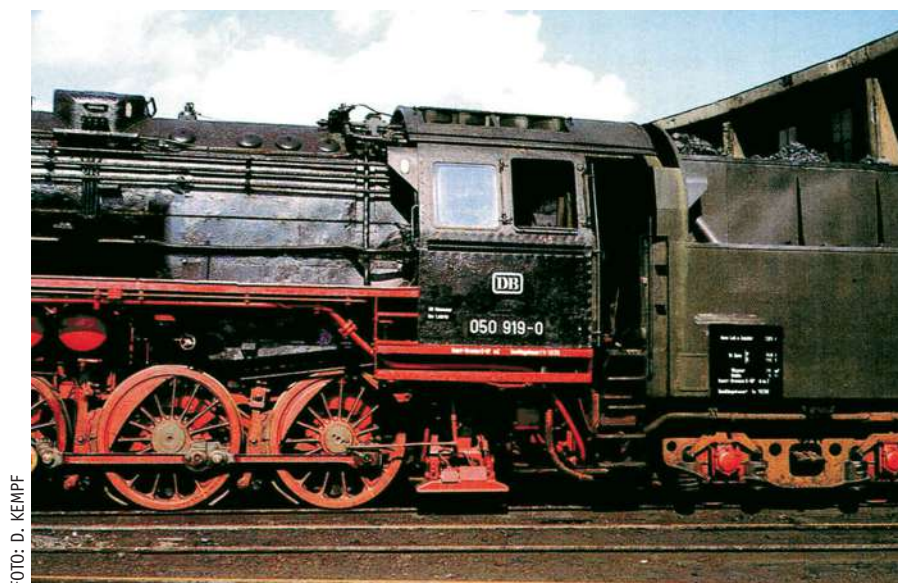
Lokomotive 050 919 des Bw Rheine am 22. September 1974. Auch hier ist auf dem Kessel der Dampfentnahmestutzen sichtbar.
