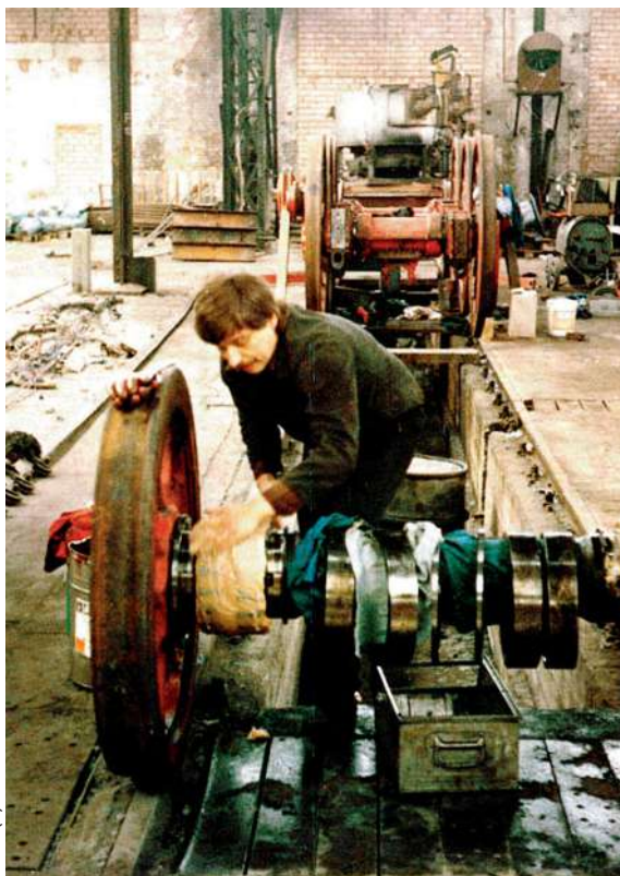
Einfetten der Rollenlager.
