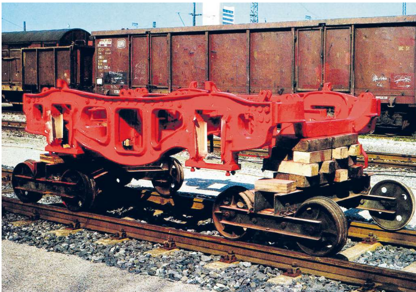
Um den Tender der 41018 wieder betriebsfähig herzurichten, mussten auch etliche Stunden angesetzt werden. Hier ist ein Drehgestellrahmen montierfertig.
