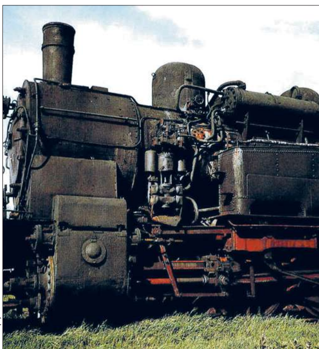
Speisepumpe wie oben, an einer Lokomotive der BR 94, jedoch mit „Knorr-De Limon“-Steuerung, Saugwindkessel und Stoßdämpfern.
