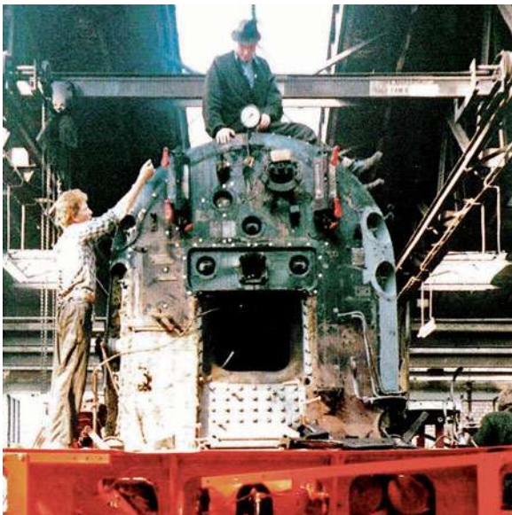
Die Feuerbüchse, wurde von unten in den Stehkessel einer 82 eingefügt.
