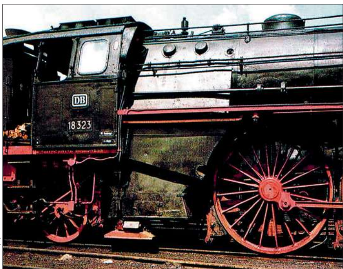
Kurz vor dem Führerhaus war die Dampfpfeife in der Regel bei den Lokomotiven der Länderbahnbauarten, hier bei einer Lokomotive der Baureihe 18 3 im Bw Minden, angeordnet.
