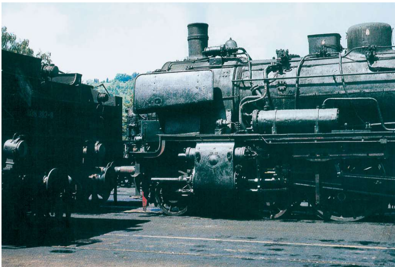
Anbringung des Vorwärmers auf dem Umlaufblech einer Lokomotive der Baureihe 38. Die Lokomotive hat Ersatzzylinder mit angegossenen Ausströmkästen und Druckausgleichkolbenschieber.
