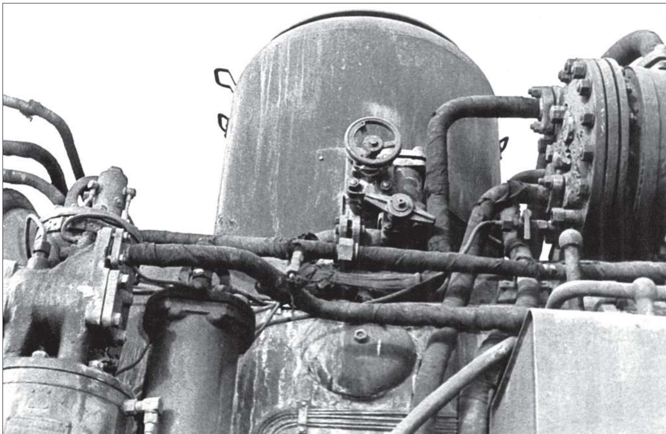
Kesselspeiseventil am Speisedom einer preußischen T 16 1 . Rechts ist der Oberflächenvorwärmer, links ein Teil der Speisepumpe zu sehen.
