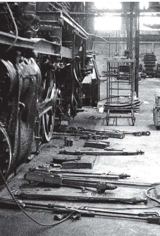
Ausgebaute Bremssteile der 23 105: Bremsbalken, Bremsklötze, Ausgleichhebel und Bolzen sowie weitere Kleinteile.
