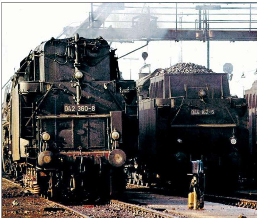
Dieselbe Tenderbauart (2'2'T 34): Einmal in Ölausführung (12 m³ Ölvorrat) der 042 360-8 (links) und (rechts) als Normalausführung ohne Kohlenkastenaufsatz der 044 162-6 (Bw Rheine, 27. August 1972).
