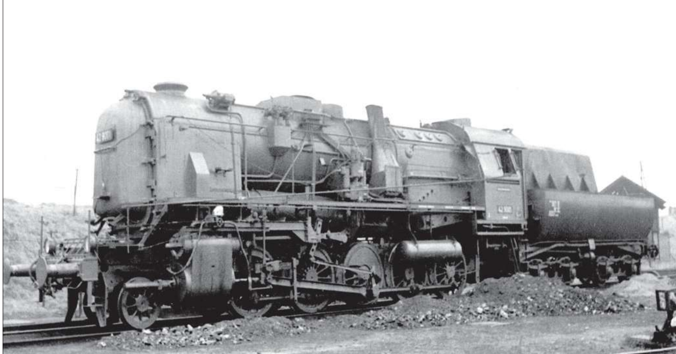
42 9001 mit Franco-Crosti-Rauchgasvorwärmer und angebautem Maihak-Indikator auf dem linken Zylinderblech.
