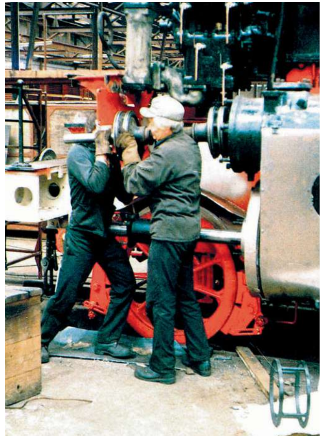
Einbau des linken Kolbenschiebers an der Lok 23 105.
