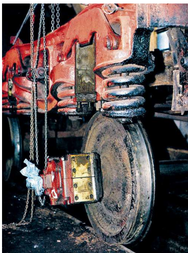
Ausachsen eines Drehgestells. Anhand dieses Fotos ist die Konstruktion leicht zu verstehen.
