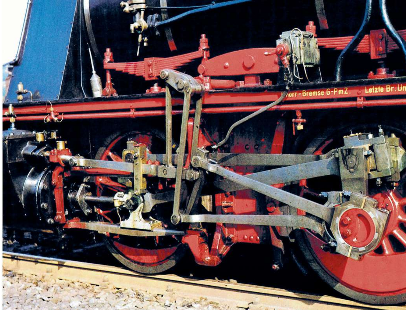
Die preußische T3 (Baureihe 89 70-75 ) besitzt einen zweischienigen Kreuzkopf (fotografiert am 20. März 1975).
