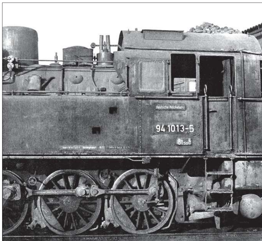
Unmittelbar vor dem Führerhaus sitzt bei den Lokomotiven der Baureihe 94 das Kesselsicherheitsventil der Bauart Ramsbottom.
