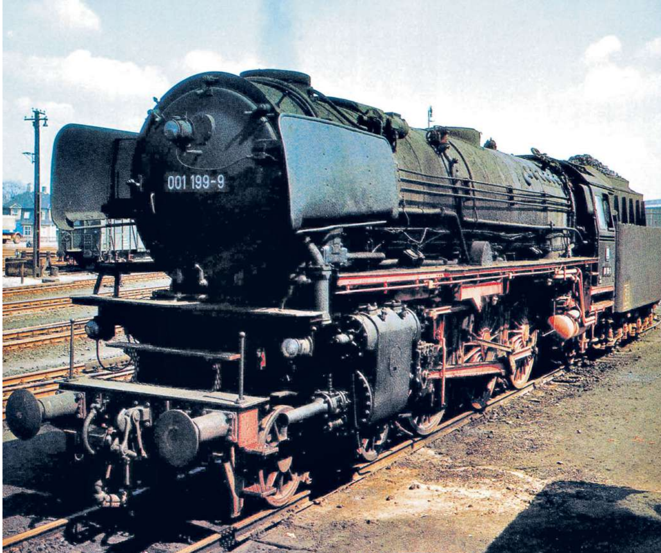
Die Baureihe 01 (mit Neubaukessel) besitzt ein Zweizylinder-Heißdampf-Triebwerk. Die Aufnahme entstand am 29. April 1969 im Bw Paderborn.
