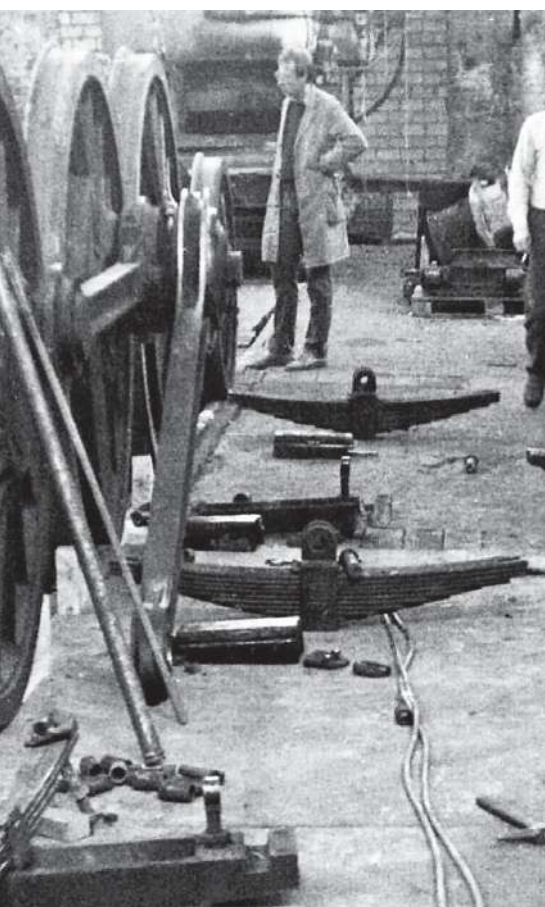
So wie diesen Federpaketen sah man auch den anderen Teilen der 23105 vor ihrer Aufarbeitung den Verschleiß deutlich an.
