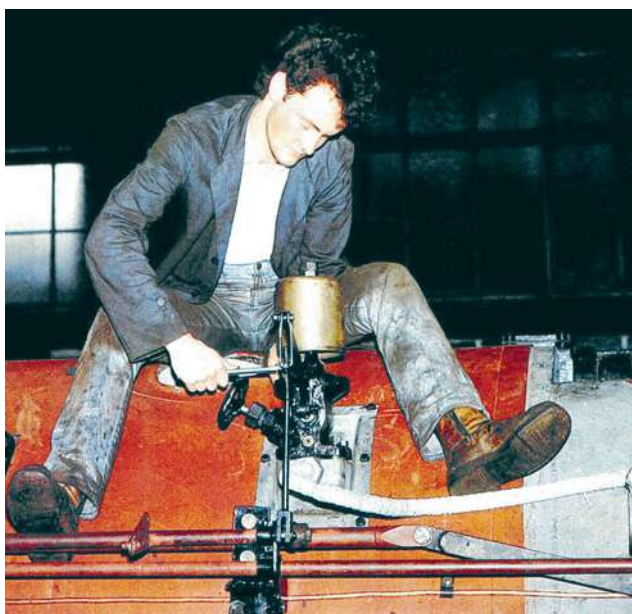
Auch keine einfache, aber wenigstens nicht allzu schwerwichtige Arbeit: Hier wird gerade die 24 Kilogramm wiegende Dampfpeife mit Messingglocke an der 41018 montiert.
