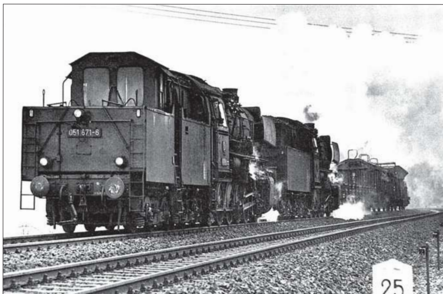
Mit den Kabinentendern wollte man bei Güterzügen den Begleitwagen einsparen. Bei der DB waren dies ausschließlich Tender 2'2' T 26. Die 051 671-6 und die 051 219-4 mit Ng bei Maxhütte-Haidhof (5. März 1974).
