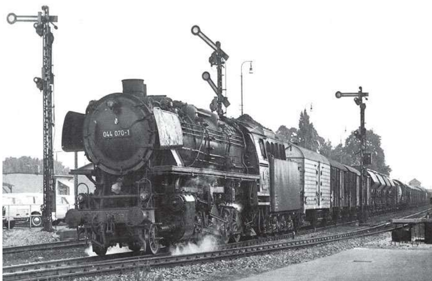
Die 044 070 mit einem Dg von Crailsheim nach Nürnberg bei der Ausfahrt aus dem Bahnhof Crailsheim am 27. Juli 1972. Die Lok ist mit einer Gegendruckbremse ausgerüstet, wie man am Schalldämpfer neben dem Schlot sehen kann.
