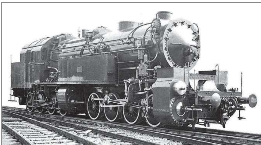
Bei der achtachsigen Baureihe 96 handelt es sich um eine Verbundlokomotive, deren vorderes Triebwerk von Niederdruckzylindern und das hintere Triebwerk von Hochdruckzylindern angetrieben wurden. Diese Maschinen wurden bereits 1949 und 1954 ausgemustert.
