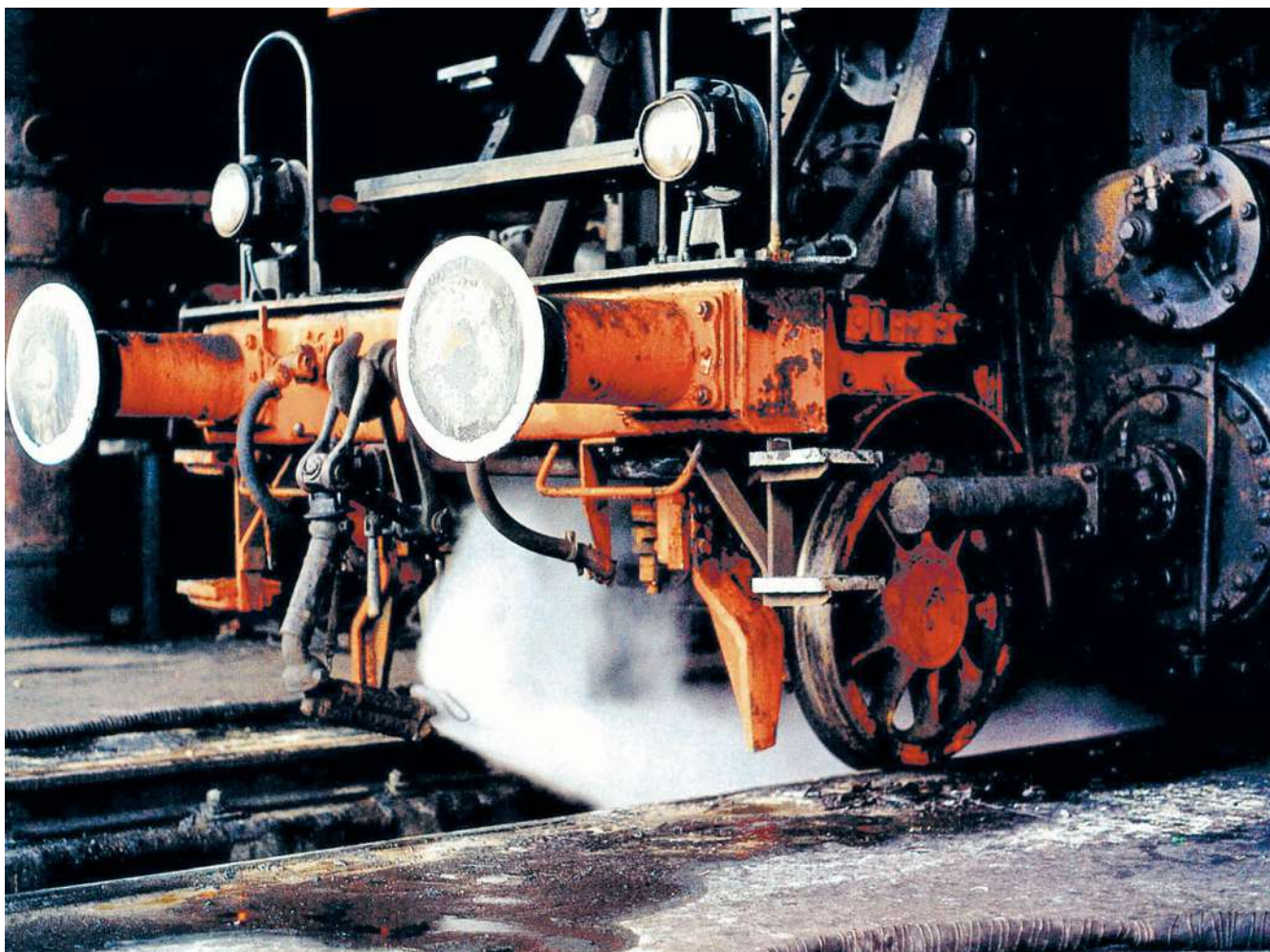
Musste im Bw der Kesseldruck reduziert werden, dann wurde Dampf aus der Heizleitung abgelassen, so wie hier an der 044 569 (Bw Ottbergen, April 1976).
