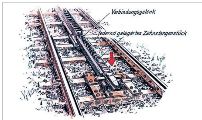
Ansicht einer gefederten Zahnstangeneinfahrt nach System Riggenbach.
