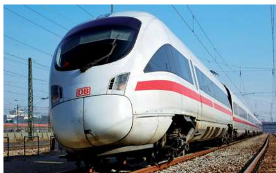
Um bis zu acht Grad können sich die ICE-T neigen. Für die Kamera wird das hier im Stand am Endwagen 411 503 demonstriert. FOTO: J. HUND
