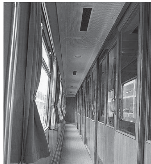
Die Abteile im Abteilwagen sind durch Schiebetüren vom Seitengang getrennt. Die Wandbekleidung ist in Kirschbaumfurnier ausgeführt.
