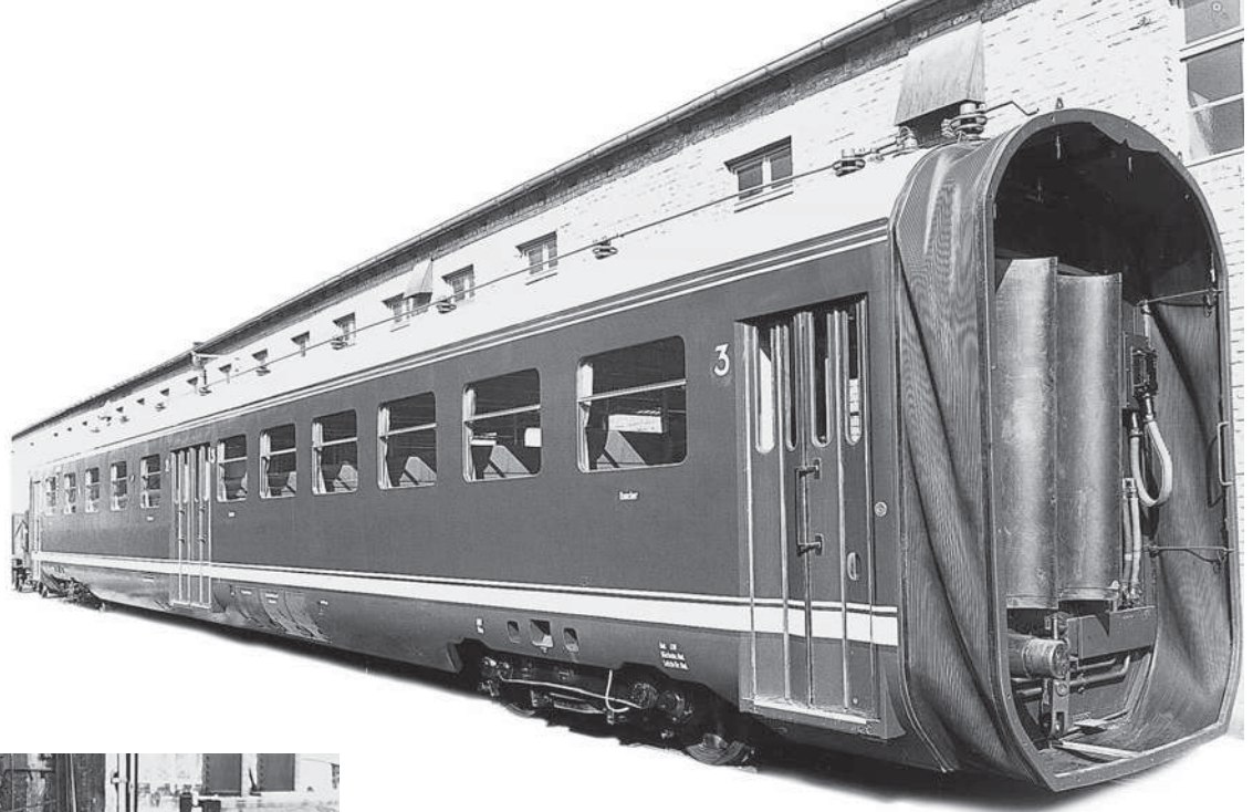
Mittelwagen EM 30: Die kurzgekuppelte Schraubenkupplung mit Dämpfungspuffer und der Übergangsschutz mit Kuppelrahmen sind gut zu erkennen. FOTO: SLG. KURZ
