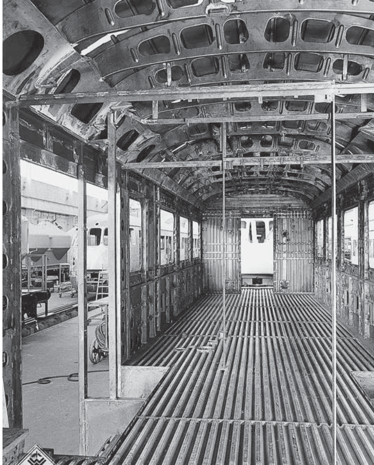
Blick in den prinzipiellen Aufbau des Wagenkastens des ET 30 mit geschweißtem Wellblechfußboden zur Aussteifung, den vorgefertigten Seitenwänden, den Dachspriegeln und dem Dach. Wegen der Ausschnitte für die Faltdüren mussten die Langträger an diesen Stellen unterbrochen werden. FOTO: VWW/SLG. KURZ
