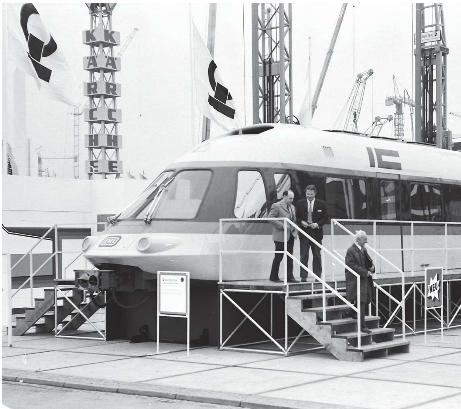
Auf der Hannover-Messe 1972 wurde ein 1:1-Holzmodell der Kopfpartei gezeigt. Strömungstechnische Modellversuche im Windkanal bestätigten die aerodynamisch günstige Ausbildung des Fahrzeugkopfs. FOTO: R. R. ROSSBERG
