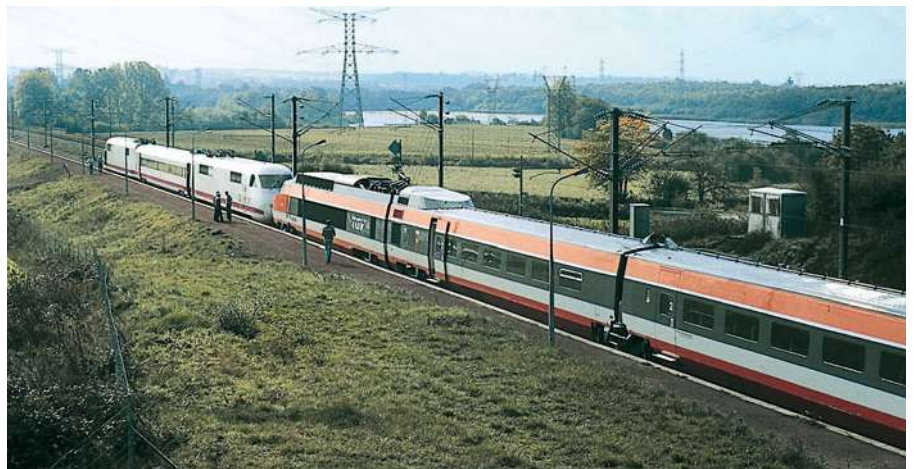
Im Juli 1988 stand ein Triebkopf für längere Zeit nicht zur Verfügung. Um die Versuche trotzdem fortsetzen zu können, wurde 810 003 behelfsweise mit einem Notsteuerstand versehen (Bw Würzburg, 11. Juli 1988).
