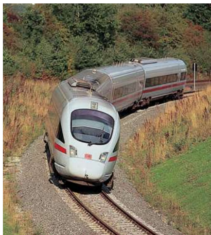
Der Diesel-ICE im Einsatz zwischen Dresden und Nürnberg. In der Schlömerer Kurve bei Neuenmarkt-Wirsberg ist die Neigung des Zuges gut zu erkennen. FOTO: W. KLEE
