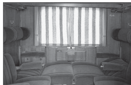
Die Abteile im Abteilwagen sind durch Schiebetüren vom Seitengang getrennt. Die Wandbekleidung ist in Kirschbaumfurnier ausgeführt.
