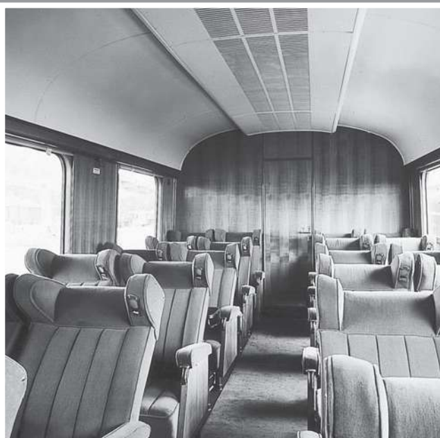
Im Kopfglied B waren zusätzlich zur Maschinenanlage in einem Raum 24 verstellbare Liegesitze angeordnet. FOTO: DB (STEIDL)/SLG. ASMUS (3)
