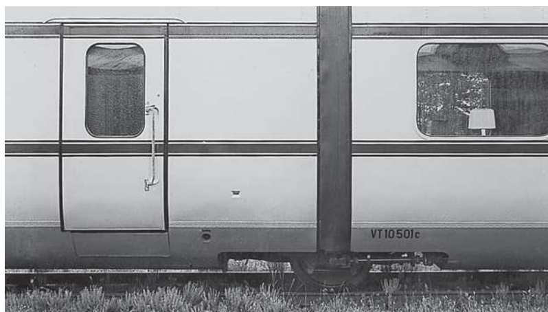
Der Tagesgliederzug wurde mit Einzelachslaufwerken ausgestattet, die trotz mehrerer Nachbesserungen nie so recht befriedigten. FOTO: DB/SLG. ASMUS
