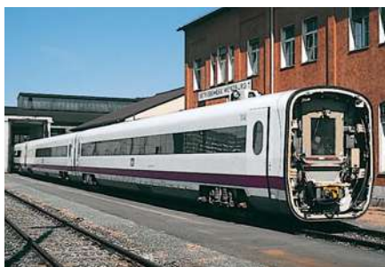
Im Juli 1988 stand ein Triebkopf für längere Zeit nicht zur Verfügung. Um die Versuche trotzdem fortsetzen zu können, wurde 810 003 behelfsweise mit einem Notsteuerstand versehen (Bw Würzburg, 11. Juli 1988).
