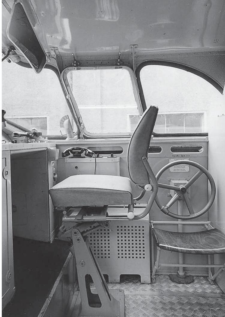
Rückwand der Führerkabine des VT 11 5010 mit der Tür zum Maschinenraum für den Dieselgenerator, der der Erzeugung der elektrischen Energie für den Triebzug (u.a. für Klimaanlage, Küche und Beleuchtung) dient.
