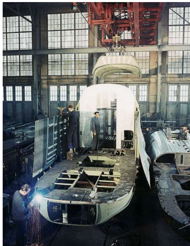
Die Seitenwandbleche aus Leichtmetall werden an das Stahl-Untergestell angesetzt. Die Verbundbauweise von Stahl und Aluminium führte zu niedrigeren Achslasten und ermöglichte so den freizügigeren Einsatz bei den europäischen Bahnverwaltungen.
