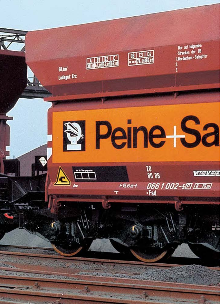
Die erste Generation der modernen sechsachsigen Selbstentladewagen Fad 150 mit automatischer UIC-Kupplung für den Erztransport zwischen Hamburg-Hansaport und den Stahlwerken Peine-Salzgitter. FOTO: LHB/SLG. CARSTENS
