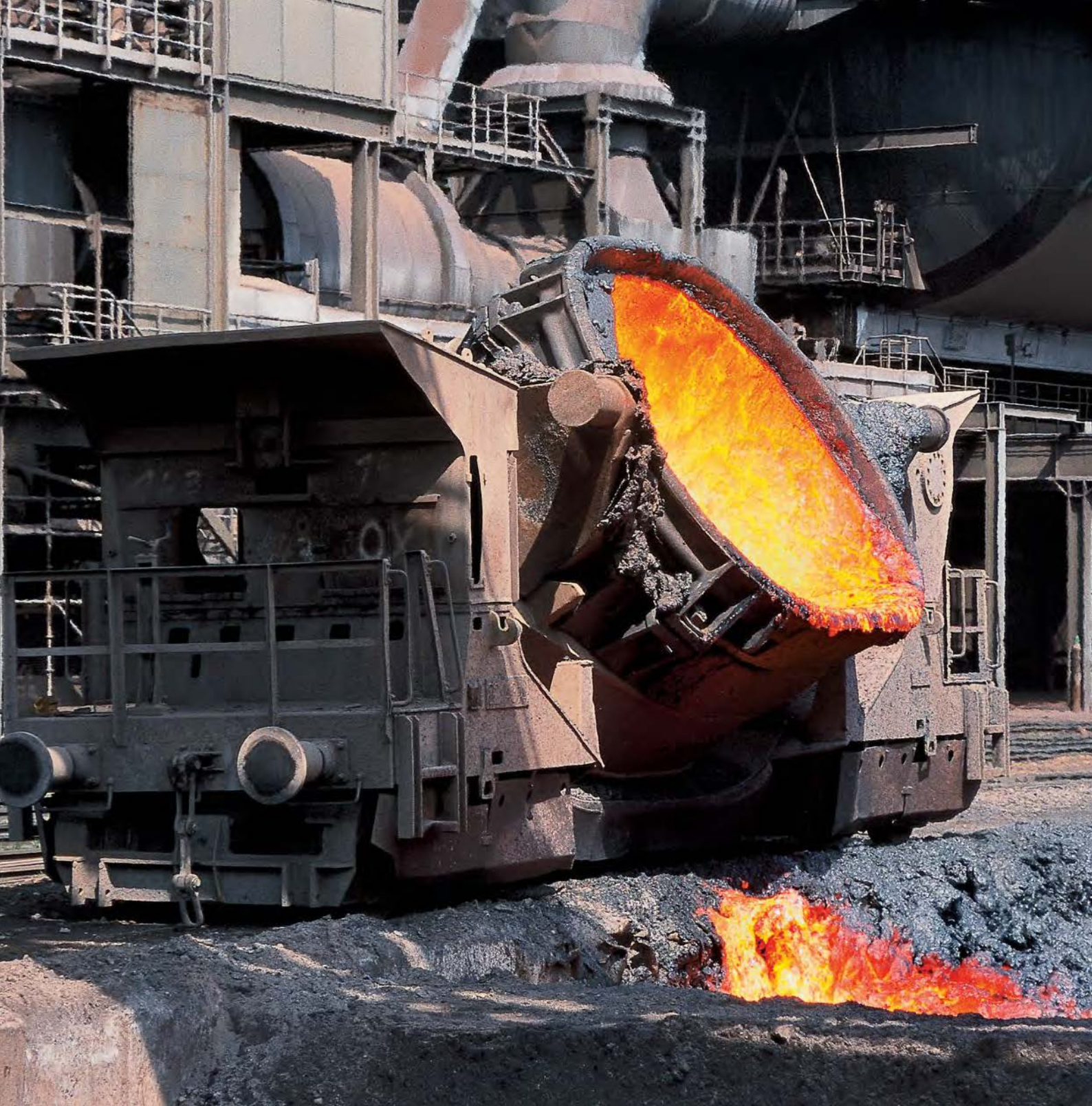
Schlackewagen des TKS-Stahlwerks in Duisburg-Bruckhausen nach dem Abkippen der glühenden Konverterschlacke. FOTO: U. ZIGAN
