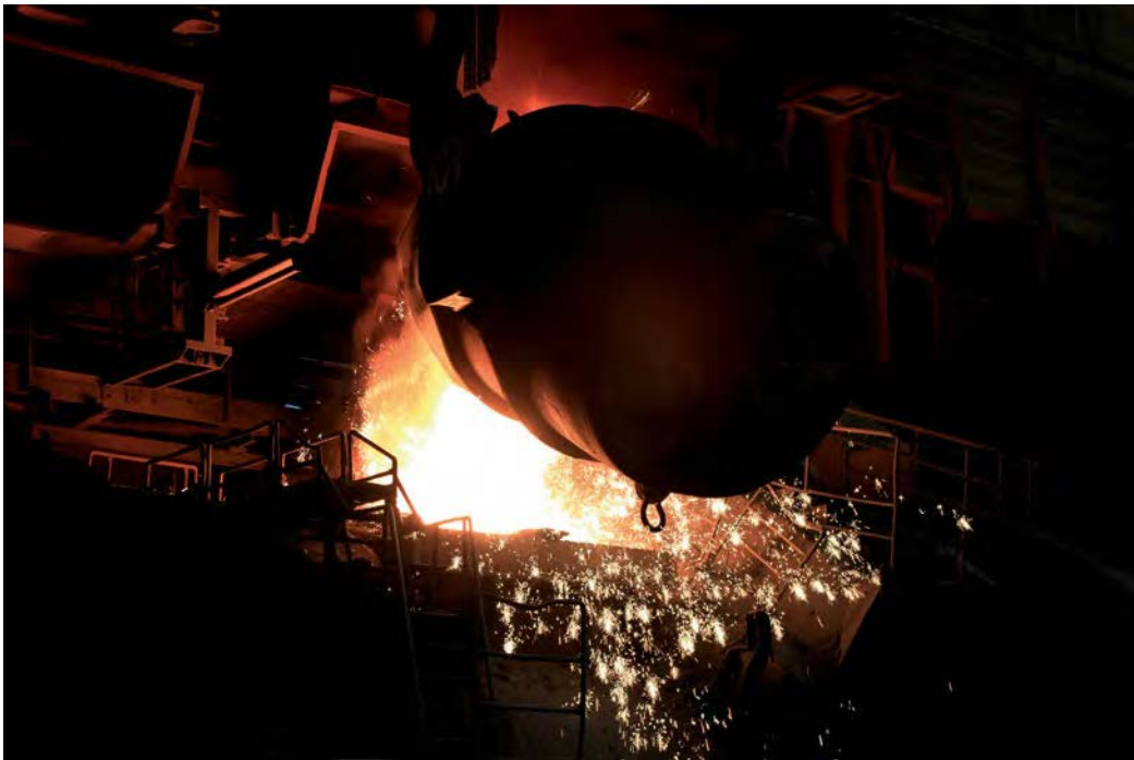
Umfüllen des Roheisens im LD-Stahlwerk von der Transport- in die Chargier- pfanne; hier beim HKM in Duisburg-Huckingen.
