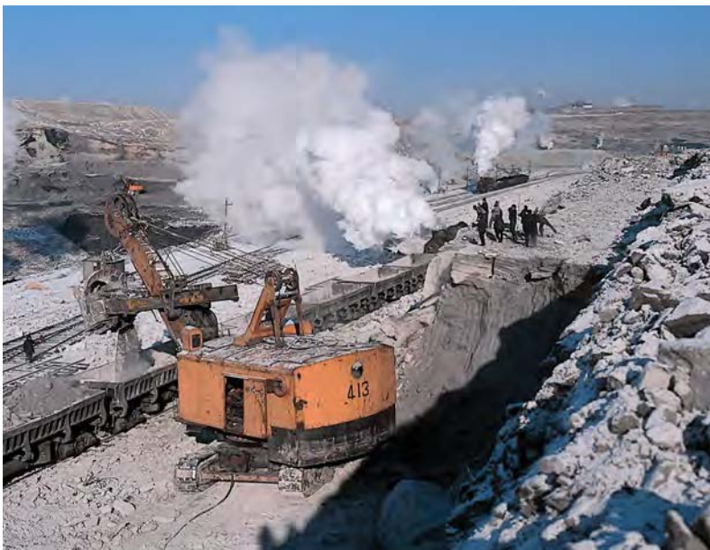
Abraum und Kohle (oben) werden im terrassenförmigen Kohletagebau von Jalainur mit Löffelbaggern auf die Bahn verladen und mit Dampfloks der Reihe SY abgefahren.
