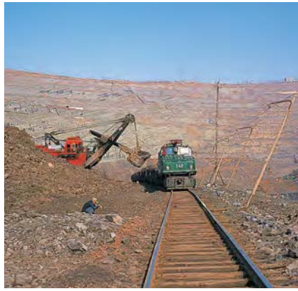
Bei den Gelenkloks der Baureihe EL1 handelt es sich um eine von DDR-Importen abgeleitete chinesische Bauart.
