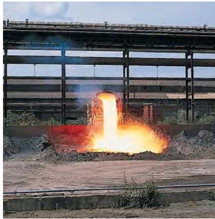
Straßengebundener Schlacken-transporter beim Abkippen der Konverter-schlacke in das Schlackenbeet.
