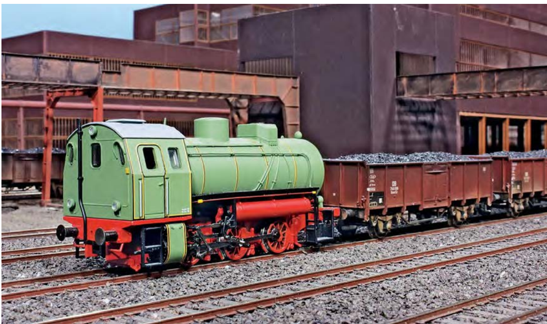
Feuerlose Dampfspeicherlokomotive beziehen ihre Antriebsenergie aus dem erzeugten Dampf einer stationären Anlage. Neben der chemischen Industrie wurden sie besonders gerne im Bergbau eingesetzt.
