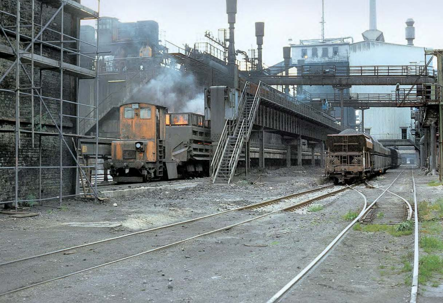
Typisches Merkmal der Kokslöschloks ist der hochliegende Führerstand, damit der Lokführer beim Ausdrücken des glühenden Koks aus den Kammern der Koksofenbatterie in den Löschwagen die Übersicht behält (Kruppsches Hüttenwerk in Duisburg-Rheinhausen). FOTO: F. GLAUBITZ
