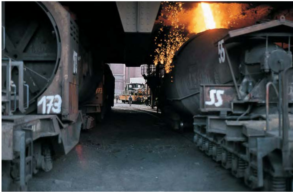
Abstich am Hochofen 1 in Duisburg-Schweglern am 6. November 1991. Funkensprühend fließt das 1400 °C heiße Roheisen in den Torpedopfannenwagen. FOTO: J. GLÖCKNER
