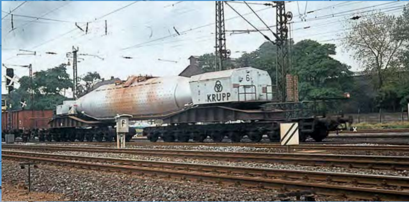
Die formschönen Krupp-Torpedomischwagen wurden 1968 in Dienst gestellt. Die 34 m langen und 374 t schweren Schienen-giganten fassen 165 t flüssiges Roheisen. FOTO: H. OESTERLING/SLG. MEINHOLD RECHTE SEITE OBEN: Zwei Torpedowagen unterschiedlicher Bauart für den Werksverkehr bei FKS in Duisburg-Beeckerwerth. FOTOS: U. ZIGAN (2)
