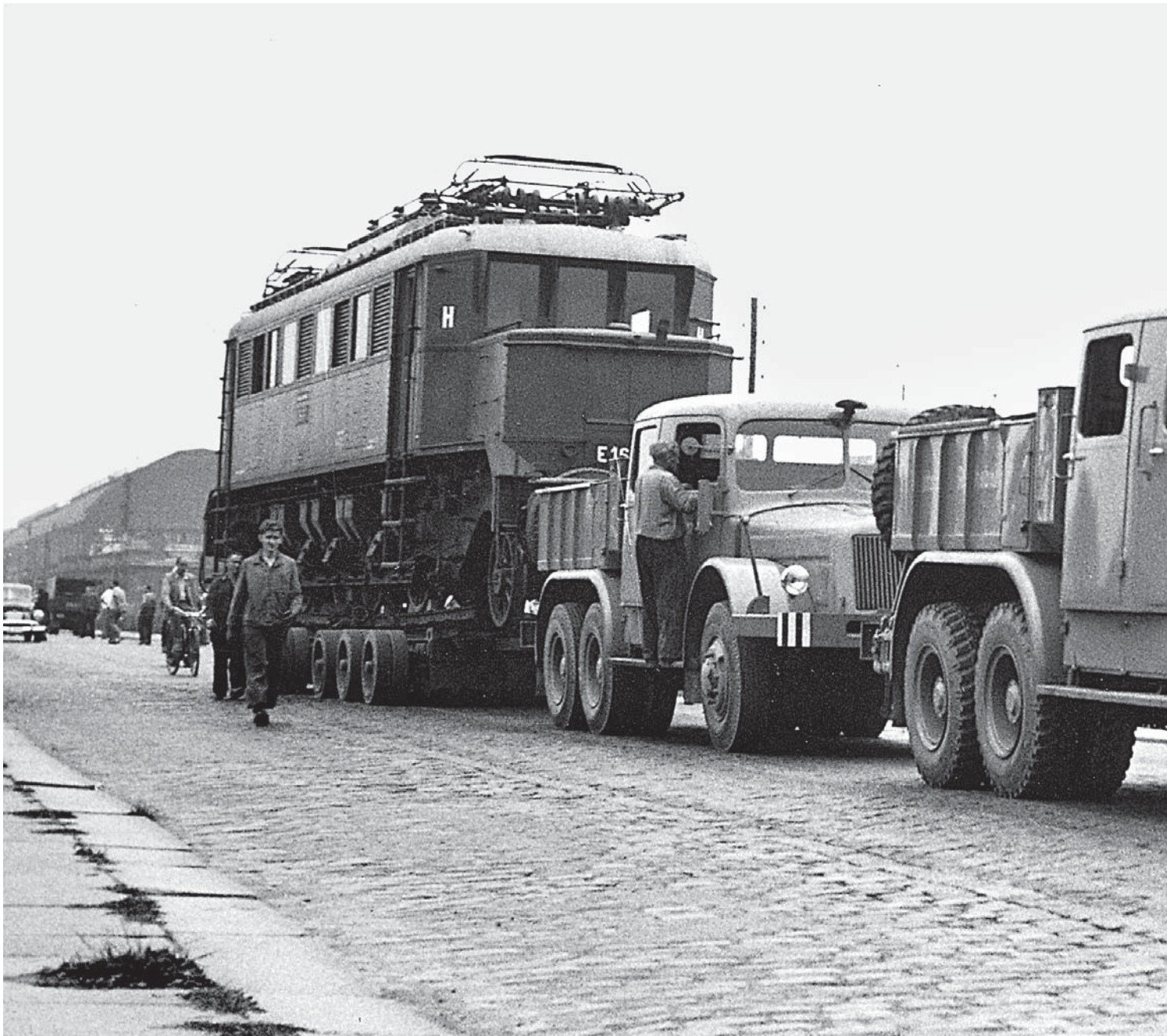
Transport der E 16 101 per Culemeyerfahrzeug vom Hauptbahnhof Dresden zur Hochschule für Verkehrswesen (Foto K. Brust)
