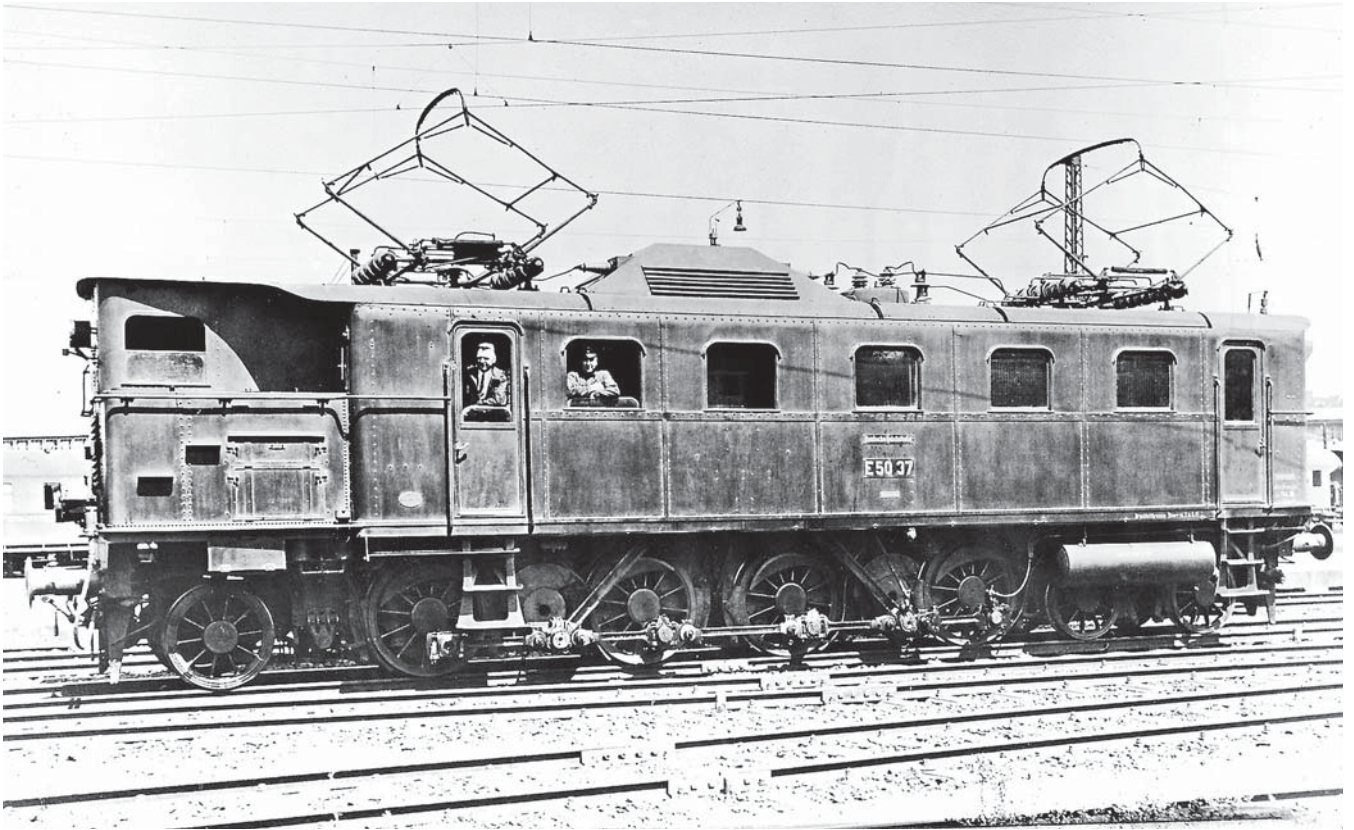
E 50 37 besaß einen BO-Hauptschalter auf dem Dach. Das Foto entstand 1933 in Breslau, Freiburger Bf. (Foto R. Kallmünzer, Slg. H. Linke)
