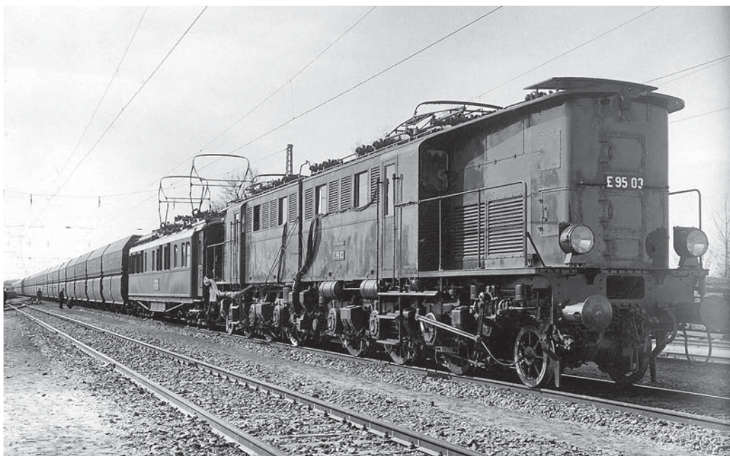
Die E 95 03 während ihrer am 24. März 1928 durchgeführten Schwerlastfahrt mit dem aus OOt-Selbstentladewagen gebildeten 2.568 Tonnen schweren Zug beim Zwischenaufenthalt im Bf Ingramsdorf (Nachlass E. W. Curtius, Slg. Chr. Tietze)
