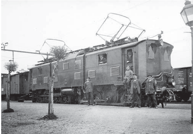
Die für die Leistungsmessfahrt mit Kabeln und stirnseitiger Hochspannungskupplung ausgerüstete EG 582 vor einem Güterzug (Slg. Th. Borbe)
