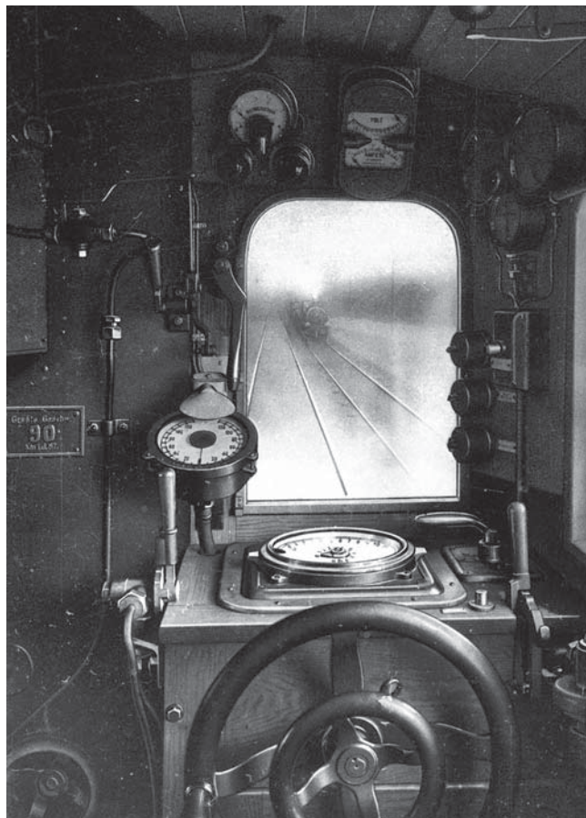
Der hintere Führerstand der EP 235 mit dem am linken Bildrand befindlichen Heizkessel (Slg. Th. Borbe)
