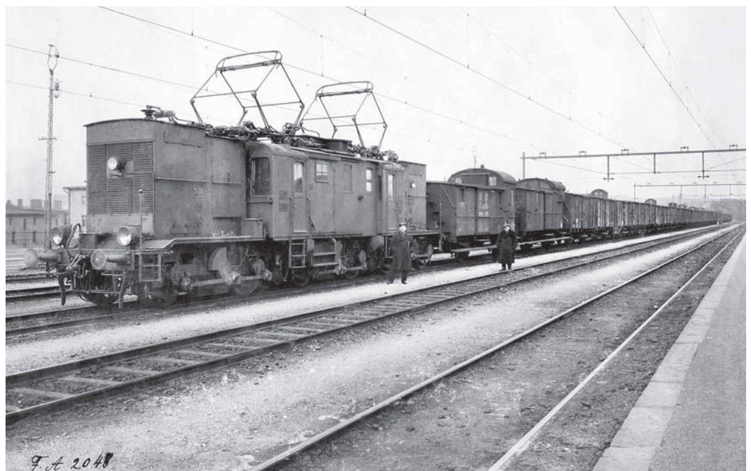
Die EG 538 nach ihrem Umbau. Gegenüber den EG 540 ff. ist der Vorbau jedoch niedriger. (Slg. Dr. G. Scheingraber)
