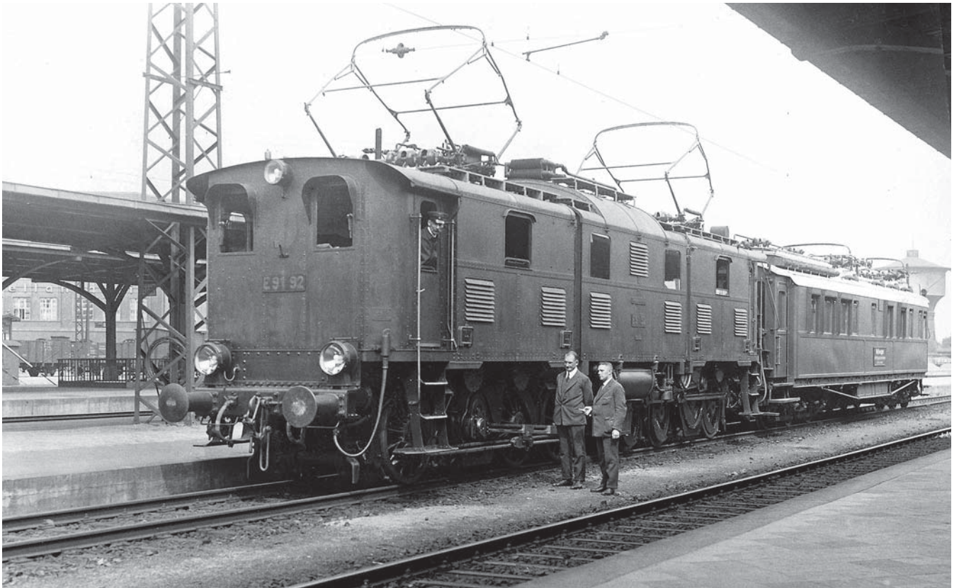
E 91 92 mit dem Messwagen für elektrische Lokomotiven im Bf Königszell. Die Lok ist bereits mit elektrischer Zugheizung ausgerüstet. (Nachlass E. W. Curtius, Slg. Chr. Tietze)
