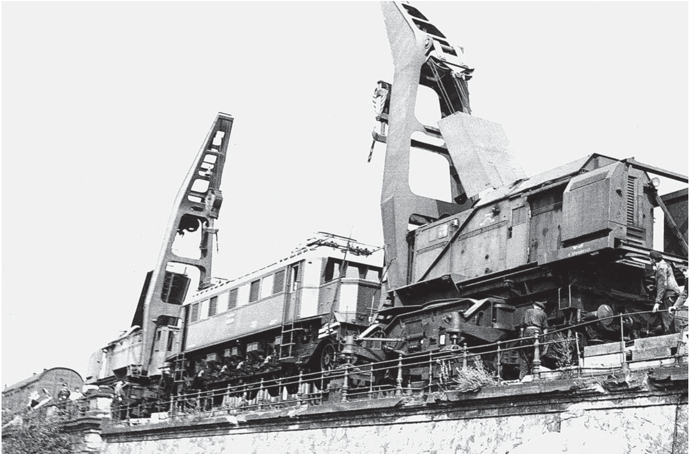
Zwei 50-Tonnen-Eisenbahndrehkräne heben die Lok von den Hochgleisen des Dresdner Hauptbahnhofs auf ein Culemeyerfahrzeug herab. (Foto K. Brust)
