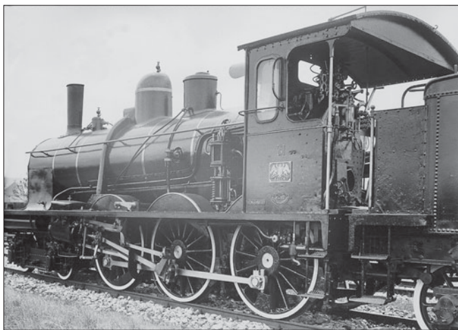
Die badische IVe mit der Nummer 38 lässt gut die Beschilderung am Führerhaus erkennen: In der Mitte prangt das badische Staatswappen, darüber sitzt das Schild mit der Gattungsbezeichnung und der Betriebsnummer, darunter das Fabrikschild Grafenstaden 1895 No. 4703, links daneben erkennen wir noch das Heimatschild Waldshut. (Foto 1895, Sammlung Bad. Generallandesarchiv Karlsruhe)
