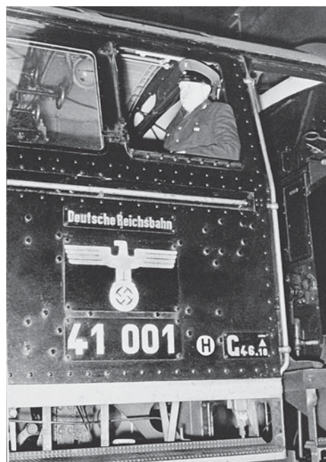
41 001 mit der ersten Ausführung des Hoheitszeichens, rechts neben dem Nummernschild das Zeichen für Heimstoffe; das Führerhausdach dieser Lok läßt übrigens deutlich einen grauen Außenanstrich erkennen (Foto Ullstein)
