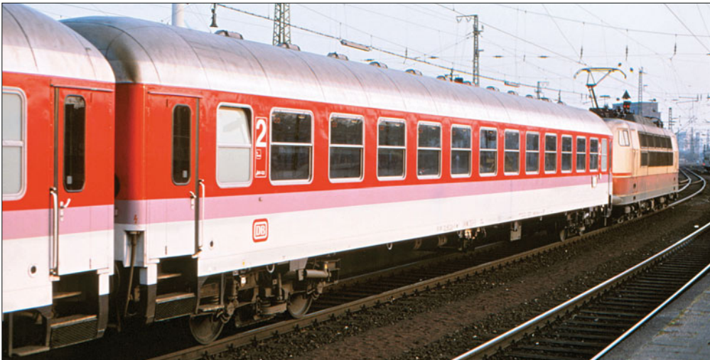
Schnellzugwagen DB 51 80 22-90 224-4 Bm 235; Dach fenster- und lichtgrau, Wagenkasten und Langträgerverkleidung lichtgrau, Fensterband orientrot, Begleistreifen pastellviolett, Schürzen und Drehgestelle graubraun (Foto Münster 1992 Rolf Köstner)
