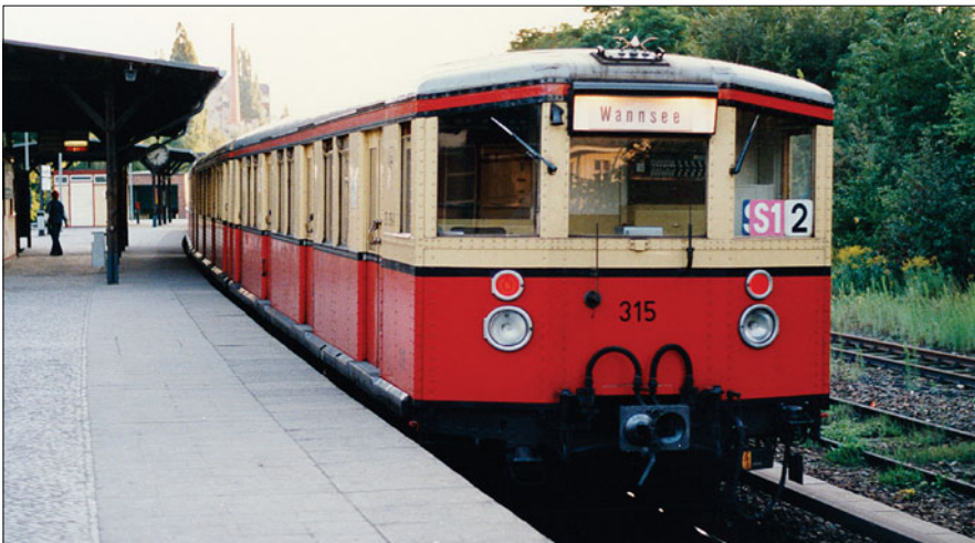
S-Bahn-Triebwagen BVG 275 315-0; Dach fehgrau, Wagenkasten rubinrot, Fensterband sandgelb, Brüstungsleisten, Deckschienen und Rahmen schwarz (Foto Berlin 1987)
