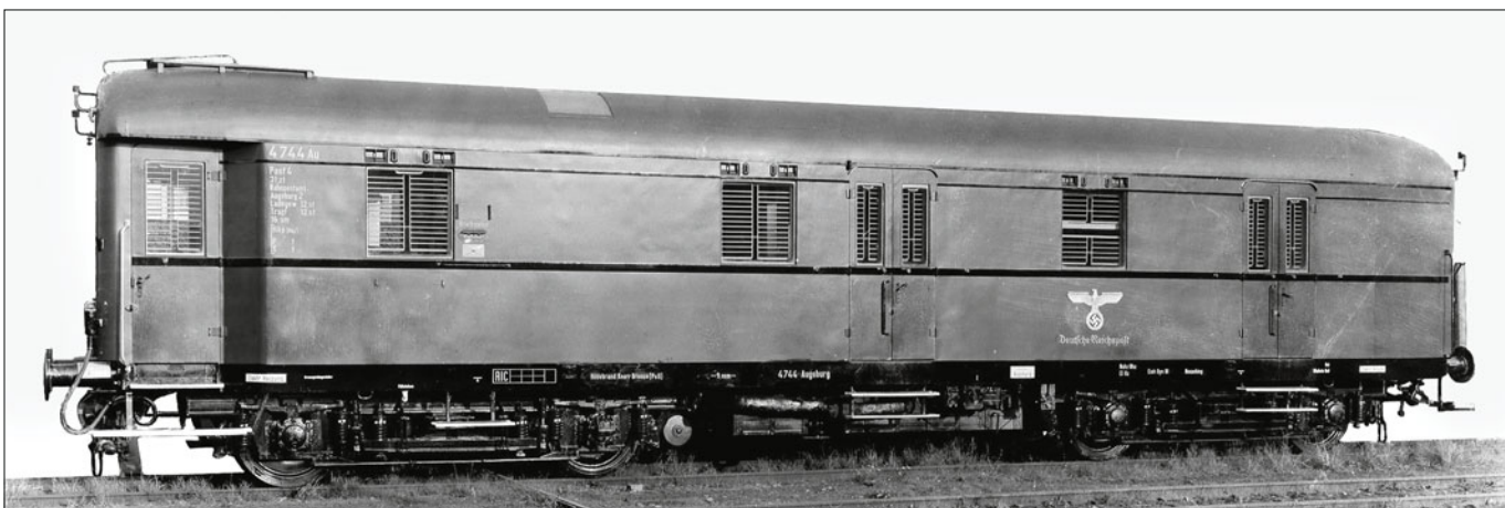
Bahnpostwagen DRP Augsburg 4744 Post4-a/15, flaschengrüner Wagenkasten, schwarze Langträgerverkleidung, einziger farblicher Zierstrich ist die schwarze Brüstungsleiste, Reichsadler mit Frakturschrift „Deutsche Reichspost“, Wagennummer im Anschriftenfeld am linken Ende der Seitenwände (Werkfoto 1939 Esslingen)
