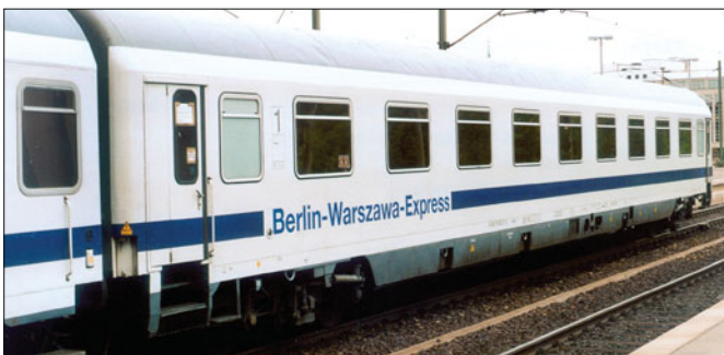
Schnellzugwagen DB AG 61 80 19-90 211-2 Avmz 111.1; Dach und Schürzen basaltgrau, Dachvouten, Wagenkasten und Langträgerverkleidung lichtgrau, Zierstreifen nachtblau; Anschrift „Berlin-Warszawa-Express“ blau (Foto Berlin 2003)
