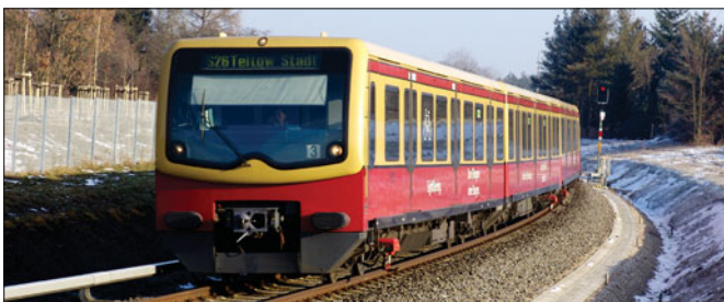
S-Bahn-Triebwagen DB AG 481; Wagenkasten rubinrot, Fensterreihe, Stirnwandfensterverkleidung, Dach ockergelb (Foto Teltow-Seehof 2006 BVS-Jurjiczek)
