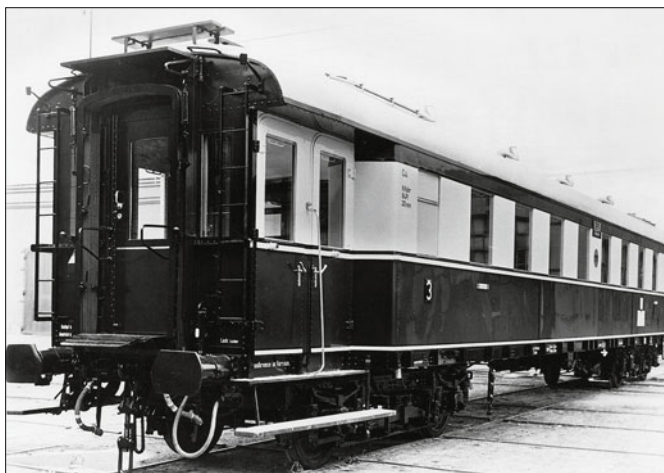
Karwendelwagen DRB 16 528 C4ü-32; Wagenkasten oben beige, unten und über den Fenstern dunkelblau, Brüstungsleisten und Deckschienen schwarz, Zierstreifen beige (Werkfoto 1932 Nürnberg)
