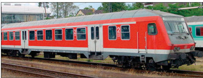
Nahverkehrswagen DB AG 50 80 80-35 105-1 Bndzf 431; Dach und Langträgerverkleidung basaltgrau, Dachvouten und Wagenkasten verkehrsrot, Zierstreifen und Einstiegstüren lichtgrau, Rahmen und Drehgestelle schwarz (Foto Darmstadt 2001)
