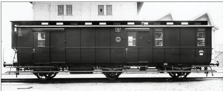
Bahnpostwagen DRP Stuttgart 7367 Post3 b/12,5 im braungrün/schwarzen Einheitsanstrich der Reichsbahn-Reisezugwagen, das Eigentumszeichen ist das Adlerbild von Firlé mit der Umschrift „Deutsche Reichspost“ (Werkfoto 1925 Esslingen)
