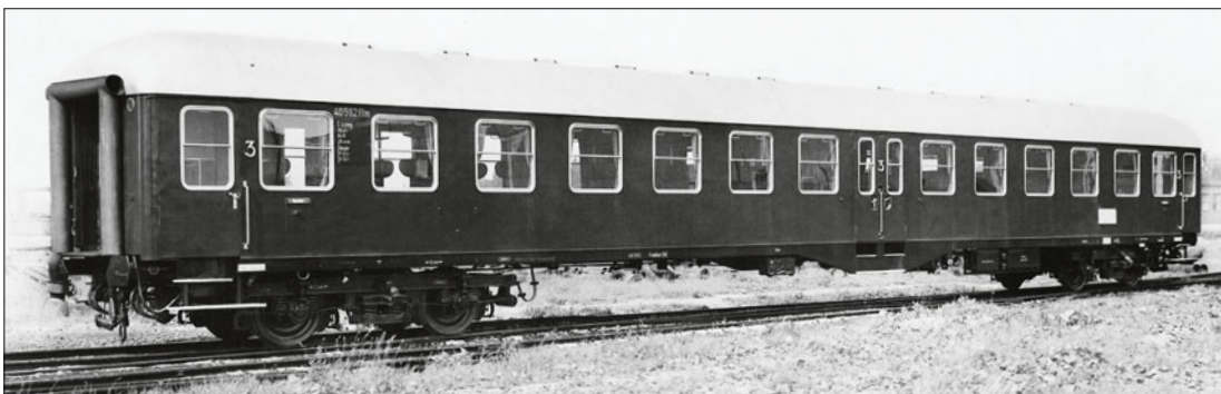
Eilzugwagen DB 40 592 C4ymg-51; 1953 lieferte LHW diesen Mitteleinstiegswagen an die Deutsche Bundesbahn. Diese Aufnahme zeigt ihn mit der seinerzeit typischen Klassenbezeichnung aus erhabenen Aluminiumziffern. Im Anschriftenfeld
