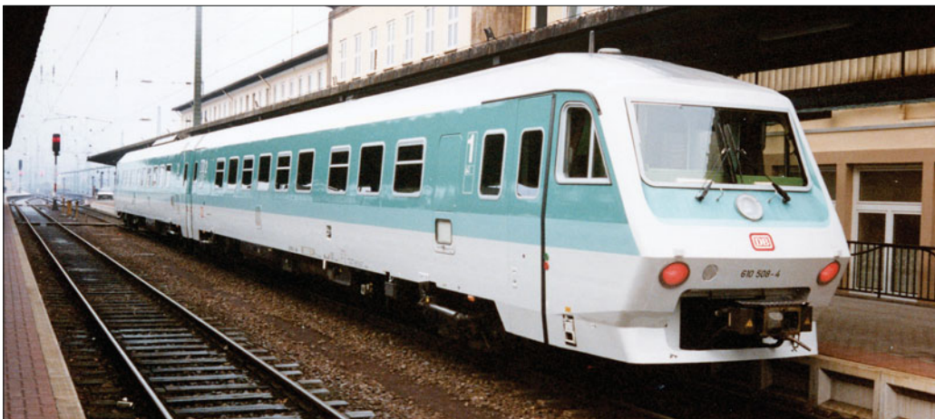
Verbrennungstriebwagen DB 610 508-4; Dachvoute, Wagenkasten lichtgrau, Fensterband minttürkis, Begleitsstreifen pastelltürkis, Langträgerverkleidung und Schürzen lichtgrau, Rahmen graubraun (Foto um 1992)
