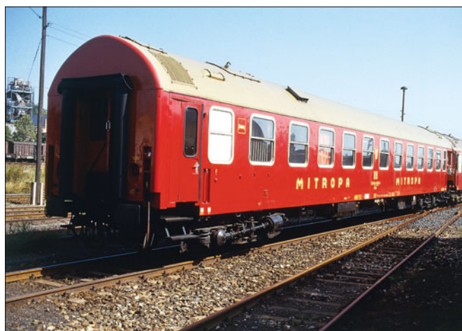
Unten rechts: Schlafwagen DR 51 50 86-40 000-6 WLABr; Dach rehbraun, Wagenkasten und Langträgerverkleidung bordeaux, Rahmen und Drehgestelle schwarz (Foto Gotha 1992 Hans Ulrich Diener)
