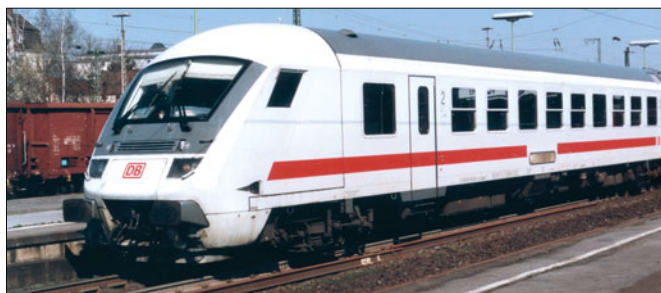
Schnellzugwagen DB AG 51 80 80-95 003-4 BimdZ 271.0; Dach und Führerstandsfenstereinfassung basaltgrau, Dachvouten, Wagenkasten und Langträgerverkleidung lichtgrau, Zierstreifen verkehrsrot, Rahmen und Drehgestelle schwarz (Foto Herford 2005 Richard Schulz)
