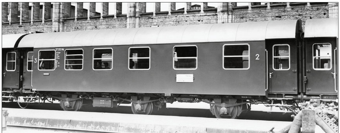
Durchgangswagen DB 37 313 BC3yg-*/54 Umbauwagen; Dach weißaluminium, Wa- genkasten flaschen- grün, Rahmen und Fahrwerk schwarz (Foto 1955 Günter Scheingraber)
