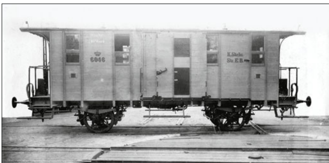
Behelfspersonenwagen Sachsen 6046 Cgi; Wagenkasten und Rahmen grau, Anschriften wie bei Güterwagen (Werkfoto 1894 Nürnberg)
