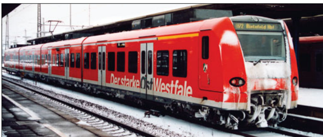
Nahverkehrstriebwagen DB AG 425 560-0; Dach, Führerstands-fenstereinfassung und Langträgerverkleidung basaltgrau, Dach-vouten und Wagenkasten verkehrsrot, Zierstreifen und Einstiegs-türen lichtgrau; Kennzeichnungstreifen goldgelb (Foto Herford 2003 Richard Schulz)
