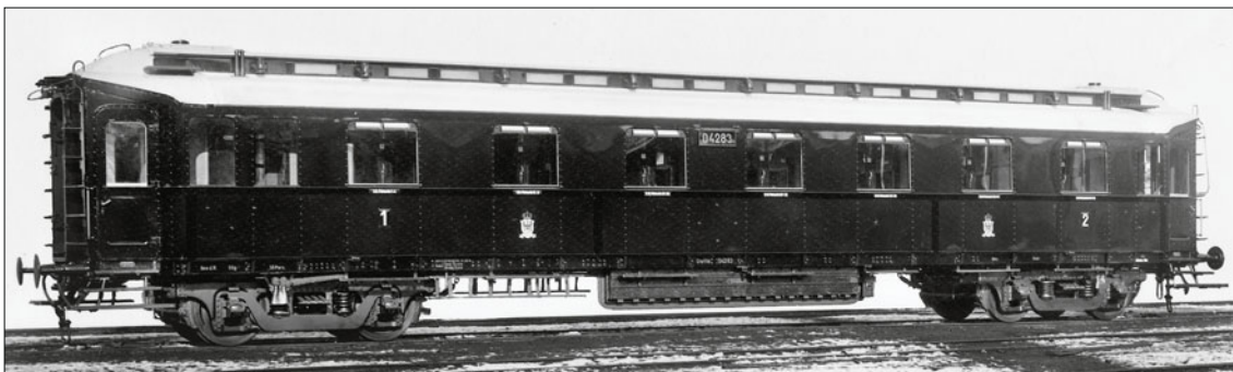
Schnellzugwagen Preußen 04283 ABBü Stettin; Wagenkasten grün, Brüstungsleisten, Deckschienen und Einfassungen schwarz, keine Absetzlinien mehr (Werkfoto 1915 Görlitz)
