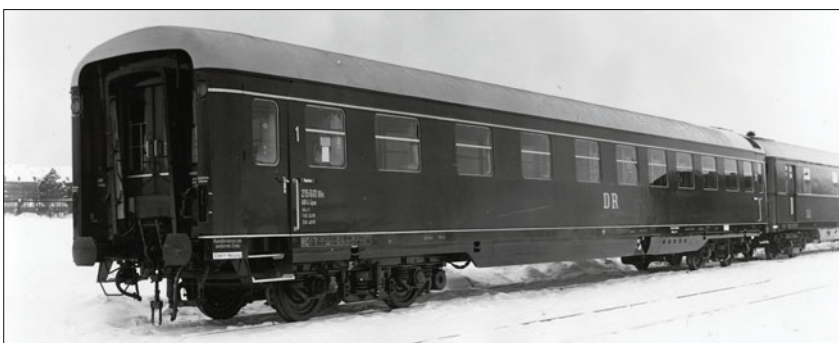
Schnellzugwagen DR 215 601 AB4üpe-56, Wagenkasten flaschengrün, Brüstungsleisten, Deckschienen, Einfassungen und Langträgerverkleidung schwarz, Zierstreifen und Absetzlinien elfenbein, Dach hellgrau, Schürzen dunkelgrau; Klassenziffern aus Aluminium, Anschriften am Wagenkasten elfenbein, an der Langträgerverkleidung überwiegend gelb, bemerkenswert das Eigentumszeichen DR für Probewagen (Werkfoto 1956 Bautzen)
