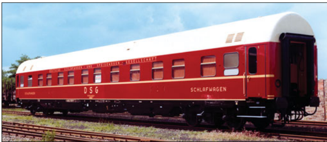
Schlafwagen DSG 51 80 06-80 318-4 WLABmh 33; Dach elfenbein, Wagenkasten purpurrot, Zierstreifen und Anschriften am Wagenkasten elfenbein, Langträgerverkleidung und Drehgestelle schwarz (Werkfoto 1972 Spandau)
