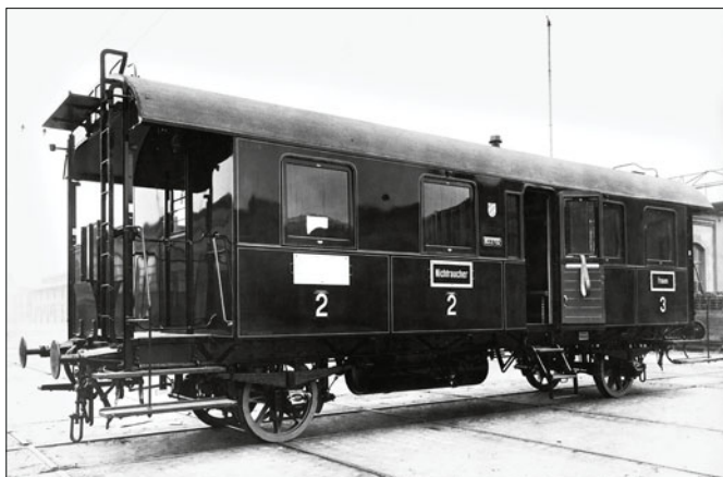
Oben links: Lokalbahnwagen Bayern 20642 CL; der Wagenkasten ist grün, Brüstungsleisten, senkrechte Deckschienen und Einfassungen sind schwarz mit weißen Absetzlinien, die Bezeichnung erfolgte durch Emailschilder mit schwarzer Schrift auf weißem Grund bzw. gelbe Anschriften mit schwarzen Schatten (Werkfoto 1906 München)
