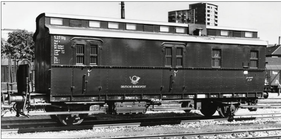
Bahnpostwagen DBP 527 Poste-b/9,7; Dach weißaluminium, Wagenkasten und Dachaufsatz seitlich flaschengrün, Brüstungsleiste und Rahmen schwarz (Foto Stuttgart 1960 Fritz Willke, Sammlung Carstens)
