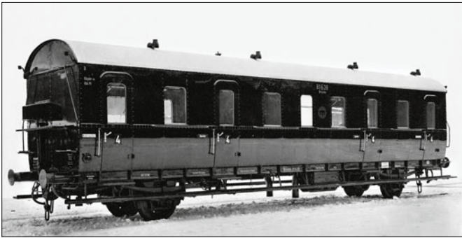
Abteilwagen DRB Dresden 81 638 D-27 (Werkfoto 1927 Görlitz) Der Einheitsabteilwagen wurde am 17. November 1927 abgenommen. Im Hauptanschriftenfeld fehlt noch die Angabe des Wagengewichtes, am Langträger das Datum für die nächste Untersuchung. In Wagenmitte ist der Reichsbahnadler angebracht. Das Nummernschild darüber enthält die Wagennummer ohne Unterstrich und mit der seinerzeit üblichen Form der Ziffer 6. Unter dem Reichsbahnadler befinden sich Kloben zur Aufnahme des Richtungsschildes. Auch hier sind mit Ausnahme der Dachkanten weder schwarze Absetzlinien noch schwarze Deckschienen zu erkennen. Der Wagenkasten ist braungrün, das Dach graualuminium, das Untergestell schwarz lackiert.
