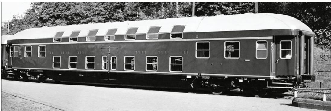
Doppelstock-Eilzugwagen DB 35 502 DBC4ymg-51; Dach und Zierstreifen weißaluminium, Wagenkasten stahlblau, Langträgerverkleidung und Schürzen schwarz (Werkfoto 1951 Kassel)
