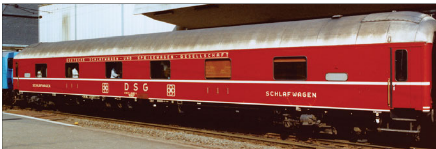
Schlafwagen DSG 61 80 71-81 887-5 WLABümh 33; Dach, Zierstreifen und Anschriften elfenbein, Wagenkasten purpurrot, Langträgerverkleidung und Schürzen schwarz (Foto Koblenz 1977 Gerhard Krauth)
