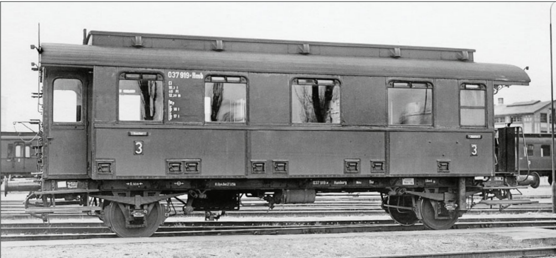
Durchgangswagen DB 037 919x Ci (ehemals B Ci Pr 05); Wagenkasten flaschengrün, Rahmen und Fahrwerk schwarz; das liegende Kreuz (x) kennzeichnet die Betriebsnummer als Abweichung vom Nummernplan (Foto 1956 Rudolf Klitscher)
