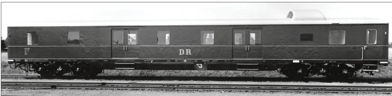
Gepäckwagen DR 650-001 Pw4üe, Wagenkasten flaschengrün, Brüstungsstreifen, Einfassungen und Langträgerverkleidung schwarz, Zierstreifen elfenbein, Dach hellgrau, Schürzen schwarz; Anschriften am Wagenkasten und an der Langträgerverkleidung überwiegend elfenbein, bemerkenswert auch hier das Eigentumszeichen DR für Probewagen (Werkfoto 1959 Bautzen)
