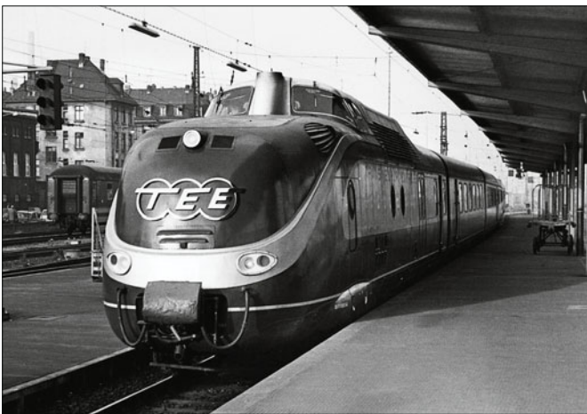
Oben links: Schnelltriebwagen DB ET 11 03; Dach und Schürzen dunkelgrau, Wagenkasten graublau, Fensterband und Zierstreifen steingrau (Werkfoto um 1955 AEG)
