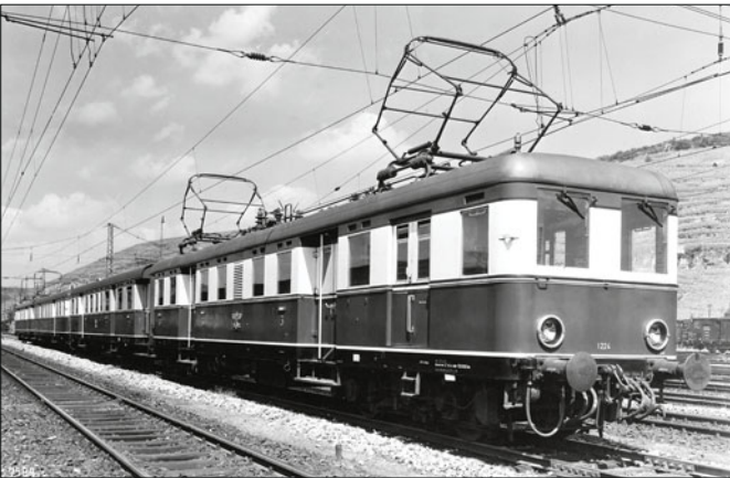
Elektrotriebwagen DRB 1224+2224 CPw4ieIT-37+BC4ieIS-37 (ET+ES 65); Wagenkasten im Bereich der Fenster 2. Klasse blaugrün, 3. Klasse beige, sonst weinrot, Langträgerverkleidung schwarz, Zierstreifen blaugrün bzw. beige (Werkfoto 1939 Esslingen)
