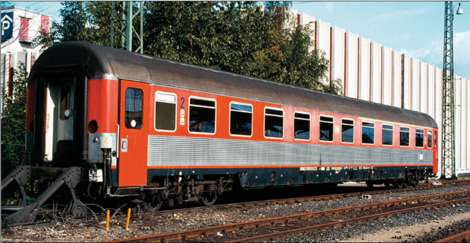
Schnellzugwagen DB 61 80 30-70 001-6 ABvmz 227; Fensterband und Türen blutorange, Wagenkasten unterhalb der Fenster blank, Dach bereits umbragrau, Schürzen graubraun (Foto Oppum 1984 Werner Ballon)
