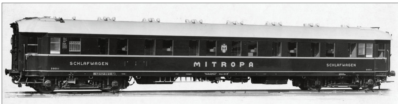
Schlafwagen Mitropa 39011 WLAB4ü, Wagenkasten rot, Zierstreifen gelb, Langträgerverkleidung schwarz, Dach beige, Anschriften gelb (Werkfoto 1937 Deutz)
