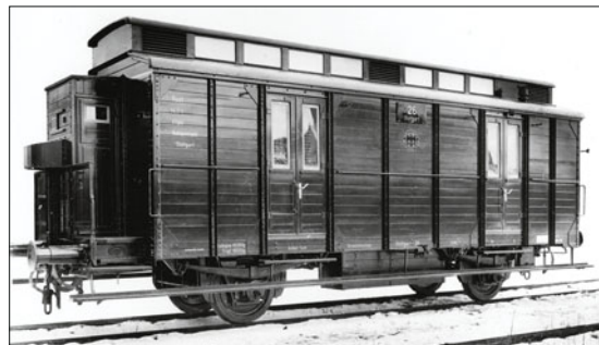
Bahnpostwagen DRP Stuttgart 26 Post c/8,5 mit grünem Wagenkasten, Bremserhaus und Dachaufsatz, schwarzem Rahmen (Werkfoto 1931 Esslingen)
