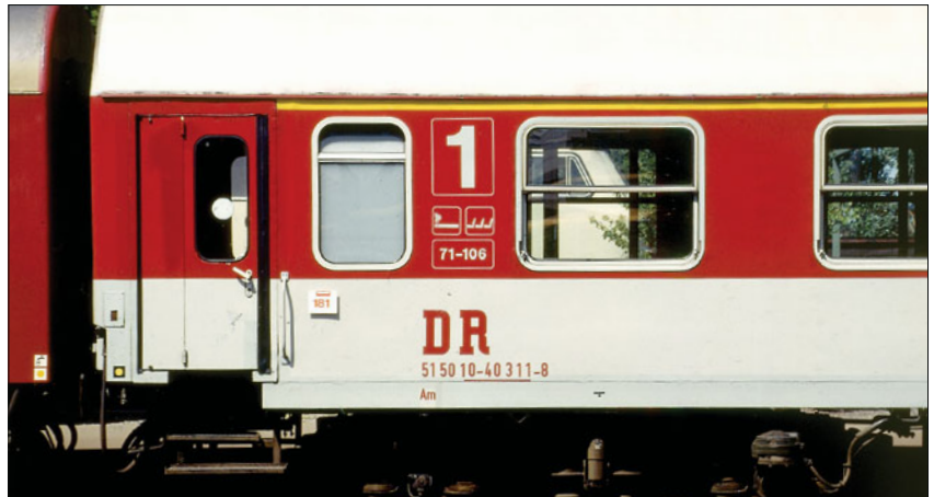
Schnellzugwagen DR 51 50 10-40 311-8 Am 2128; Dach und unterer Teil des Wagenkastens birkengrau, Fensterreihe bordeaux, Kennzeichnungsstreifen chromgelb (Foto Wolfsburg 1992 Hans Ulrich Diener)
