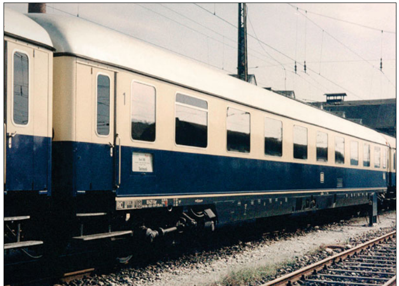
Rechts: Schnellzugwagen DB 10 421 Av4üm-62; Dach weißaluminium, Dachkanten schwarz, Langträgerverkleidung und Schürzen schwarzgrau, Wagenkasten beige und kobaltblau, Zierstreifen beige (Foto um 1962 Sammlung Wolfgang Bündgen)
