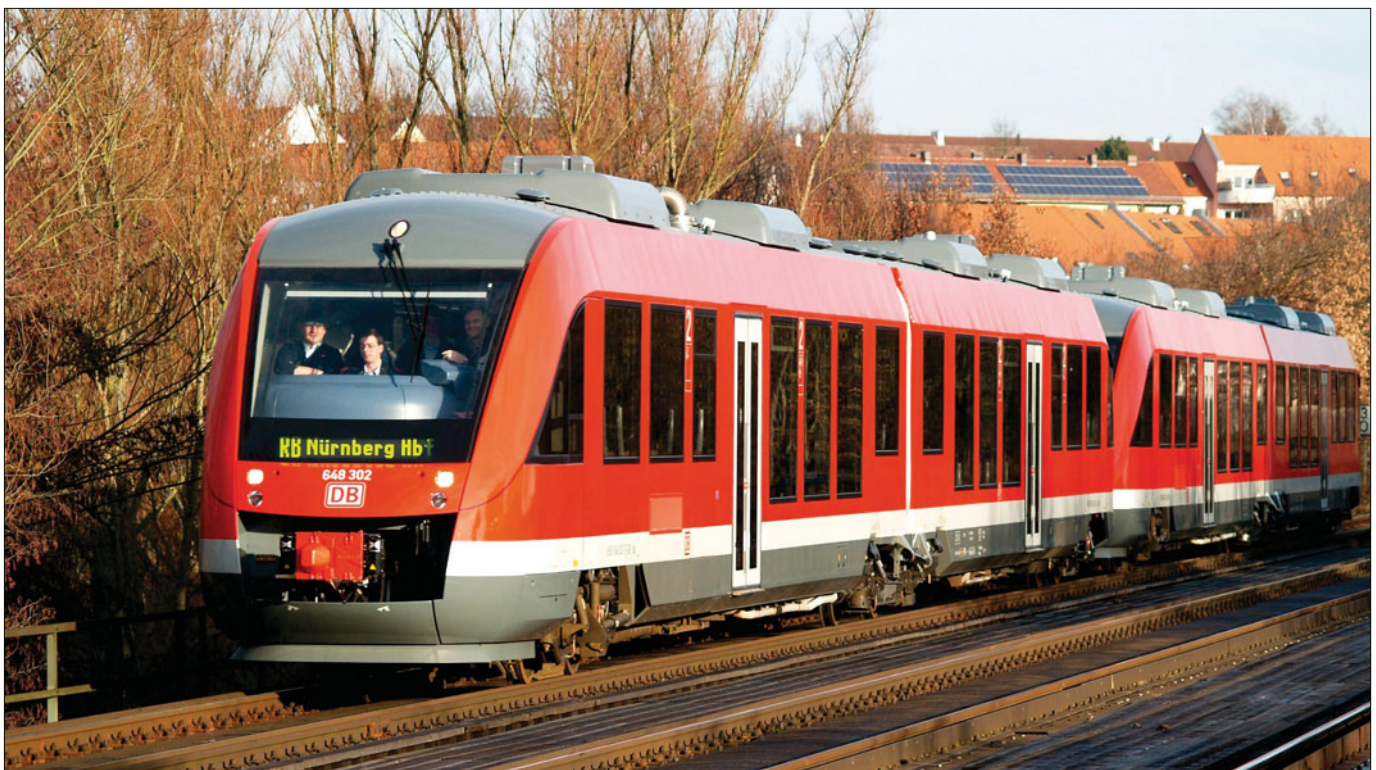
Verbrennungstriebwagen DB AG 648 302-8 mit Betriebsnummer ohne Kontrollziffer an der Stirnseite (Foto Mittelfrankenbahn 2008, DB AG/Klaus Weber)
