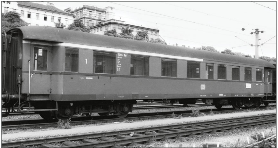
Eilzugwagen DB 33 651 AB4yse-37/50; Wagenkasten chrom- oxidgrün, Brüstungs- leisten und Lang- trägerverkleidung schwarz; Kennzeich- nungsstreifen elfen- bein (Foto Wien um 1967 Hermann Heless)
