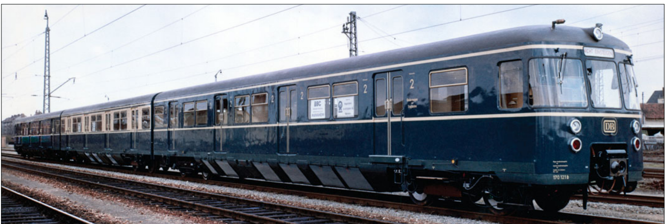
Unten: S-Bahn-Triebwagen DB ET 170 121; Dach graublau, Wagenkasten graublau und beige, Zierstreifen beige, Langträgerverkleidung dunkelgrau (Werkfoto 1959 Nürnberg)
