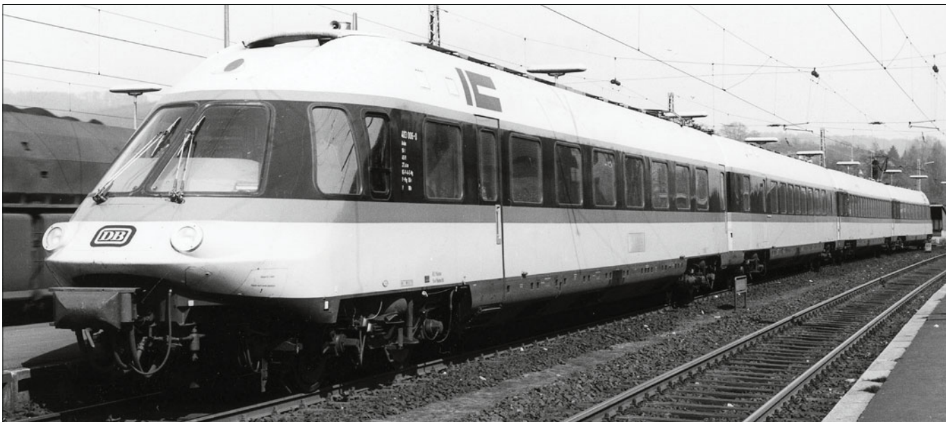
Oben: Intercity-Triebzug 403 006-0; Dach- und Wagenkasten kieselgrau, Fensterband dunkelbraun, Zierstreifen orange, Untergestell schwarzgrau (Fo- to Brackwede 1974 Richard Schulz)
