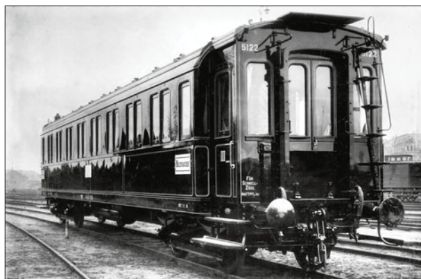
Schnellzugwagen Pfalz 5122 CCü; Wagenkasten grün, Brüstungsleisten, Deckschienen und Langträgerverkleidung schwarz, Absatzlinien weiß, Anschriften gelb (Werkfoto 1898 Nürnberg)
