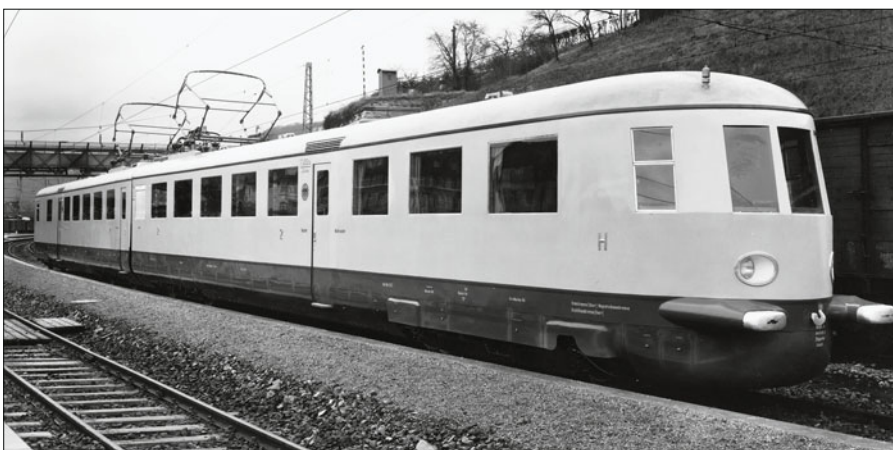
Elektrotriebwagen DRB 1900 BPw4ük+ B4üe eIT-35 (ET 11) mit Anstrich in beige am Wa- genkasten und weinrot an der Langträger- verkleidung und den Schürzen (Werkfoto 1935 Esslingen)
