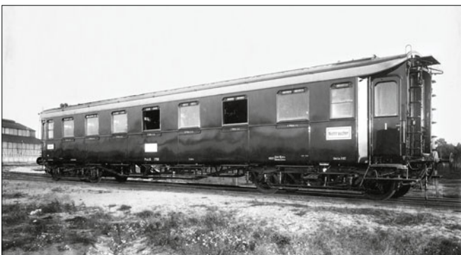
Schnellzugwagen Pfalz CCü 1732; Wagenkasten grün, Langträgerverkleidung, Brüstungsleisten und Deckschienen schwarz, Absetzlinien weiß, Anschriften gelb (Werkfoto 1907 Nürnberg)
