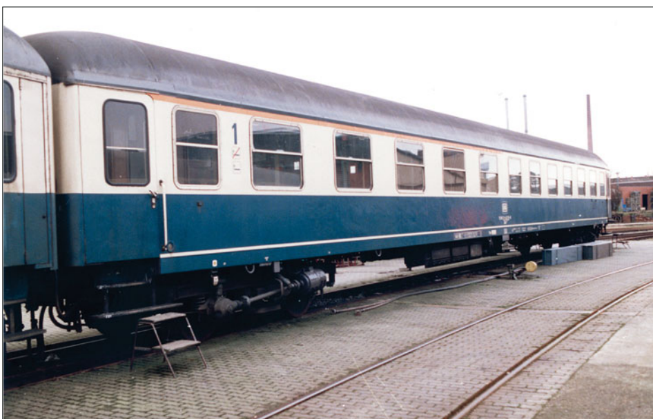
Schnellzugwagen DB 51 80 31-41 315-8 ABm 223, Dach umbragrau, Kennzeichnungsstreifen goldgelb, Wagenkasten elfenbein und ozeanblau, Zierstreifen elfenbein, Langträgerverkleidung ozeanblau, Rahmen und Drehgestelle graubraun
