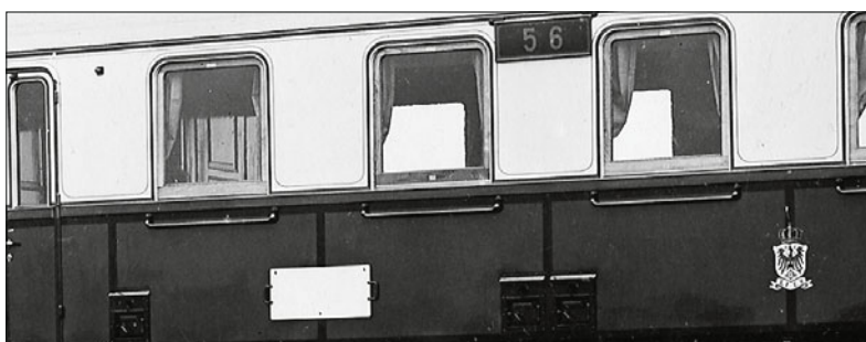
Speichertriebwagen Preußen Saarbrücken 55+56 AT 2 (Ausschnitt aus Bild ganz oben); im elfenbeinfarbenen Bereich sind die Einfassungen noch von einer haarfeinen schwarzen Zierlinie begleitet, die Türen zu den Presskohlenöfen sind schwarz gestrichen
