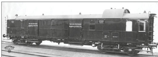
PPü Magdeburg 05861 der Deutschen Reichsbahn; gegenüber Bild Seite 129 oben wurde die Eigentumsbezeichnung auf den La- detüren in „Deutsche Reichsbahn“ geändert, ein Nummernschild mit Angabe des Eigentumsbezirks ist hinzugekommen (Werkfoto 1923 Görlitz)
