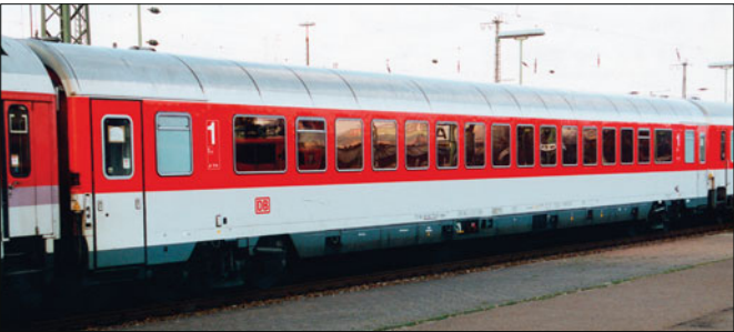
Schnellzugwagen DB AG 73 80 18-90 779-5 Apmz 117.0; Dachtonsur fenstergrau, Vouten, Wagenkasten unter den Fenstern lichtgrau, Fensterband verkehrsrot, Langträgerverkleidung basaltgrau, Rahmen und Drehgestelle schwarz (Foto Herford 2000 Richard Schulz)
