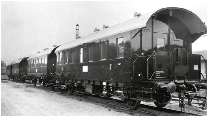
Durchgangswagen DRB Essen 41525 Ci-28 (Werkfoto 1928 Ra-statt); Wagenkasten braungrün, Brüstungsleisten und Einfassungen schwarz, die Blechflächen am Bühnengeländer grün wie der Wagenkasten
