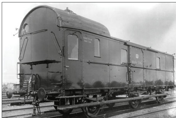
Gepäckwagen Preußen Münster 3382 P; Wagenkasten grün; das Dach ist mit dunkelgrauem Ruberoid 36 eingedeckt, das keinen Anstrich erhalten hat (Werkfoto 1918 Mombach)
