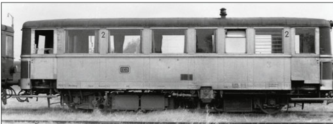
Links: Verbrennungstriebwagen DB VT 70 971; Wagenkasten und Langträgerverkleidung ohne Farbanstrich, Kontrastflächen purpurrot (Foto 1959 Carl Bellingrodt, Sammlung Emil Konrad)
