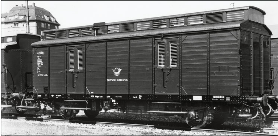
Bahnpostwagen DBP 426 Poste-c/10; Dach weißaluminium, Wagenkasten und Dachaufsatz seitlich flaschengrün, Rahmen schwarz (Foto Stuttgart 1960 Fritz Willke, Sammlung Carstens)
