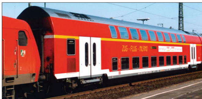
Nahverkehrswagen DB AG 50 80 16-75 001-2 DApza 759.5; Dach und Langträgerverkleidung basaltgrau, Dachvouten und Wagenkasten verkehrsrot, Zierstreifen und Türen lichtgrau; Kennzeichnungstreifen goldgelb (Foto Herford 2003 Richard Schulz)
