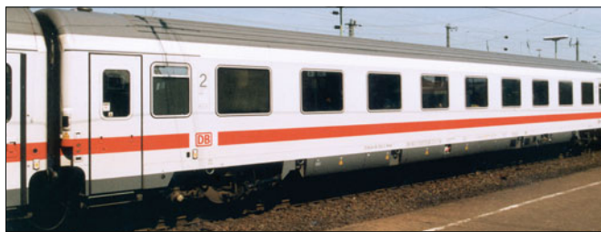
Schnellzugwagen DB AG 61 80 84-90 902-2 Bvmkz 856; Dach und Langträgerverkleidung basaltgrau, Dachvouten und Wagenkasten lichtgrau, Zierstreifen verkehrsrot, Rahmen und Drehgestelle schwarz (Foto Herford 2003 Richard Schulz)
