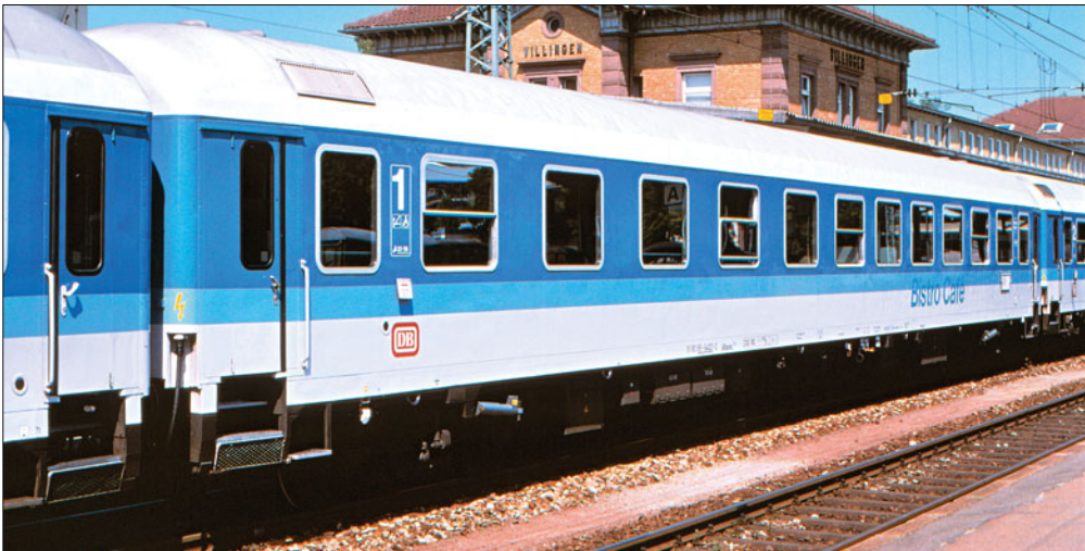
Interregio-Wagen DB 51 80 85-94 021-2ARKimbz 262.2; Dach fenster- und lichtgrau, Wagenkasten und Langträgerverkleidung lichtgrau, Fensterband fernblau, Begleistreifen pastellblau, Drehgestelle graubraun (Foto Villingen 1990 Rolf Köstner)
