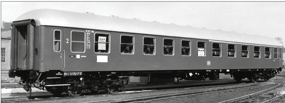
Schnellzugwagen DB 15 167 AB4üm-61; Dach weißaluminium, Wagenkasten chromoxidgrün, Langträgerverkleidung schwarz; Kennzeichnungsstreifen elfenbein (Werkfoto 1963 Nürnberg)
