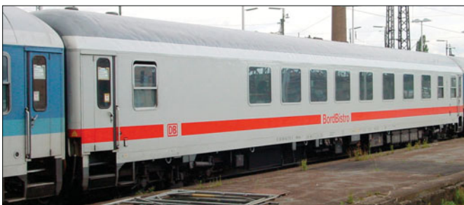
Schnellzugwagen DB AG 61 80 85-95 072-3 ARkimbz 262.6; Dach basaltgrau, Dachvouten und Wagenkasten lichtgrau, Zierstreifen verkehrsrot, Rahmen und Drehgestelle schwarz (Foto 2001)
