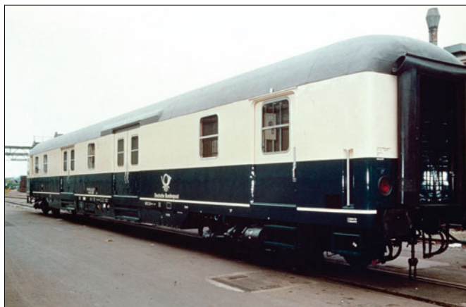
Bahnpostwagen DBP 50 80 00-33 415-3 Postmr-ap/26; Dach umbragrau, Wagenkasten und Langträgerverkleidung ozeanblau, Fensterband und Zierstreifen elfenbein, Posthorn von 1951 und Schrift „Deutsche Bundespost“ in Helvetica elfenbein (Werkfoto 1978 Sammlung DBP)
