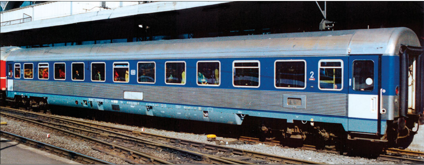
Schnellzugwagen DB 61 80 21-70 001-7 Bvmz 237; Dachmitte umbragrau, Dachvouten und Wagenkasten unterhalb der Fenster metallisch blank, Fensterband und Zierstreifen kobaltblau, Türen unten lichtgrau, Schürzen eisengrau (Foto Koblenz 1977 Gerhard Krauth)
