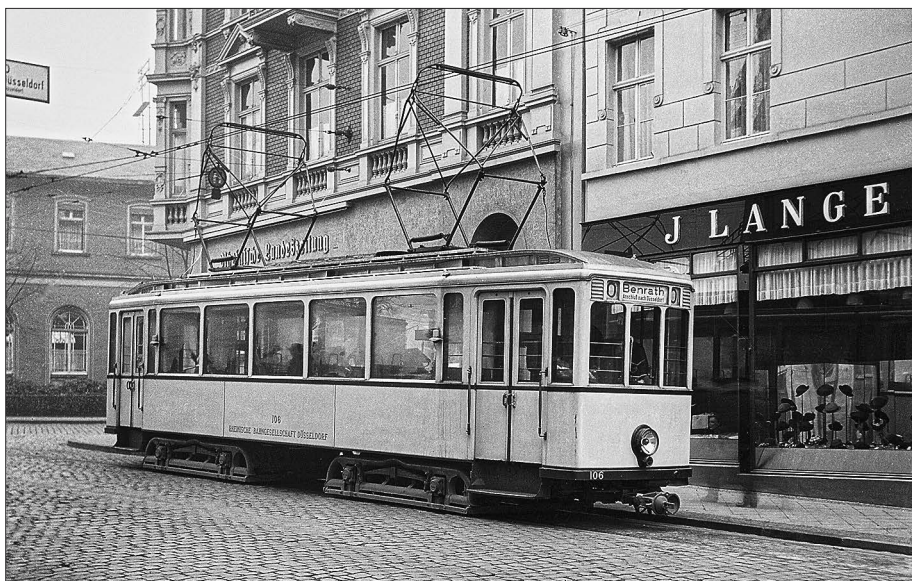
Tw 106 der Hauptserie steht 1938 an seiner Endstation für die Fahrgäste in der Düsseldorfer Straße in Ohligs. Im Hintergrund das Empfangsgebäude des Bahnhofs. Nunmehr gibt es zwei Scherenstromabnehmer und eine automatische Scharfenbergkupplung
