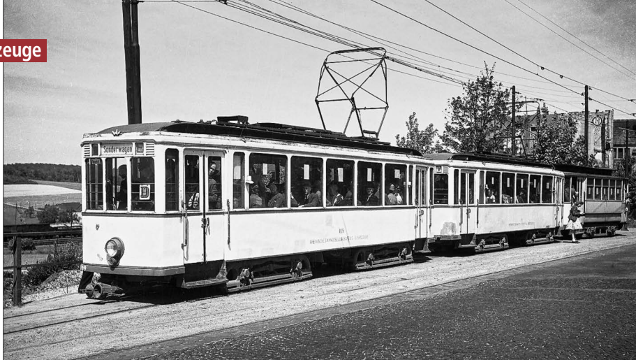
1949 zeigten sich die Triebwagen wegen Materialmangel nur mit einem Stromabnehmer. Bei starkem Verkehrsaufkommen wurden so genannte Doppelwagen eingesetzt, die dem Linienzug voraus fuhren – das „D“ am Stirnfenster weist darauf hin
