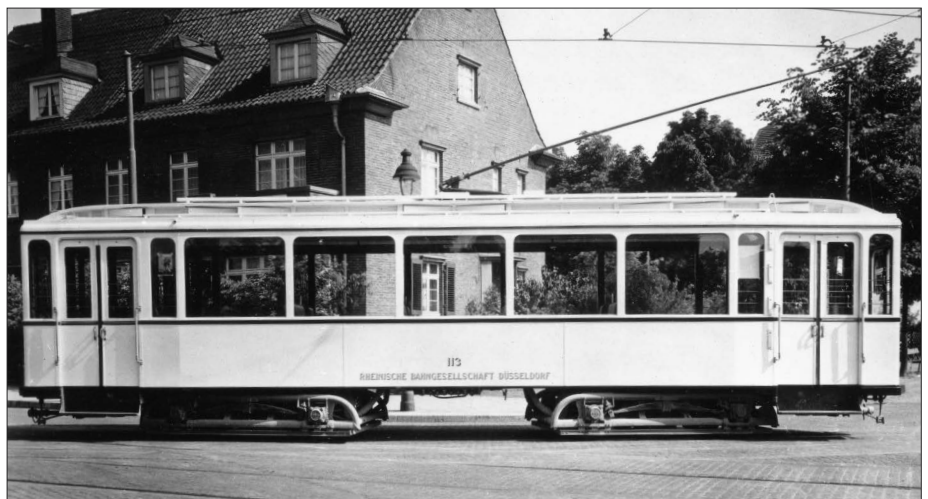
Die Seitenansicht des Tw 113 gibt den Lieferzustand von 1935 wieder. Gut zu erkennen sind die Dachpartie mit Stangenstromabnehmer und Lüftungsklappen, aber auch die Stahlrohr-Drehgestelle
