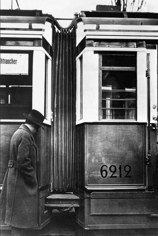
Eines der wenigen Bilder, das den zweiten Gelenkwagen 6212 zeigt, dokumentiert die Gelenkverbindung zum frei schwebendem Mittelteil SLG. PAUL-H. PRASUHN, ARCHIV AXEL REUTHER (2)
