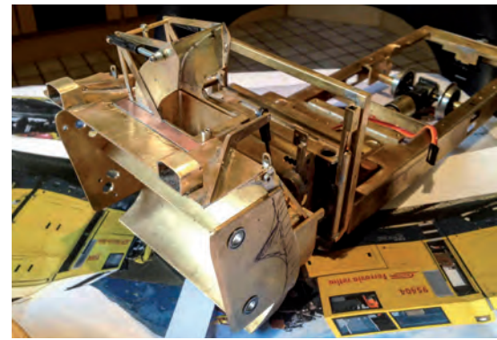
Der Gehäuserahmen ist aus Messing und aus Wartungsgründen mit nur einer Schraube mit dem Räumwerk verbunden. Der massive hintere Teil des Rahmens dient als Gegengewicht zum Räumwerk.
