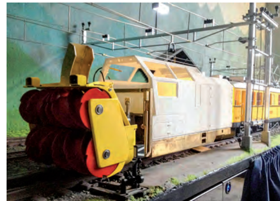
Alles passt: Räumwerk und Fräswalzen sind fast fertig. Gehäuserahmen und Gehäuse sind noch im Rohbau. Jetzt kann der ABe 4/4 I zur ersten Profelfahrt ausrücken, um zu prüfen, ob er auf der Gartenbahnstrecke genügend Platz hat.
