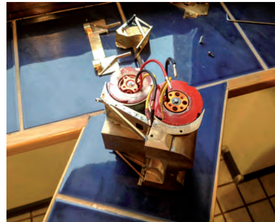
Außenläufer: Hier ist der Walzenantrieb gut zu sehen. Die Befestigung erfolgt dann durch die Lagerplatte außen.
