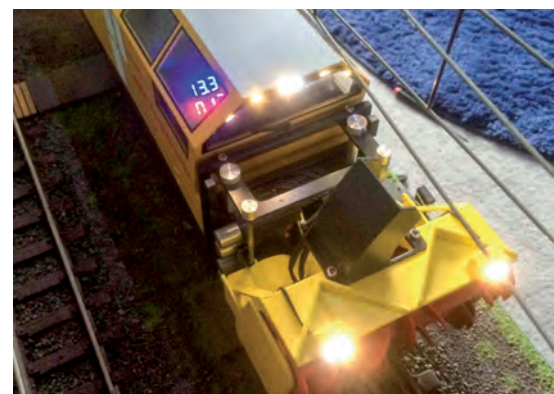
Alles passt: Räumwerk und Fräswalzen sind fast fertig. Gehäuserahmen und Gehäuse sind noch im Rohbau. Jetzt kann der ABe 4/4 I zur ersten Profelfahrt ausrücken, um zu prüfen, ob er auf der Gartenbahnstrecke genügend Platz hat.
