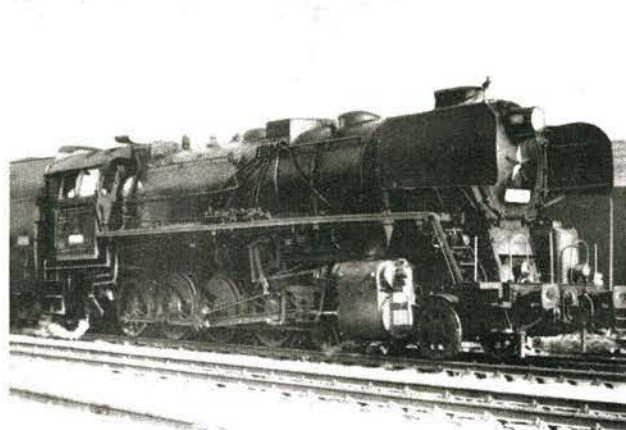
Bild 5 Skoda baute von 1950 bis 1955 diese sehr schöne 2'D1-Schnellzuglokomotive, die vor der Elektrifizierung die Hauptlast auf den Hauptstrecken der ČSD zu tragen hatte. Am 27. August 1964 erreichte eine Maschine dieser Reihe 498.1 — und zwar die 498.106 — mit einem Versuchswagen der MAV auf dem ČSD-Versuchsring bei Velim eine Geschwindigkeit von 162 km/h. Die L ü P dieser Lokomotive beträgt 25 569 mm, die Kuppelräder haben einen Durchmesser von 1830 mm, die vorderen Laufräder einen solchen von 880 mm und die Schleppachsräder einen von 1150 mm. Die Rostfläche mißt 4,85 m 2 , und die Dienstmasse beträgt 113,5 t, die vorgesehene V_{\max} ist 120 km/h.
