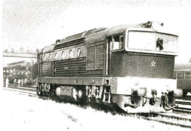
Bild 7 Eine in verschiedenen Dienst- arten auf den ČSD-Strecken häufig anzutreffende Diesellokomotive ist die der Reihe T 478.3, scherzhaft wegen ihres Aussehens auch als „Brillenschlange“ bezeichnet. Die Achsfolge ist BôBô, die Leistung beträgt 1800 PS, Herstellerwerk ist ČKD Prag.
