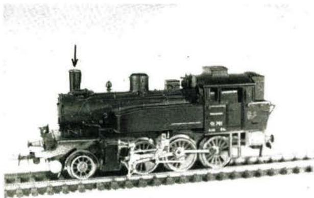
Bild 45 Das H0-Modell der BR 91 von der Seite gesehen. Der Pfeil deutet auf die Gehäusehalteschraube hin.
