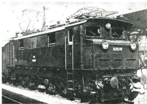
Bild 2 (1A) Bo (1A) — Schnellzuglokomotive 1670.09 der ÖBB, Baujahr 1927.
