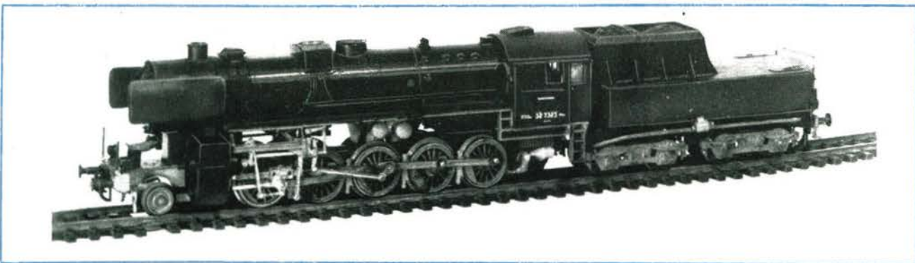
Die fertige Lok 52 7323 ist mit dem Wannentender 2'2'T30, der noch beschriftet werden muß, gekuppelt. Zeichnungen und Fotos: Verfasser
