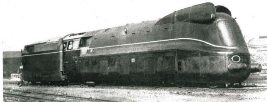
Alle Maschinen hatten ursprünglich Stromlinienverkleidung. Von den Loks der beiden deutschen Bahnver- waltungen wurde diese Ausrüstung nach dem zweiten Weltkrieg entfernt.
