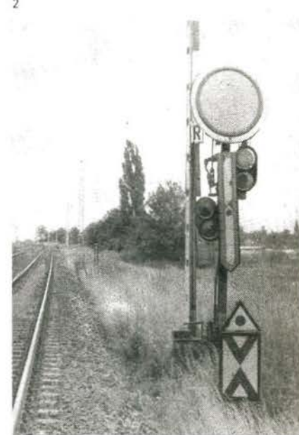
1 Zweibegriffiges Formvorsignal in Stellung Vf 0 und Vorsignaltafel So3a (als Nachtzeichen eine Laterne)
