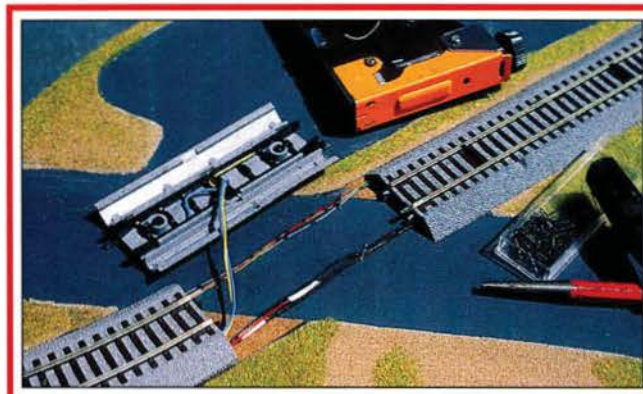
Die Kabelverlegung unter dem Schotterbett der Gleise gelingt, wenn man auf sperrige Pertinaxplättchen verzichtet.
