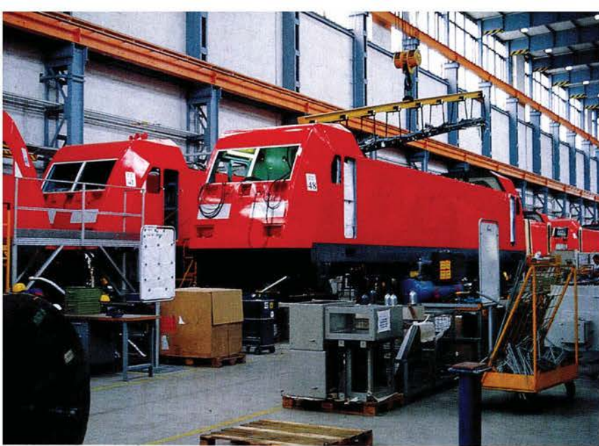
Im Adtranz-Werk Kassel wird die Baureihe 101 montiert. Etwa zwei Maschinen verlassen pro Woche die traditionsreichen Hallen.
