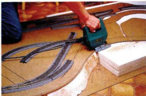
Mit der Stichsäge gestaltet der Bastler die Böschungen entlang der Trasse aus. Die steilen Böschungen sind begrünt nicht wiederzuerkennen.
