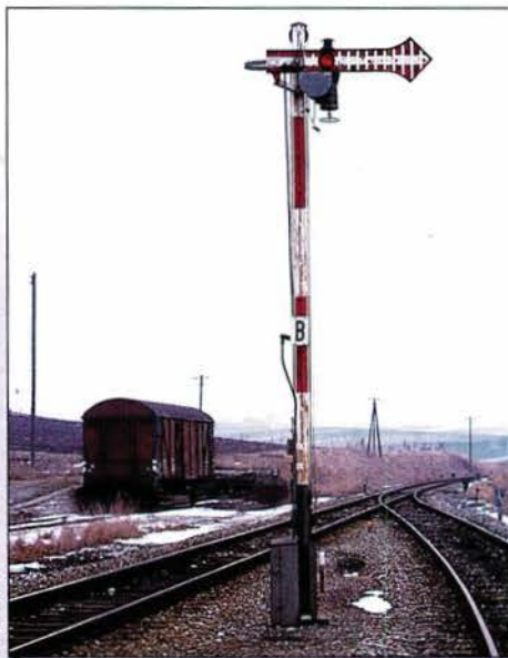
Auch für Lichtsignale wurden Signalausleger angefertigt. Der im thüringischen Rottenbach ist heute noch in Betrieb.
