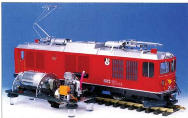
11. Bei Kiss liefert ein Diesel-Aggregat der Gem 4/4 Strom.
