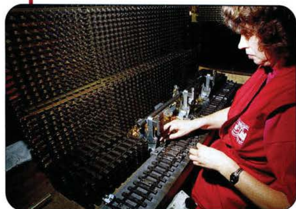
Gleisbau: Automatisch schiebt die Maschine die Messingprofile in die Plastikschwellen.
