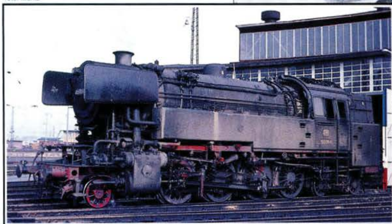
Gut zu erkennen bei 65015: Leitung der Wendezugsteuerung über vierter Kuppelachse und hinter der Trittleiter.
