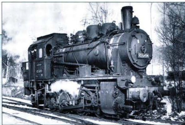
Die 92 6494 besaß eine Riggenbach-Bremse.
