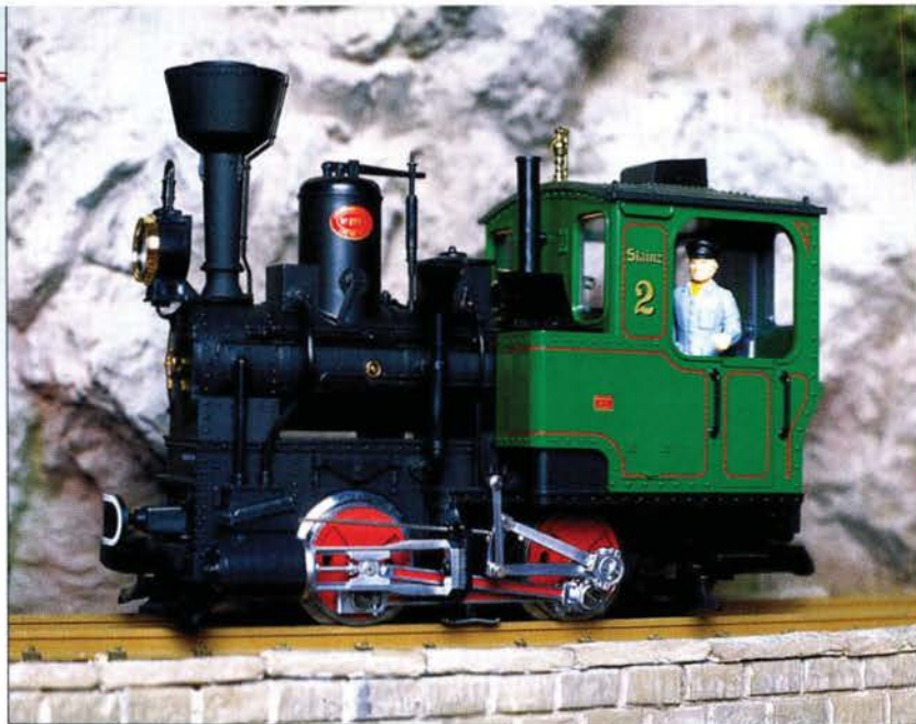
Standard 1998: Die Stainz 2 mit vollständig nachgebildeter Allan-Trick-Steuerung.
