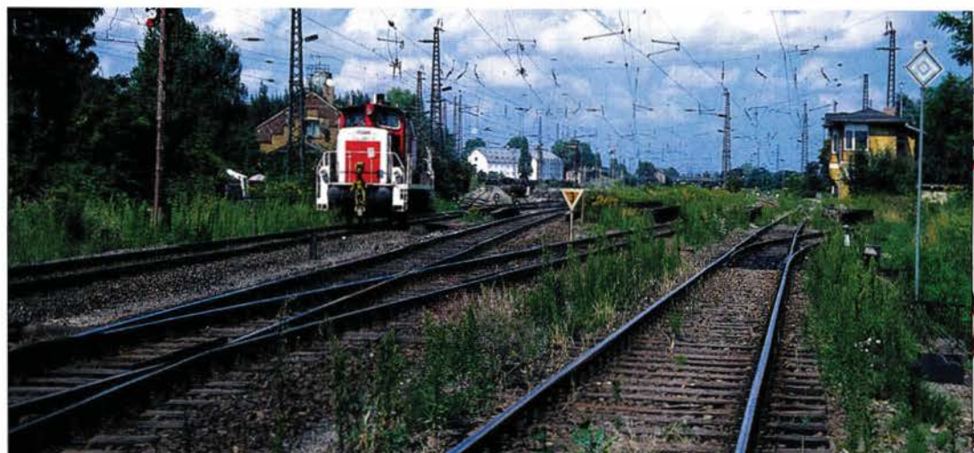
Ausfahr- und Blocksinal vor der Abzweigung nach Engelsdorf stehen so dicht, daß sie abhängig geschaltet sind.
