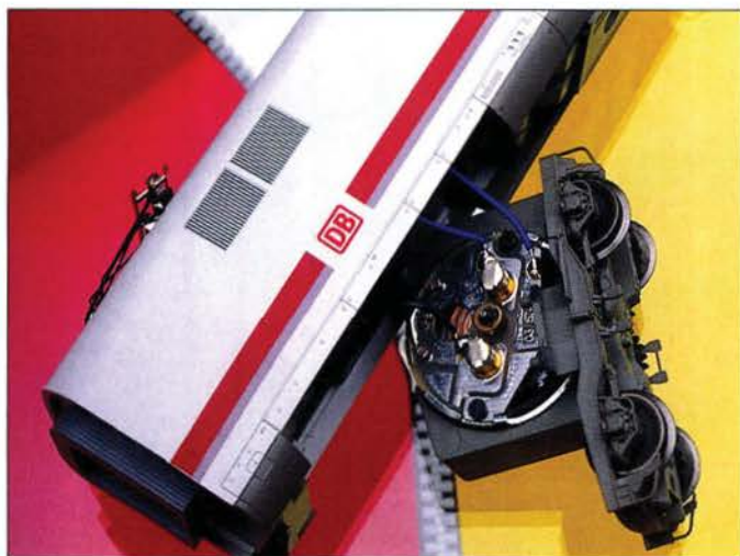
Altbekannte Fahrzeugtechnik: Im hinteren Drehgestell des ICE-Triebkopfes sitzt im Modell der dreipolige Rundmotor aus dem Hause Fleischmann.
