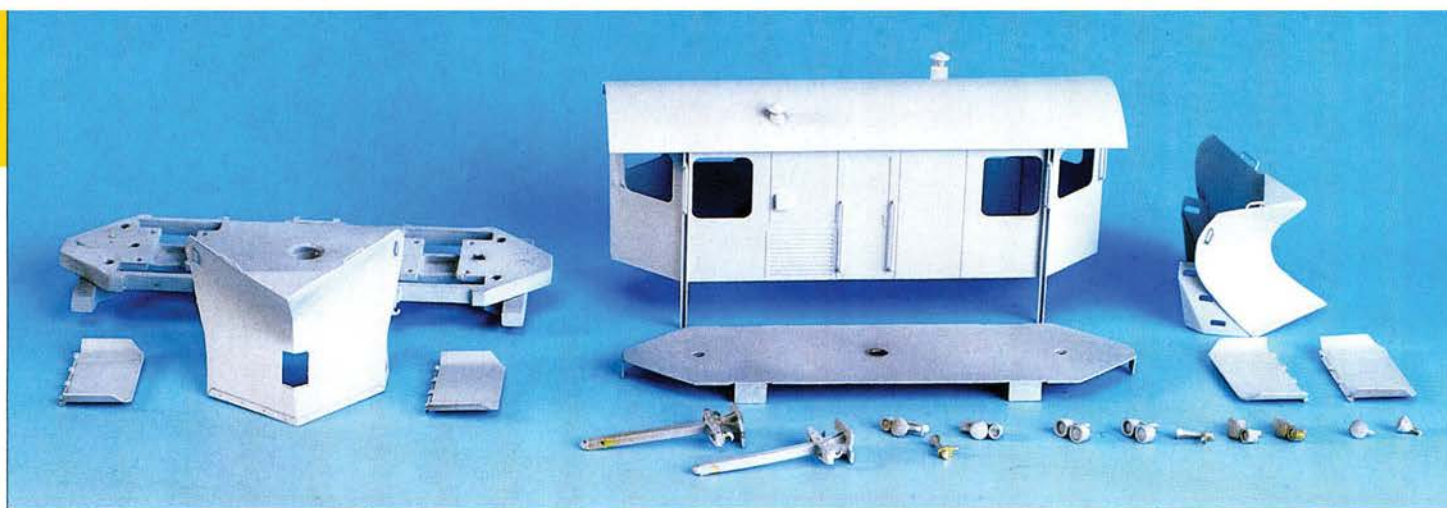
Fertig grundiert, aber noch nicht lackiert: Die Einzelteile des Schmalspur-Schneepfluges der DR von Spieth.
