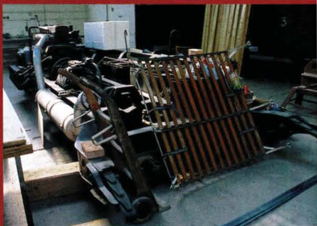
Tauschmotor: Im Fahrgestell des VT 70921 sitzt jetzt eine Deutz-Maschine aus einer Köfl.
