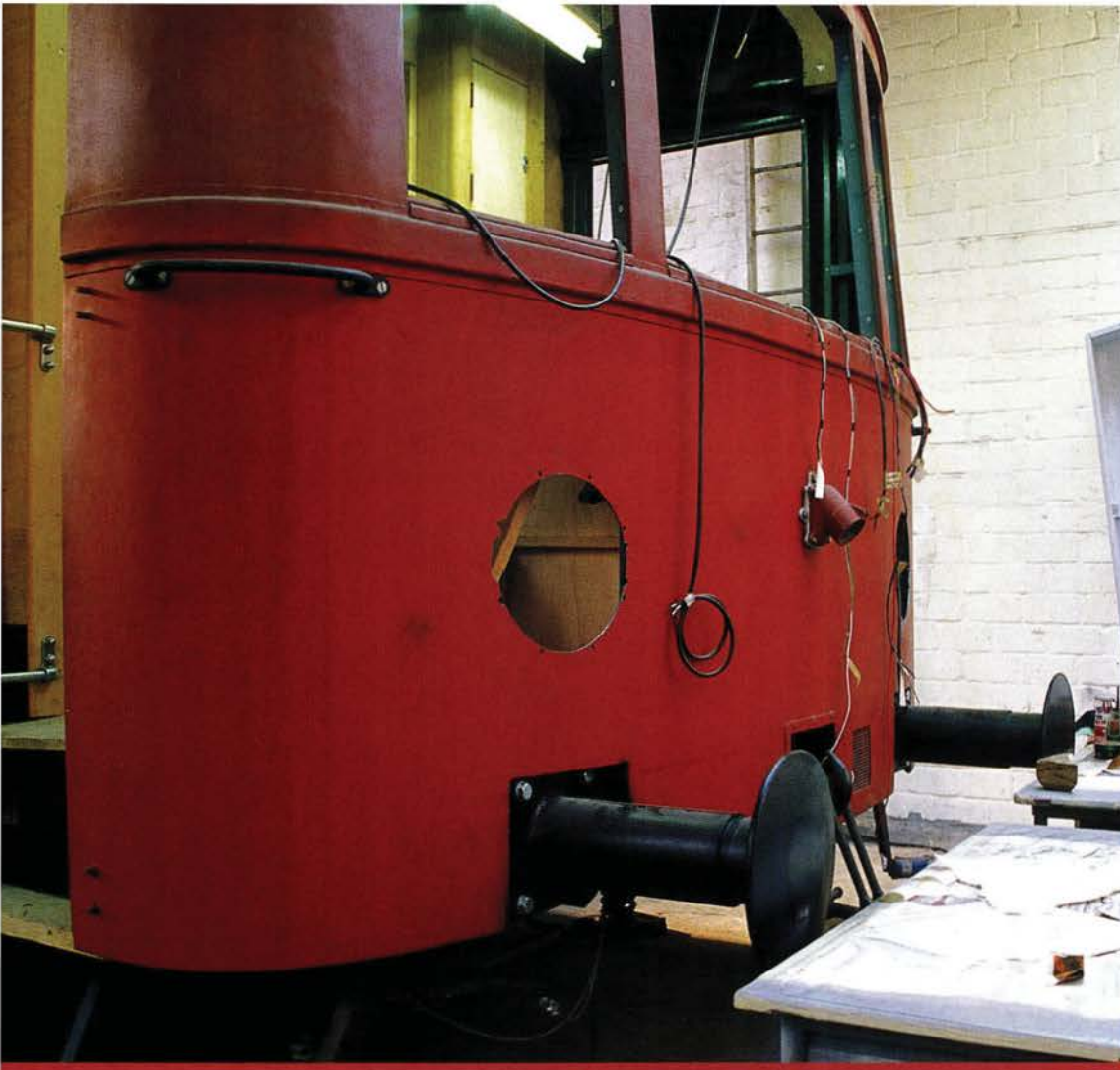
An der Außenseite erhielt der Triebwagen aus Darmstadt eine neue Beplankung.
