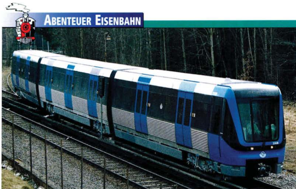
„Wagen 2000“: Die dreiteilige Wendezug-Grundeinheit ist 46,5 Meter lang und für maximal 414 Passagiere zugelassen.
