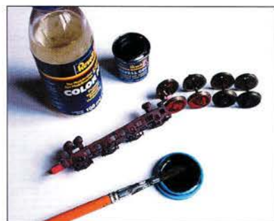
Die Radsätze und Drehgestellblenden erhalten einen gleichmäßigen Überzug aus verdünnter mattschwarzer Farbe.
