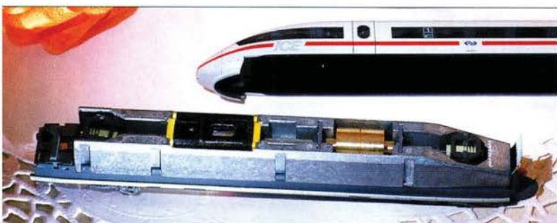
Die große Messingschwungmasse sorgt bei jeder Geschwindigkeit für eine ruckfreie Fahrt, das Druckgußteil für eine gute Traction.
