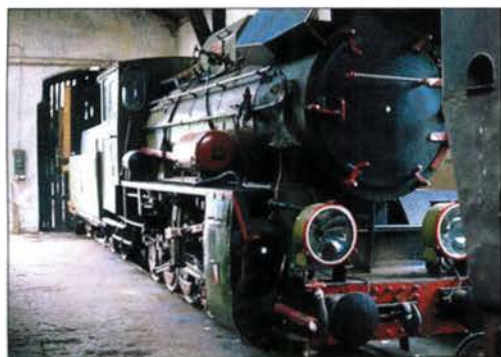
Die Pw 53 im Lokschuppen von Rudy (Rauden) entstand durch einen aufwändigen Umbau aus einer Tw 53.
