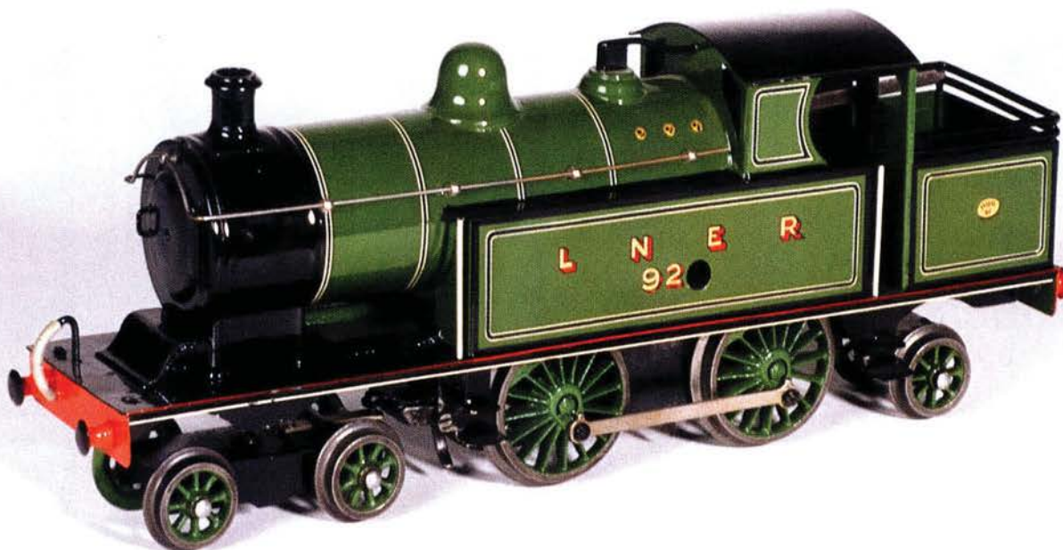
Märklin-Tenderlok mit Uhrwerkantrieb, gefertigt in den ersten Jahren der Weimarer Republik, restauriert, nur die Stirnlampen fehlen.
