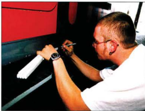
Mit Zollstock und Bleistift: Der Ansatz für die untere Folienbahn wird ausgemessen und markiert.
