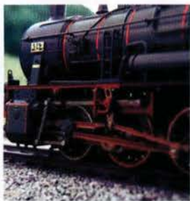
Alle vier Kuppelachsen sind vorbildgerecht angetrieben. Der Bildausschnitt lässt erkennen, wie filigran Fahrgestell und Steuerung umgesetzt sind.
