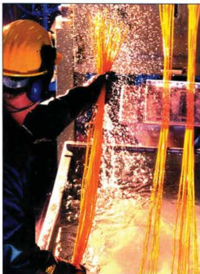
Makrolonproduktion: Die anfallenden Stäbe werden zu Granulat zerkleinert.
