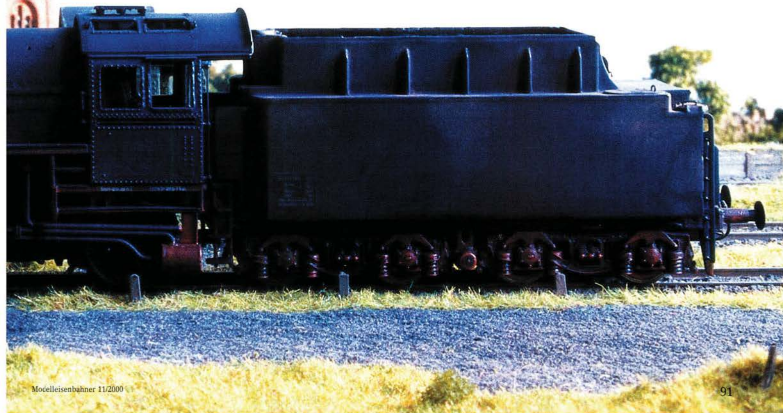
Die Radsätze und Drehgestellblenden erhalten einen gleichmäßigen Überzug aus verdünnter mattschwarzer Farbe.
