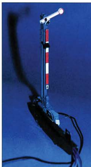
Mit einem Arnold-Weichenantrieb repariertes N-Signal.
