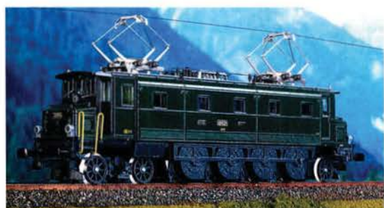
10 Ein Klassiker unter den Schweizer Lokomotiven ist die Ae 4/7 mit Buchliantrieb.
