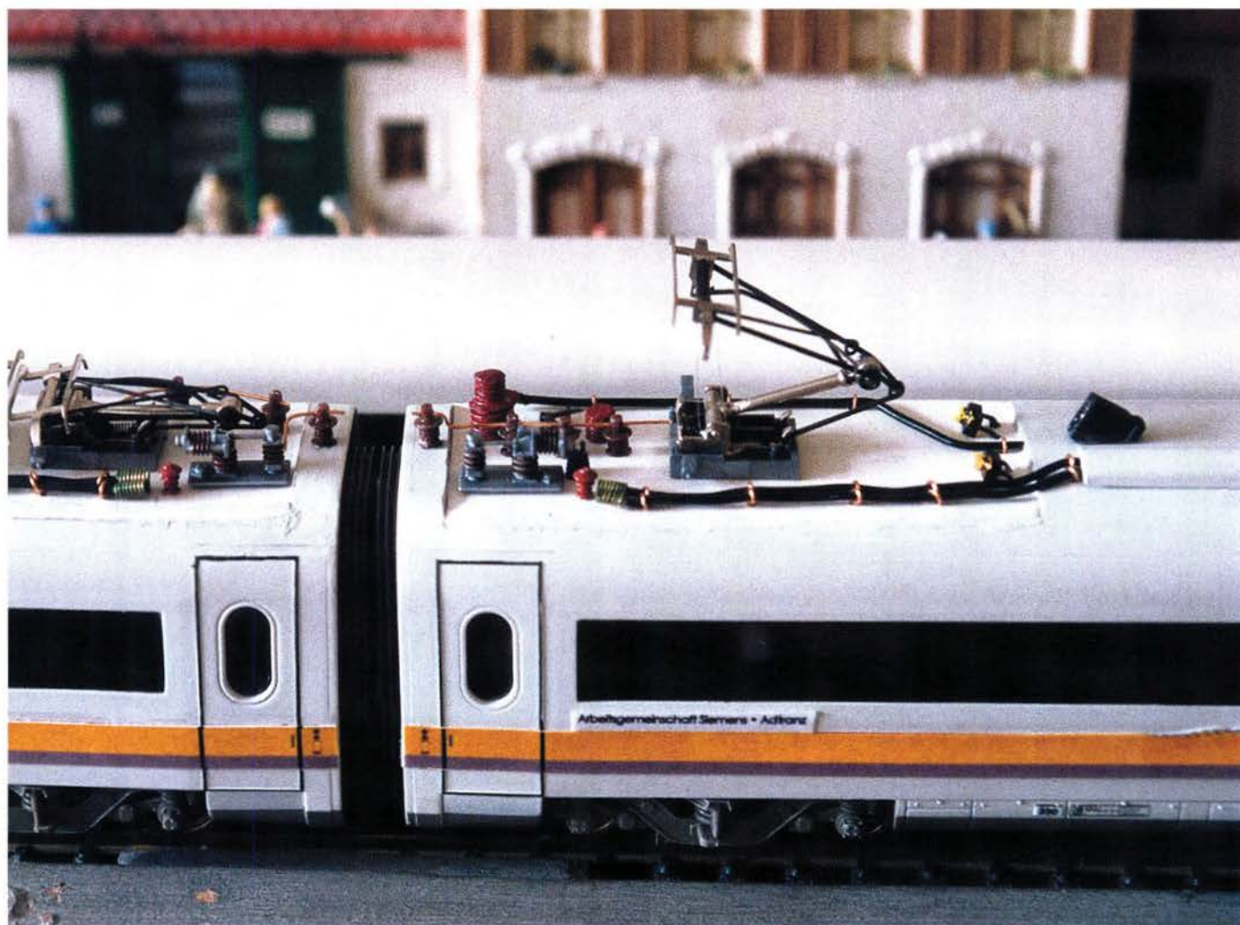
Hinter dem angelegten Stromabnehmer sind deutlich die beiden Dioden zu erkennen, die der Kamera das nötige Licht geben.
