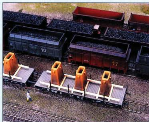
Kokswagen mit erhöhten Ladewänden (2. Reihe von unten) und davor die Kokillwagen für den Flüssigeisentransport.
