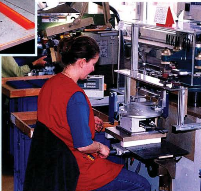
Diese neue Tampondruckmaschine erleichtert die Arbeit, indem sie in einem Arbeitsschritt bis zu fünf Druckvorgänge erledigt.
