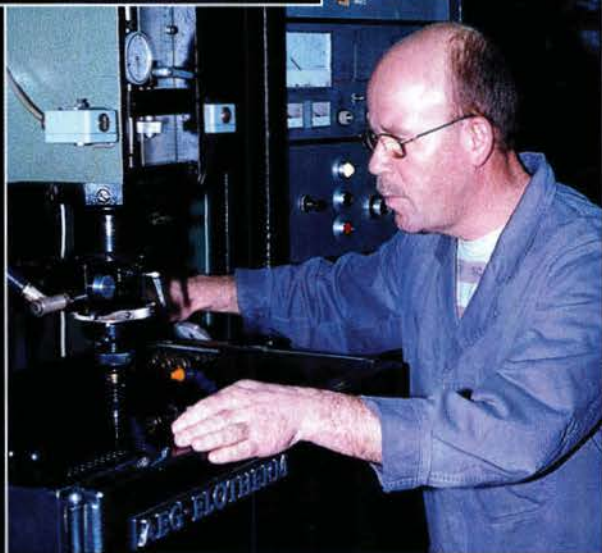
Die Einstellung der Maschine zum Erodieren einer Bohrung mit einem Durchmesser von einem Millimeter erfordert bei einer Toleranz von 1/300 Millimeter hohe Präzision.
