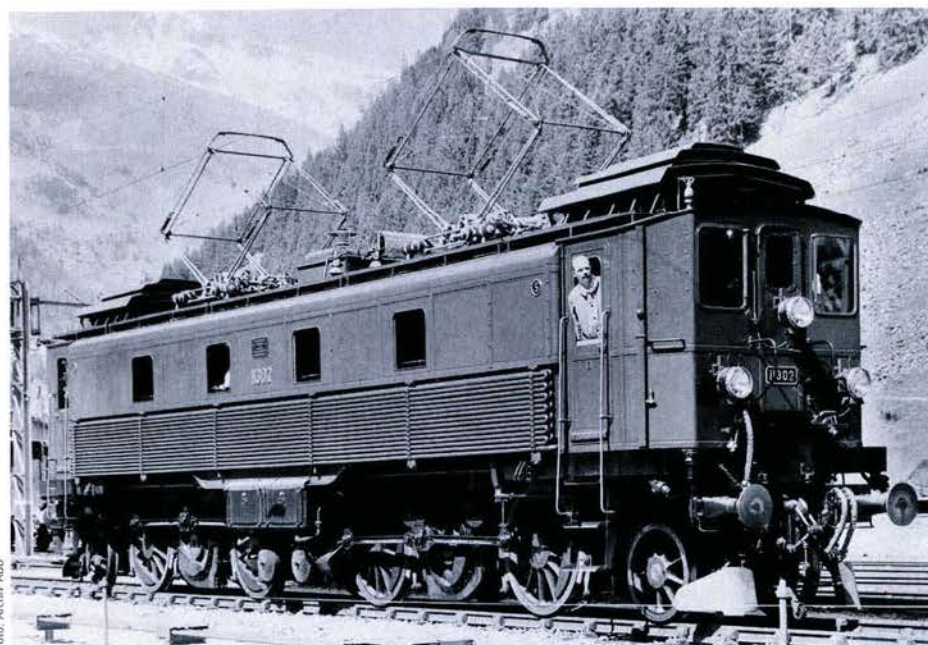
Die 1919 fertiggestellte Probelokomotive Be 4/6 11302. Sie wurde später zur 12302 umnummeriert, hatte noch kleinere Treibräder mit einem Durchmesser von 1350 mm und wurde 1965 ausgemustert.
