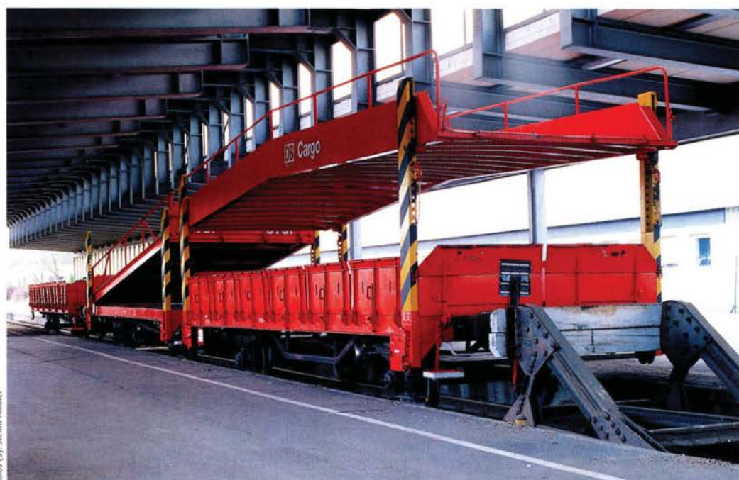
Auch die DB AG ist in der Lage zu improvisieren und schuf aus drei alten Wagen eine Verladeeinheit.
