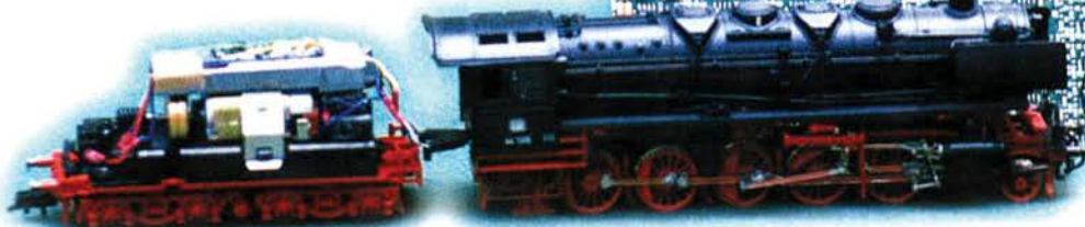
Der so genannte DC-Regler, der Glockenankermotoren mit Gleichstrom versorgt, verbessert das Fahrverhalten digitalisierter Lok-Modelle.
