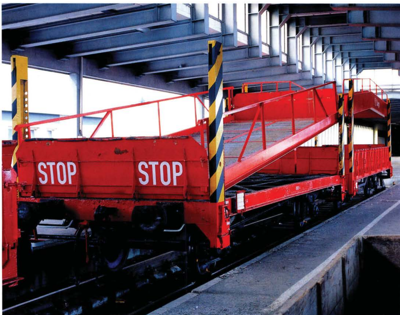
Der zweite Wagen des Kemptener Verbandes dient dem Erreichen der oberen Etage der doppelstöckigen Reisezug-Autotransportwagen.
