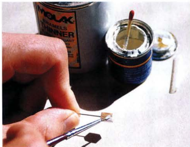
Auf einer Stecknadel aufgespießt, fällt das Bemalen und anschließende Trocknen der kleinen Holzquader erheblich leichter.
