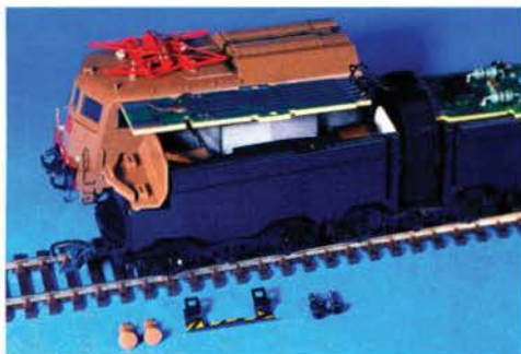
Unter der Platine sitzt der Motor, darauf befindet sich seit kurzem eine Digital-Schnittstelle.
