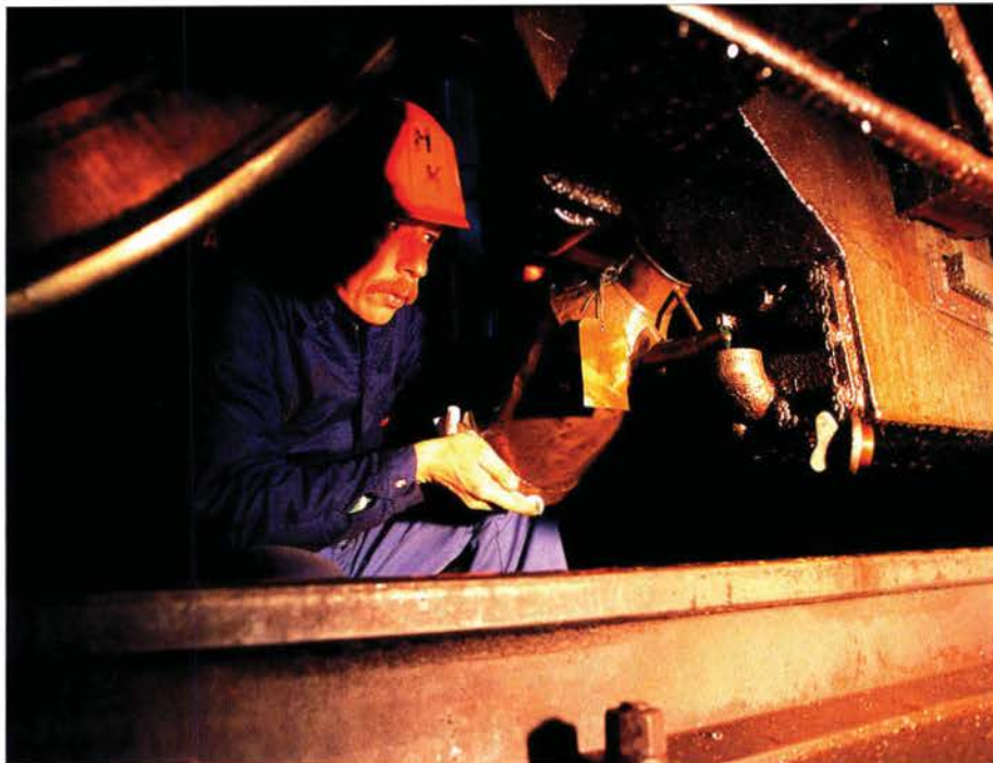
Die neun Winterthurer Lokführer erledigen anfallende Wartungsarbeiten an der ihnen anvertrauten Museumsmaschine selbst. Markus Künzler befüllt gerade ein Ölgefäß hinter dem Rad.
