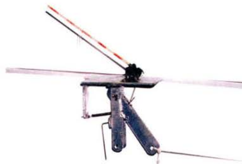
Der Schrankenmechanismus ist simpel, Anschläge und Zugfeder sind hier gut erkennbar.
