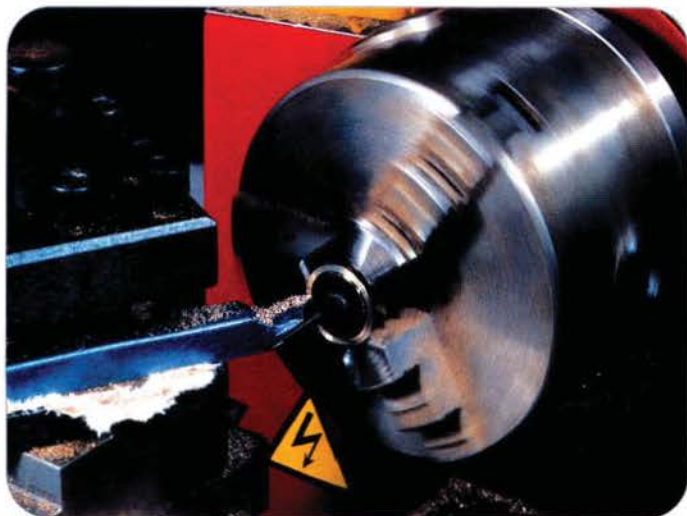
Hier wird die Spurkranzbreite des Treibrads einer Roco-110.1 bearbeitet. Die Verwendung eines Dreibacken-Futters ist zum Einspannen wichtig.
