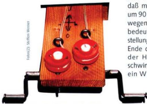
Durch das Brett sind die Stimmmechaniken im Bild verdeckt. Die Angabe der Drehrichtung ist für den späteren Betrieb hilfreich.
