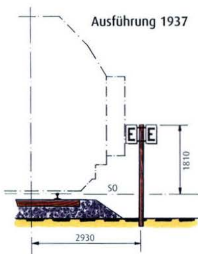
Das doppelte „E“ gab's bei der DB bis 1959, danach bis 1972 das durchgestrichene „L“ als Signal LP 5 (Zeichnung rechts). PI 4 galt bei der DR bis 1971.
