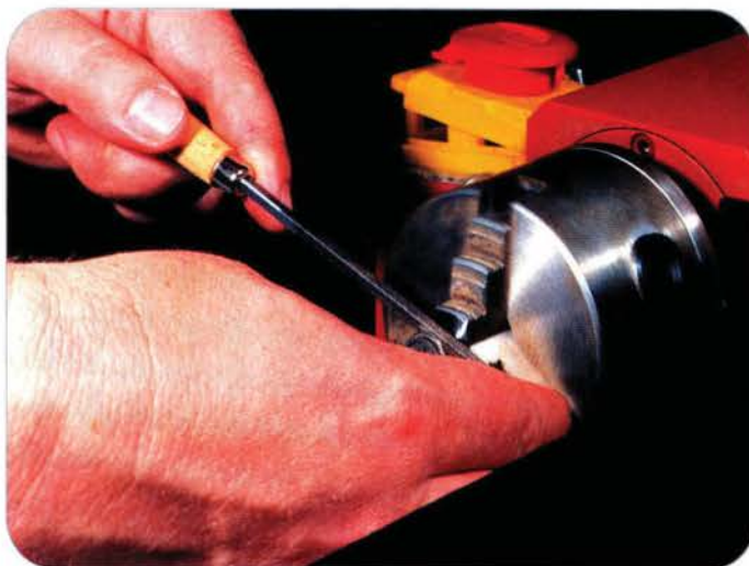
Mit der vorsichtig geführten Feile rundet Peter Thomin für einen guten Lauf des Radsatzes die zunächst scharfkantigen Spurkränze aus.
