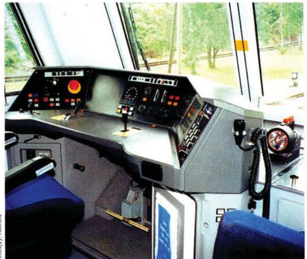
Beim Führerstand wird deutlich, dass die IORE mit der 101 der DB verwandt ist. Besonderheit ist allerdings der Sifa-Fernbedienungstaster, der mit dem Pult durch ein Spiralkabel verbunden ist.
