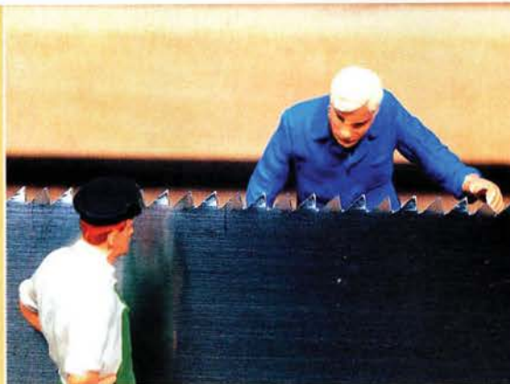
Das Schreinerteam prüft kritisch den Zustand der Absetz- oder Gestellsäge. Gut zu erkennen ist die so genannte Schränkung, die wechselnde Zahnstellung.
