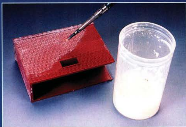
Mit dünner weißer Farbe, einer Mischung aus Acrylweiß, Wasser und einem Schuss Spülmittel, hebt man die Mauerfugen optisch deutlich hervor.
