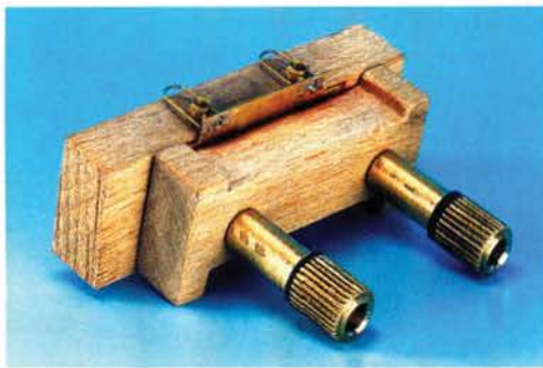
Die Lehre sorgt beim Löten für eine exakte Fixierung der Lampen und Bügel.
