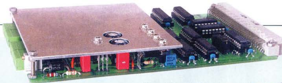
Rückansicht der Frontblende: Der Kunststoffbügel hält die Muttern, verbindet Platine und Frontblech.
