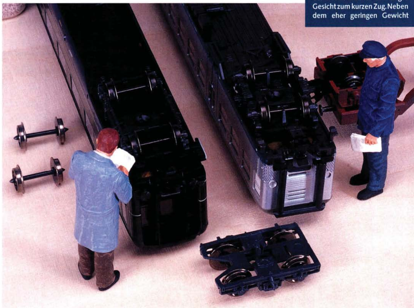
Die Drehgestelle der Märklin-Personenwagen sowie das Roco-Drehgestell werden in den Rahmen eingeklippt, das des Trix-Güterwagens ist angeschraubt.
