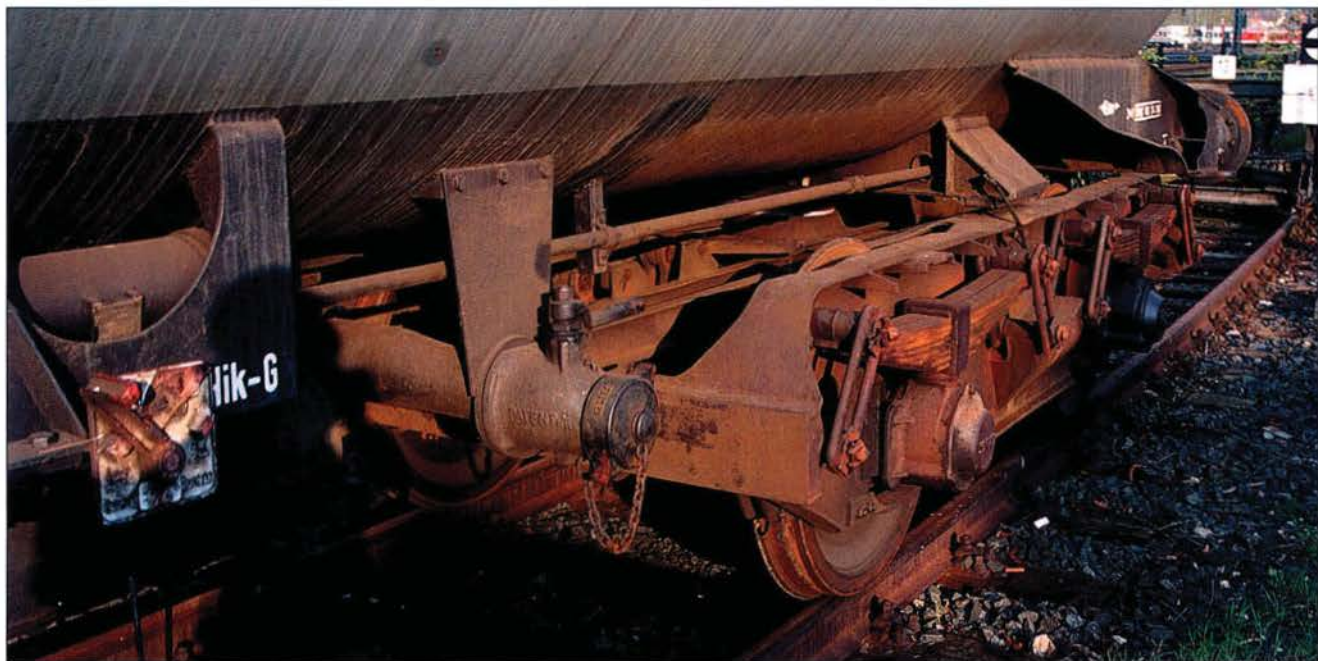
Der Leckagen-Kesselwagen in Fulda besitzt ein geschweißtes, einfach gefedertes Drehgestell mit Rollenlagern der UIC-Bauart. Der Waggon-Typ hat kein separates Untergestell.
