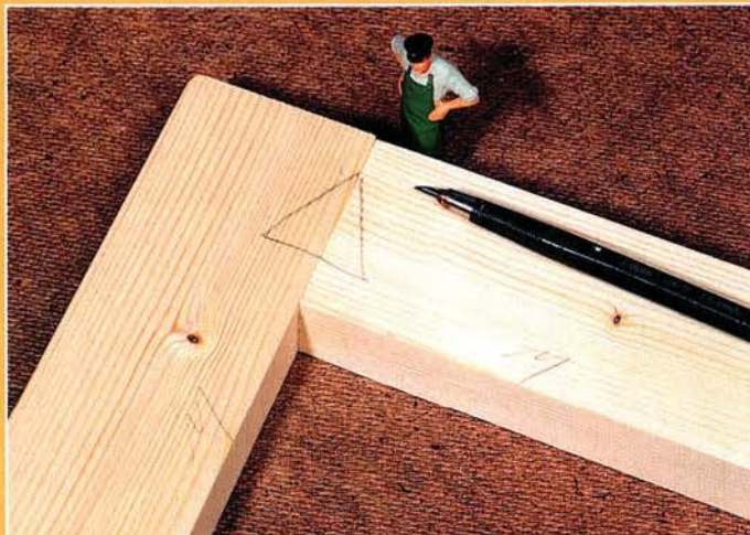
Das übergreifende Einzeichnen eines Dreiecks erleichtert die Montage, das Markieren der Winkelkante, von der aus man misst, sichert die Qualität.
