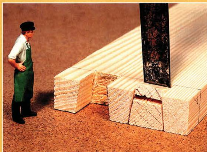
Beim Ausstemmen der eingesägten Zinken ist das Werkstück bei Halbzeit zu drehen, damit beiderseits bis zur Mitte des Holzes gearbeitet werden kann.
