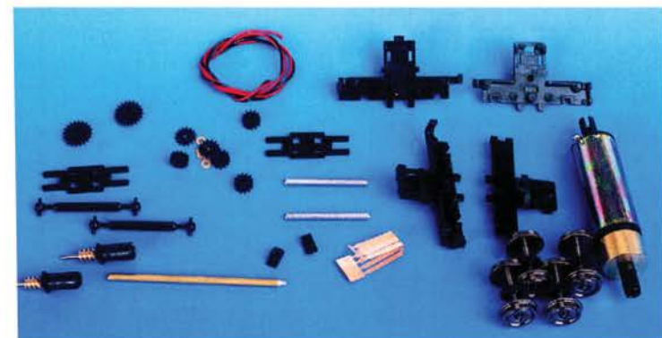
Die Anzahl der Antriebs-, Getriebe- und Fahrgestellteile ist durchaus zu überschauen. Ihre Montage stellt selbst Anfänger vor keine Probleme.
