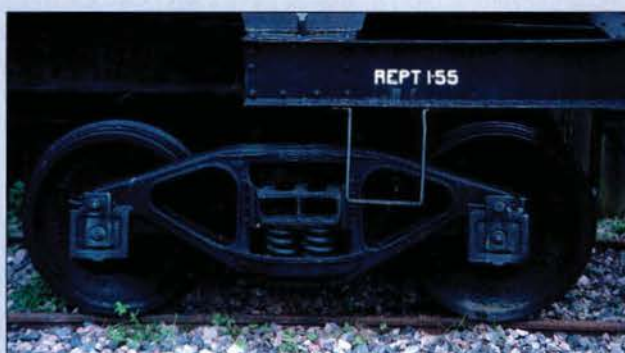
Diesem einfach gefederten amerikanischen Drehgestell fehlt eine Achsbuchsfederung.
