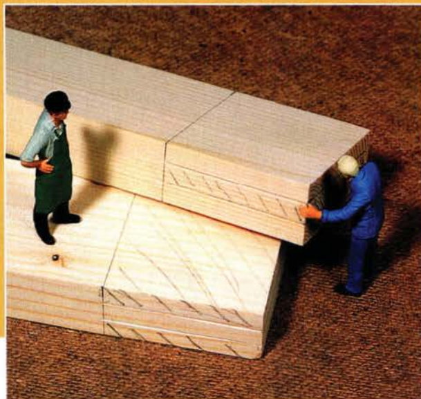
Die Werkstücke sind angerissen, die zu entfernenden Teile sind zur besseren Übersicht schraffiert: Nun kann die Arbeit beginnen.
