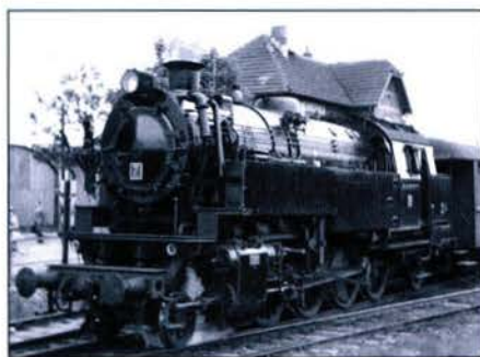
Markant an der 262 ist die große Stirnlampe über der Rauchkammertür.
