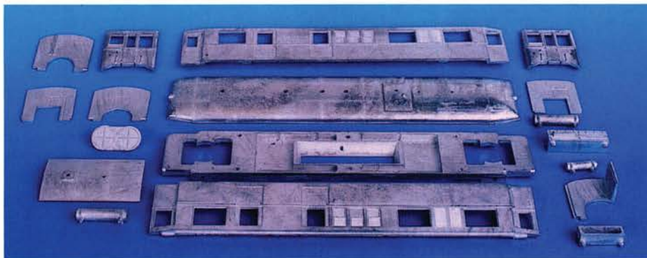
Die Gehäuseteile aus Weißmetall auf einen Blick: Beim Zusammenkleben der Triebwagenaußenwände sind zur Stabilisierung und gegen Verformungen die inneren Zwischenwände provisorisch einzusetzen.
