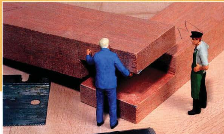
Die fertig verleimte und schon verputzte Eckverbindung (lks.) ist deutlich zu erkennen. Die Ecküberplattung (unten) gilt als einfache Variante einer Schlitz- und Zapfenverbindung mit durchaus ausreichender Stabilität bei sauberer Arbeit.
