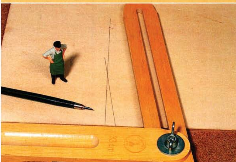
Alles im kritisch kontrollierenden Blick: Recht einfach ist das Erstellen einer so genannten 1:7-Zinkenschräge mit Hilfe eines Diagramms.
