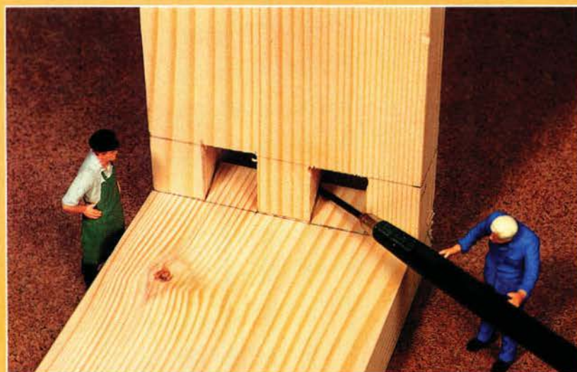
Das fertige Zinkenteil dient als Schablone zum Anreißen der Schwalbenschwänze. Dazu ist ein ordentlich angespitzter Bleistift für ein exaktes Anzeichnen dringend zu empfehlen.
