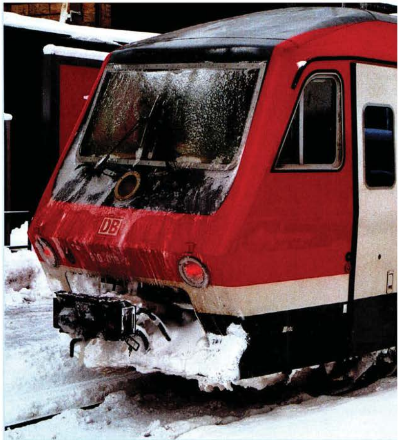
Vereisung und Verschneigung der Stirnfronten machen oft das Kuppeln unmöglich, so dass Flügelzüge getrennt gefahren werden müssen.
