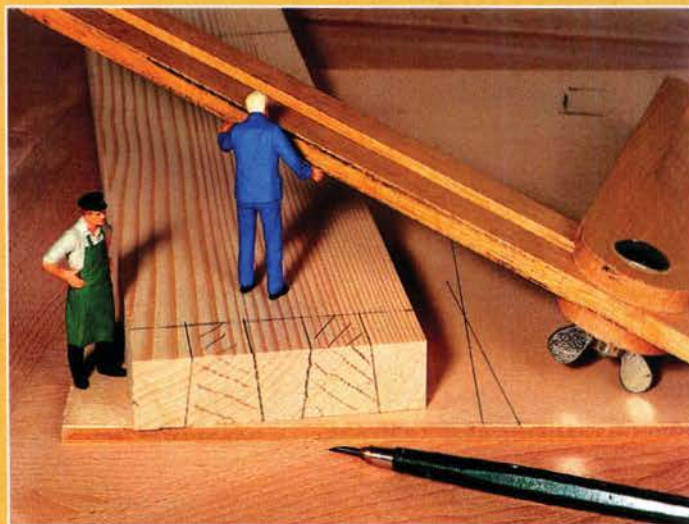
Die Zinken sind bereits angerissen, die Schwalbenschwänze markiert. Nach der aufgezeichneten Zinkenschräge wurde die Schmiege eingestellt.
